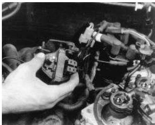
Fig. Fig. 14: Retire la bobina del soporte de retención
