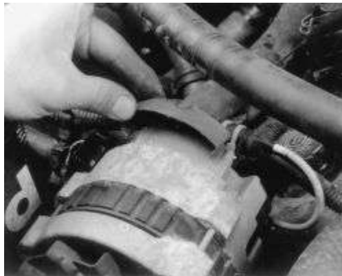
Fig. Fig. 12: Retire la placa protectora sobre la conexión de alimentación principal
