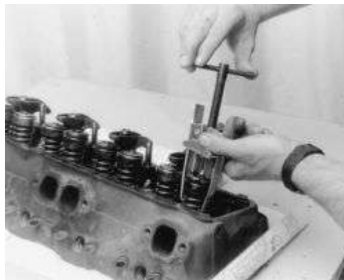
Higo. Higo. 3: Componentes de resorte de la válvula y la válvula
