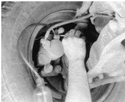
Higo. Higo. 1: Sangrado una pinza del freno delantero
