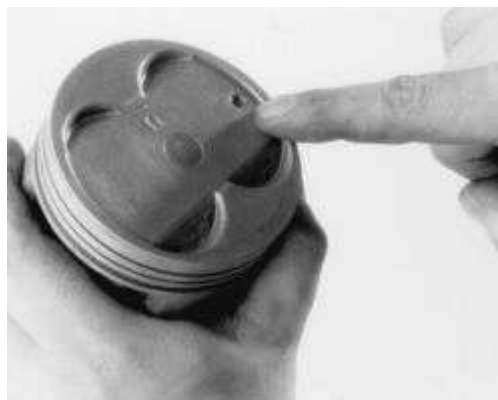
Higo. Higo. 39: La mayoría de los pistones están marcados para indicar posicionamiento en el motor (por lo general una marca significa la parte frontal frente a lado)
