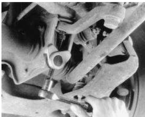
Higo. Higo. 4: Utilice un extractor de la barra de acoplamiento adecuado para aflojar la conexión vinculación Pitman brazo-dirección
