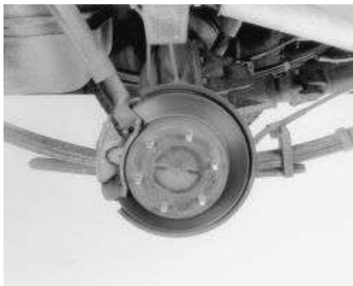
Higo. Higo. 1: freno de disco trasero de montaje Trooper
