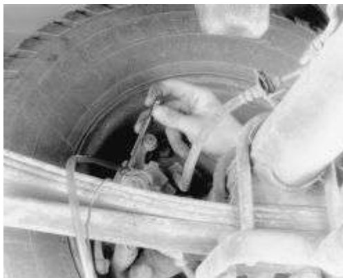
Higo. Higo. 1: Sangrado una pinza del freno delantero
