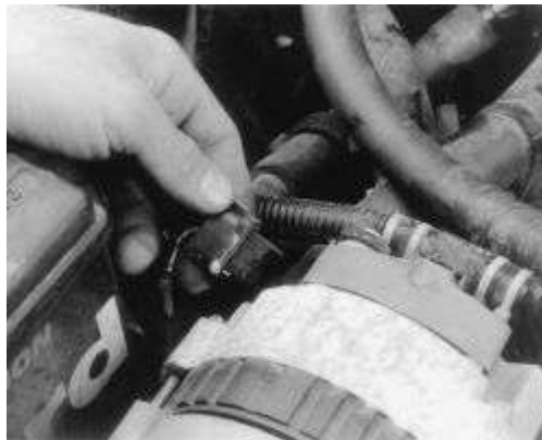
Fig. Fig. 11: Afloje el arnés de control de la parte trasera del alternador ensamble-1991 Trooper
