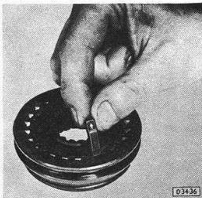
Fig. 21 — Posición de la flecha en las placas traba
