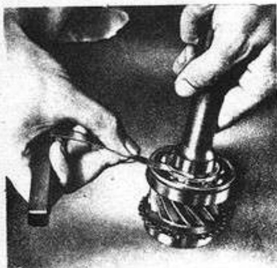
Fig. 23 - Control del juego entre el anillo de retención y el cojinete
