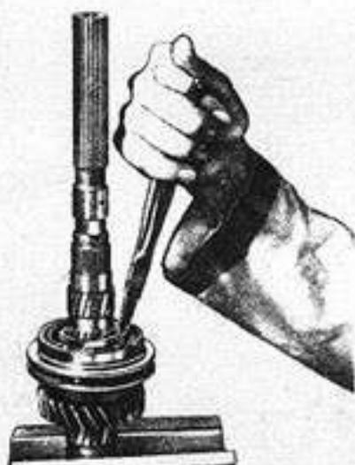
Fig. 20 - Extracción del anillo de retención del conjunto sincronizador de 1ra. y 2da. velocidad
