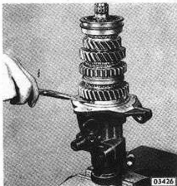
Fig. 11 - Extracción del conjunto del eje principal
