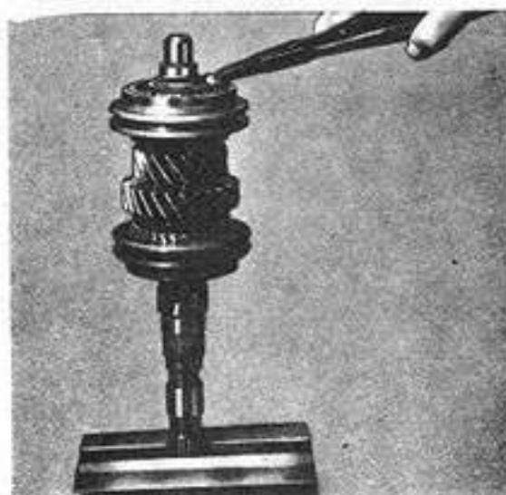
Fig. 19 - Extracción del anillo de retención del conjunto sincronizador de 3ra. y 4ta. velocidades
