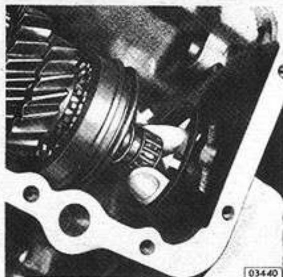
Fig. 26 — Instalación del cojinete de agujas
