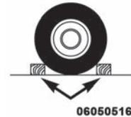
rueda diagonalmente opuesta a la posición del gato. Por ejemplo, si el neumático que va a cambiar es el delantero derecho, bloquee la rueda trasera izquierda.
