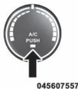
Presione este botón para acoplar el aire acondicionado. Una luz se iluminará cuando el sistema de aire acondicionado esté encendido. Girar el mando a la izquierda en el área azul de la escala indica temperaturas más frías, girarlo a la derecha en el área roja indica temperaturas más calientes.
