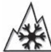
Si necesita neumáticos de nieve, seleccione neumáticos equivalentes en tamaño y tipo a los del equipamiento original. Utilice neumáticos de nieve únicamente en juegos de cuatro; si no lo hiciese, podría verse seriamente afectada la seguridad y maniobrabilidad de su vehículo.
