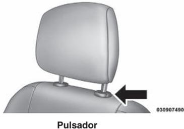
Los reposacabezas activos se pueden inclinar hacia adelante y hacia atrás para más comodidad. Para inclinar el reposacabezas y acercarlo a la parte trasera de la cabeza, tire hacia afuera de la parte inferior del reposacabezas. Empuje hacia atrás desde la parte inferior del reposacabezas para alejarlo de la cabeza.
