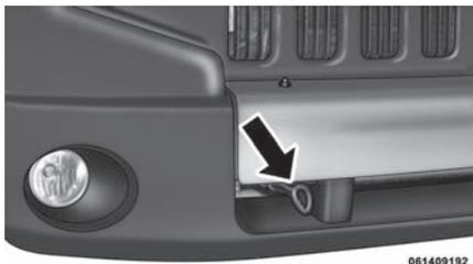
**Anilla para remolque delantera instalada**
