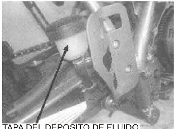
TAPA DEL DEPÓSITO DE FLUIDO DEL FRENO TRASERO
