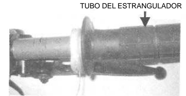
Aplicar aceite al extremo del cable del estrangulador y a la superficie deslizante del estrangulador.
