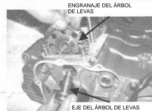
Desmontar el piñón impulsor y la placa de fijación removiendo los dos tornillos.
