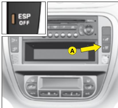
Este sistema está asociado al ABS y complementario del mismo (ABS). En caso de diferencia entre la trayectoria seguida por el vehículo y la deseada por el conductor, el sistema ESP actúa automáticamente sobre el freno de una o más ruedas y sobre el motor para llevar al vehículo a la trayectoria deseada.
