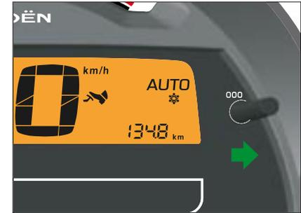
La caja de velocidades manual pilotada (SensoDrive) con cinco velocidades propone dos modos de conducción:
