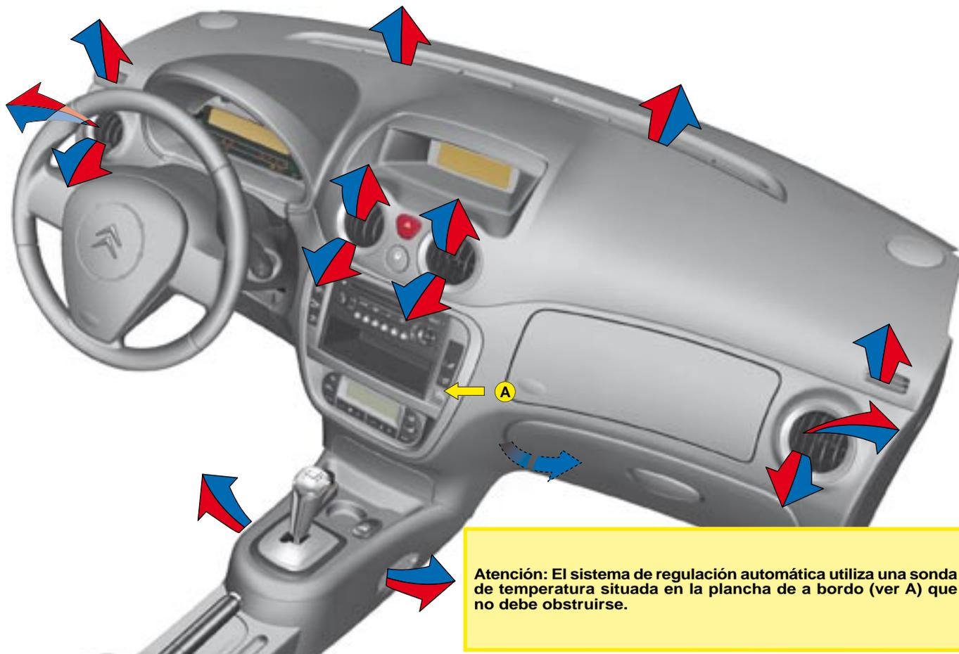
**Atención:** El sistema de regulación automática utiliza una sonda de temperatura situada en la plancha de a bordo (ver A) que no debe obstruirse.
