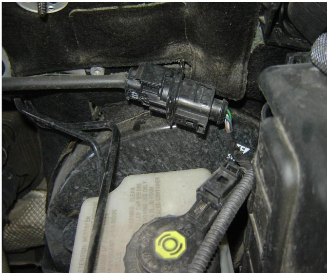
Fig.16 Conector de seis contactos para sonda lambda 1, banco 1
