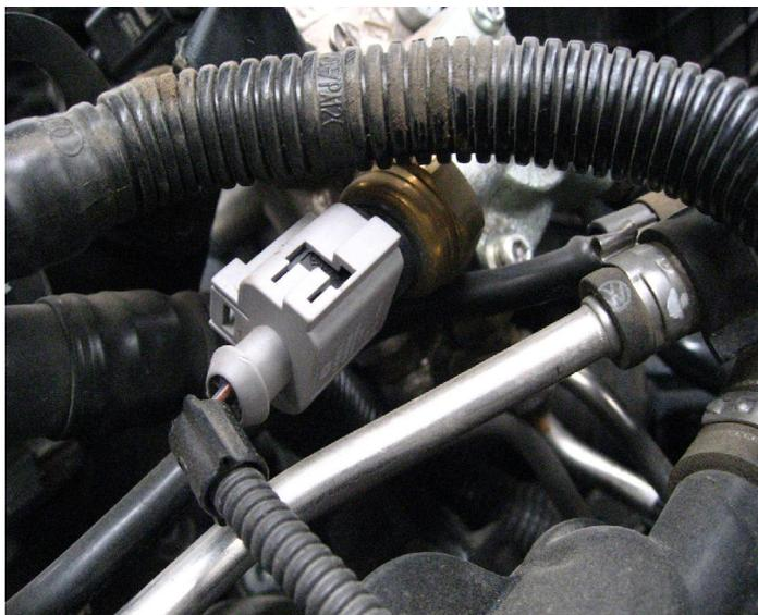
**Fig.19 Conector y sensor de baja presión de combustible**
