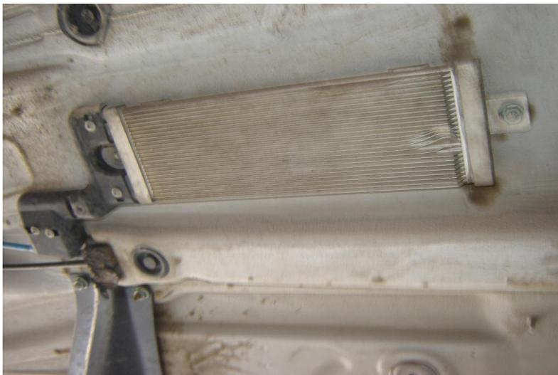
El radiador de combustible refrigera el combustible diesel de retorno, para proteger al tanque de combustible contra la llegada de un combustible demasiado caliente. Se ubica por debajo del vehículo al lado derecho. El combustible de retorno lo recibe desde el filtro de combustible.
