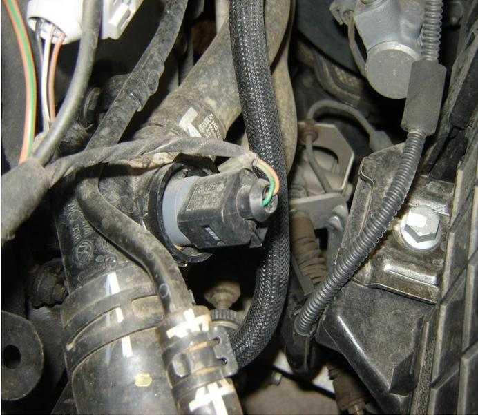
Fig.11 Sensor de temperatura del refrigerante G62 y conector doble.
