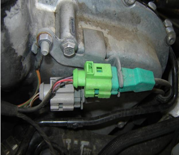
**Fig. 5 Ubicación de los conectores para sensores de detonación.** Conector verde de sensor de detonación 1 (G61) y conector gris para sensor 2 (G66).
