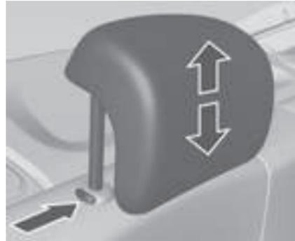
Tire del apoyacabezas hacia arriba. Para bajarlo, pulse el resorte y empuje el apoyacabezas hacia abajo.
