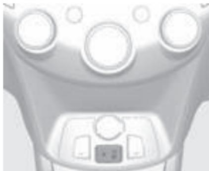
Si su vehículo tiene dispositivos auxiliares, puede usar el puerto AUX y el puerto USB para conectar dispositivos de audio.
