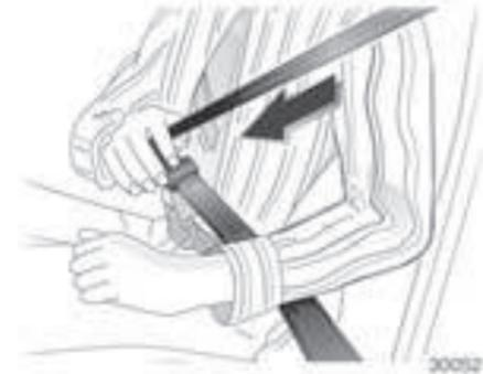
Extraiga el cinturón del retractor, guíelo por encima del cuerpo sin retorcerlo e inserte la lengüeta en el cierre. Durante el viaje, tense frecuentemente el cinturón abdominal tirando suavemente de la banda torácica. Recordatorio del cinturón de seguridad
