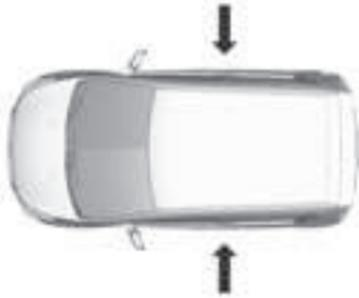
El sistema de airbags de cortina se activa en caso de choque de una determinada gravedad. El encendido debe estar conectado.
