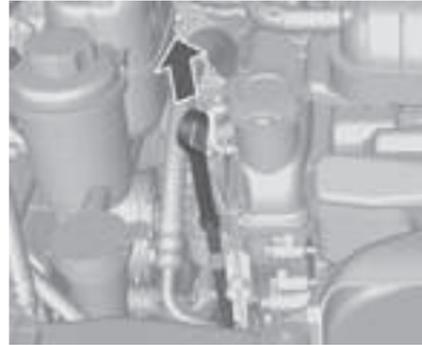
Si el nivel de aceite del motor está por debajo de la marca **MIN**, rellene el aceite del motor.
