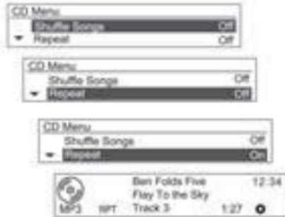
Gire el mando **MENU-TUNE** para seleccionar las funciones de reproducción aleatoria o repetición y pulse el botón **MENU-TUNE** para **activar** o **desactivar** las funciones relevantes.
