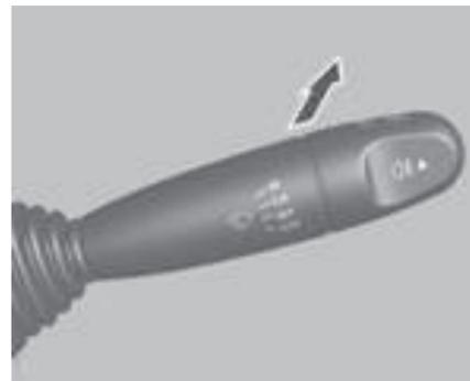
Para poner en marcha el limpiaventana y el lavaventana trasero, mueva la palanca hacia el panel de instrumentos. Si la mueve una vez, el limpiaventana se activará de forma continua a velocidad lenta. Para pulverizar líquido de lavado, mueva la palanca otra vez.
