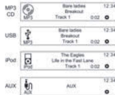
Pulse el botón **AUX** para seleccionar la entrada de sonido exterior (sólo para el tipo B) o pulse repetidamente el botón **CD/AUX** para desplazarse por las funciones del reproductor de audio, la función AUX para discos CD/MP3, o el reproductor de audio USB/iPod conectado (sólo para el tipo A). (**CD/MP3** → **AUX** → **USB/iPod** → **CD/MP3...**)
