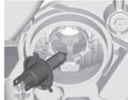
4. Extraiga la lámpara de la caja del reflector.
