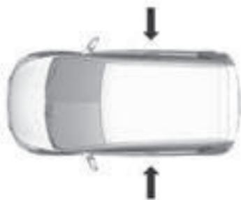
El sistema de airbags laterales se activa en caso de choque de una determinada gravedad. El encendido debe estar conectado.
