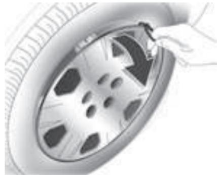
1. Desenclave los tapones de las tuercas de rueda con un destornillador y desmóntelos.
