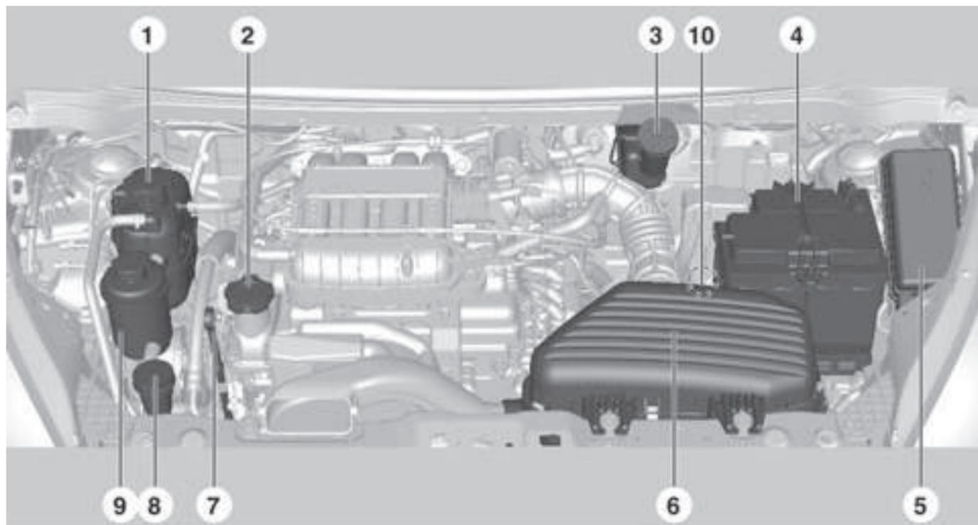
1. Depósito del refrigerante del motor
