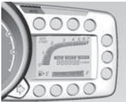
La computadora de a bordo suministra al conductor información útil como la distancia que se puede recorrer con el combustible que queda, la temperatura ambiente, la velocidad media y el tiempo de conducción.
