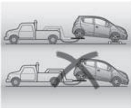
Si se remolca de 2 ruedas, deben elevarse las ruedas motrices delanteras y remolcarse con las ruedas delanteras bloqueadas.
