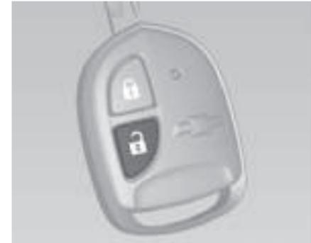
Si se desbloquea el vehículo con el botón
