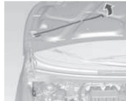
3. Levante la varilla de apoyo del soporte. Y luego asegúrela en el gancho izquierdo del compartimento del motor.
