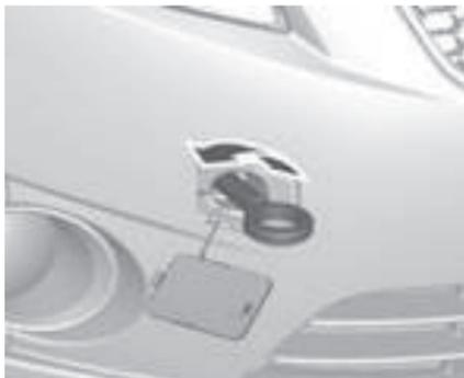
Enrosque la argolla de remolque todo lo posible hasta que quede en posición horizontal.
