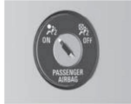
El sistema de airbag del acompañante se puede desactivar mediante una cerradura en el lado del tablero de instrumentos, visible con la puerta del acompañante abierta.
