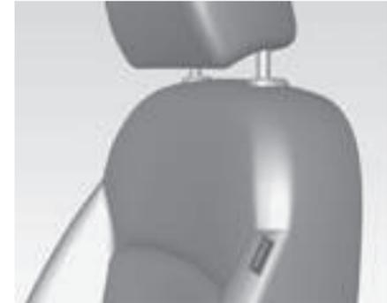
El sistema de airbags laterales se compone de un airbag en cada respaldo de los asientos delanteros.
