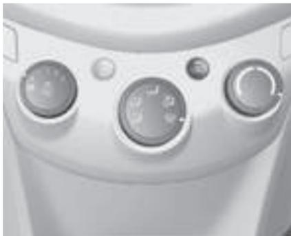
1. Gire el mando de distribución del aire a la posición DESEMPAÑAR
