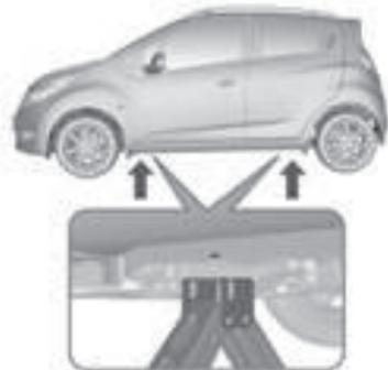
3. Gire la manivela del gato para subir ligeramente la cabeza de elevación y coloque el gato verticalmente en la posición marcada con el semicírculo.
