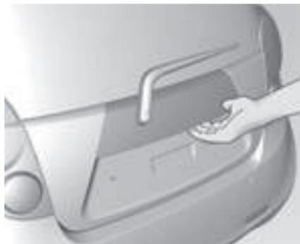
El portón trasero se bloquea o desbloquea, junto con todas las puertas, con la llave o el mando a distancia; una vez desbloqueado, tire de la palanca.
