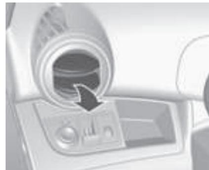
Presione sobre la tapa correspondiente para abrir las salidas laterales y gírela en la dirección deseada.
