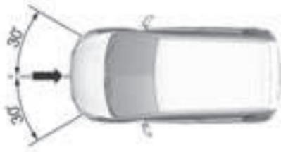
El sistema de airbags frontales se activa en caso de choque de una determinada gravedad en el sector indicado. Los airbags frontales no se activan en caso de choques frontales leves, choques laterales, traseros o en caso de vuelcos.
