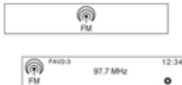
Pulse repetidamente el botón **RADIO BAND** para cambiar entre la frecuencia FM o AM.
