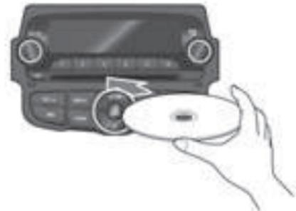
Inserte el disco que se va a reproducir con la superficie impresa hacia arriba en la ranura de inserción del disco.
