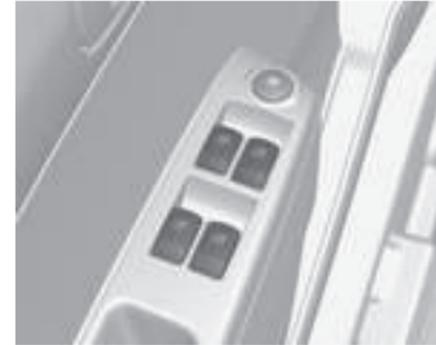
Los levantavidrios eléctricos se pueden accionar con el encendido conectado.
