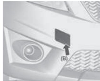
Desenclave la tapa pulsando en la posición de la flecha (A - modelo básico / B - modelo con paquete especial) y desmonte la tapa.
