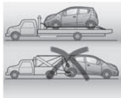
El mejor método es transportar el vehículo mediante un vehículo de rescate.
