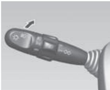
Para cambiar de luz baja a luz alta, pulse la palanca.
