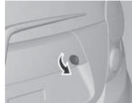
El portón trasero se bloquea o desbloquea con la llave. Inserte la llave en la ranura y gírela en sentido antihorario para desbloquearlo y tire de la palanca.
