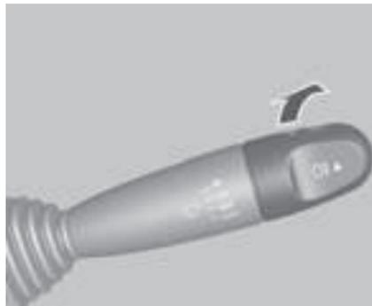
Para encender el piloto antiniebla, gire el extremo de la palanca del limpiaparabrisas con las luces bajas encendidas.
