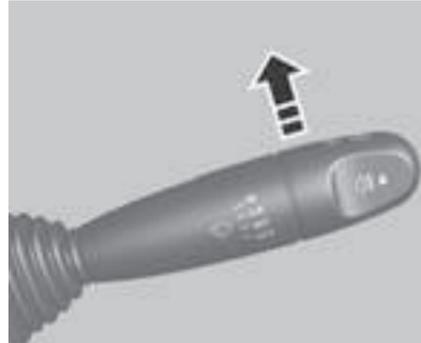
Para accionar los parabrisas, ponga el encendido en ON y mueva la palanca del limpia/lavaparabrisas hacia arriba.
