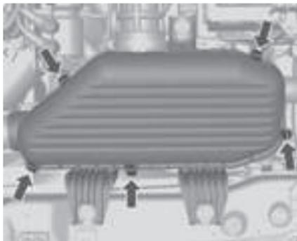
1. Suelte los clips de fijación de la tapa del filtro de aire y abra la tapa.
