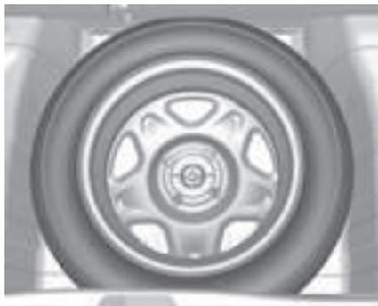
La rueda de repuesto está situada en el compartimento de carga, debajo de la cubierta del piso. Está fijada en el rebaje mediante una tuerca de mariposa.
