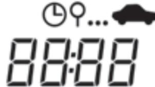
Este modo muestra el tiempo total de conducción. Para poner a cero el tiempo de conducción, pulse el botón **MODE** durante más de 1 segundo. El tiempo de conducción se acumula con el motor en marcha, aunque no se conduzca el vehículo. El tiempo de conducción se pondrá a 0:00 después de mostrar 99:59.
