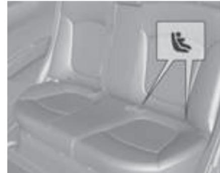
2. Busque las dos posiciones de anclaje inferiores. La ubicación de los anclajes inferiores está señalada con una marca circular en el borde inferior del respaldo del asiento trasero.
