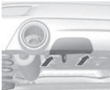
Si su vehículo tiene una tapa en el parachoques trasero, delante de la argolla de remolque trasera, quite los dos clips de la tapa. Desenclave la tapa tirando hacia atrás.
