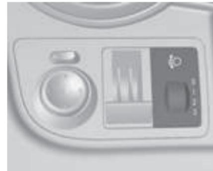
Para adaptar el alcance de los faros a la carga del vehículo y evitar el deslumbramiento: gire el mando
