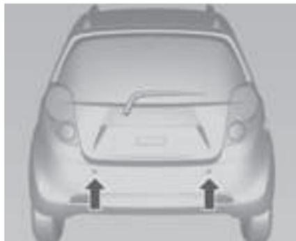
El asistente de estacionamiento ayuda al conductor durante las maniobras marcha atrás del vehículo mediante un aviso sonoro si detecta un objeto detrás del vehículo.
