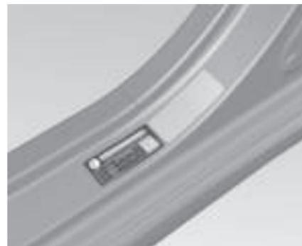
Presión de los neumáticos ⇨ 194 y en la etiqueta colocada en el marco de la puerta delantera izquierda.
