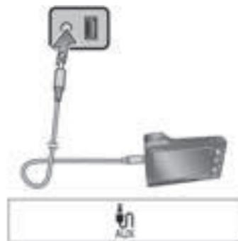
Conecte la salida de audio del equipo de sonido externo al terminal 1 ó 2 de entrada AUX.
