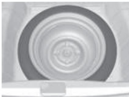
La rueda de repuesto está situada en el compartimento de carga, debajo de la cubierta del piso. Está fijada en el rebaje mediante una tuerca de mariposa.
