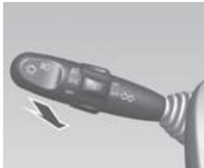
La palanca volverá a la posición normal cuando la suelte. Las luces altas estarán encendidas mientras sujete la palanca del conmutador combinado hacia usted.
