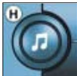
Efectúe impulsos sucesivos en la tecla **H** para acceder a los reglajes de los graves (**BASS**), de los agudos (**TREB**), del loudness (**LOUD**), del Fader (**FAD**), del balance (**BAL**) y de la corrección automática del volumen. La salida del modo audio se efectúa automáticamente después de unos segundos sin acción, o pulsando la tecla **H** después de la configuración de la corrección automática del volumen.
