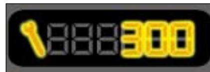
5 segundos después de poner el contacto, el totalizador kilométrico vuelve a su funcionamiento normal y la llave de mantenimiento se queda encendida. La pantalla indica el kilometraje total o parcial.
