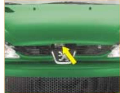
**Desde el exterior :** levante el mando y abra el capó. Fije el soporte para mantenerlo abierto.
