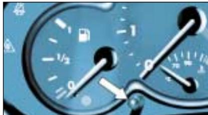
Luces encendidas, pulse el botón para variar la intensidad de iluminación del puesto de conducción. Cuando la iluminación alcanza el reglaje mínimo (o máximo), suelte el botón y vuelva nuevamente a pulsarlo para aumentar la intensidad (o disminuirla).
