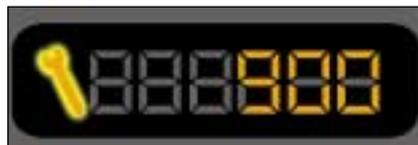
5 segundos después de poner el contacto, el totalizador kilométrico vuelve a su funcionamiento normal y la llave se queda encendida.
