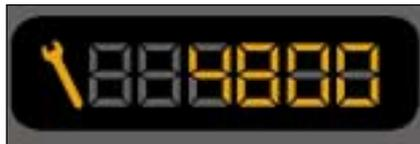
5 segundos después de poner el contacto, el totalizador kilométrico vuelve a su funcionamiento normal y la pantalla indica el kilometraje total o parcial.
