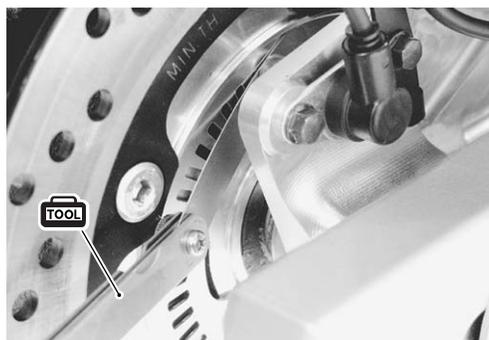
**DATA** Holgura entre sensor de velocidad de rueda – rotor de sensor: 0,3 – 1,5 mm
