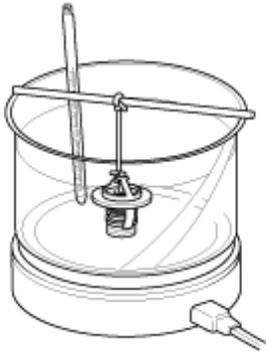
5. Compruebe la temperatura de la abertura de la válvula.
