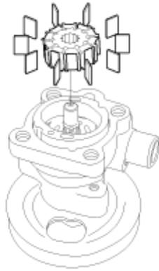
9. Instale la junta y la unidad de la cubierta de la bomba
