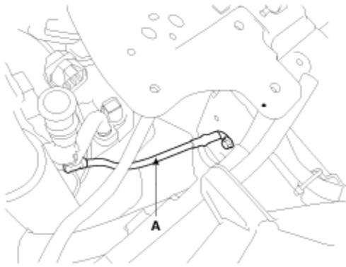
37. Extraiga los conectores del cable de la transmisión y el cable de control de la transmisión (A / T).
