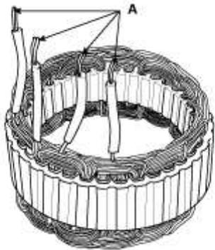
5. Comprobar que no hay continuidad entre cada conductor y el núcleo de la bobina.
