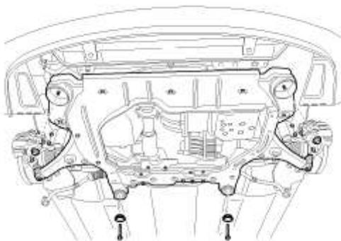
11. Extraiga los dos soportes (A) de la barra estabilizadora y los dos casquillos respectivamente.
