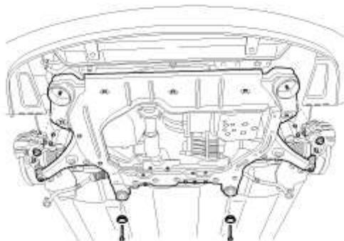
5. Instale el perno (A) que conecta la unidad de la junta universal de la dirección y la unidad del piñón.
