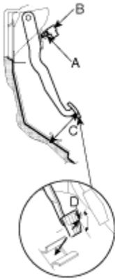
8. Afloje la contratuerca de la varilla de empuje (A) y gire dicha varilla hacia dentro de hacia fuera con los alicates hasta conseguir la altura estándar del pedal desde el piso. Después de efectuado el ajuste, apriete firmemente la contratuerca. No ajuste la altura del pedal con la varilla de empuje sometida a presión.
