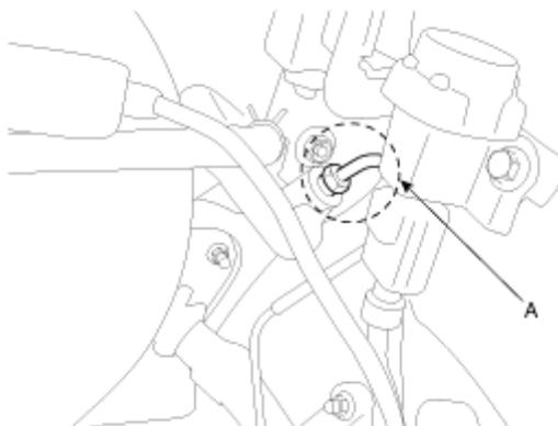
4. Desmonte la manguera flexible (A) conectó el depósito de reserva del freno.
