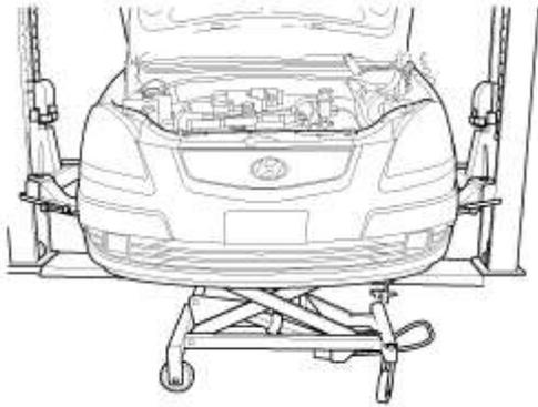
68. Desmonte los pernos y las tuercas del armazón auxiliar.
