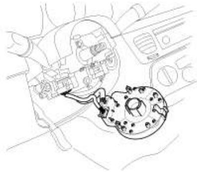
4. Desmontar el sensor del ángulo de la dirección del muelle de reloj.
