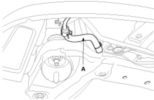
56. Recupere el refrigerante y desmonte el conducto de alta y baja presión. (Véase el grupo HA - Compresor del aire acondicionado).
