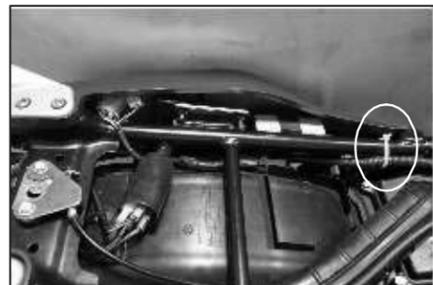
Sujete el cableado cerca al filtro aéreo utilizando abrazaderas PVC.
