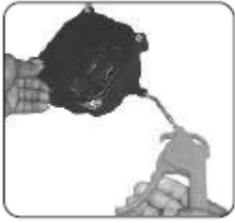
\* Asegúrese de que el pasaje de ventilación de la cubierta de la culata esté libre aplicando aire comprimido en dirección opuesta del flujo de los humos. El pasaje de ventilación obstruido daría lugar a exudación de aceite a través de retenes de aceite, anillos 'O', empaquetaduras y tubos de ventilación.
