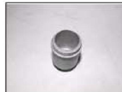
Limpie la cámara de sedimentación minuciosamente con aire comprimido de baja presión.
