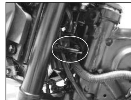
Guíe el cableado debajo de la luz de lámpara de unión de viga a través del lado IZQ.
