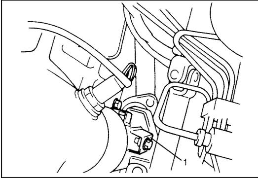
19) Remove exhaust manifold stiffener (1).
