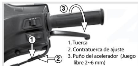
Imagen 16. Ajuste del puño del acelerador.
