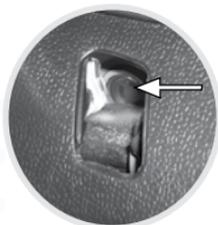
Imagen 20. Nivel del líquido de freno delantero.
