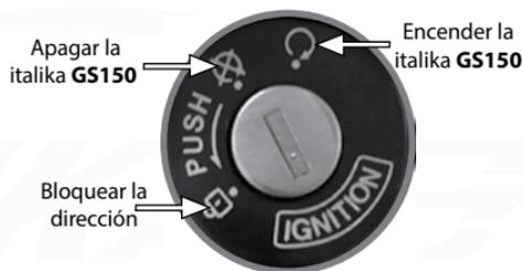
Imagen 6. Interruptor de encendido y bloqueo.
