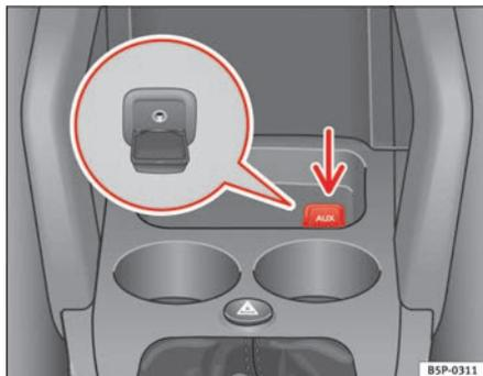
**Fig. 118** Conector para la entrada auxiliar de audio
