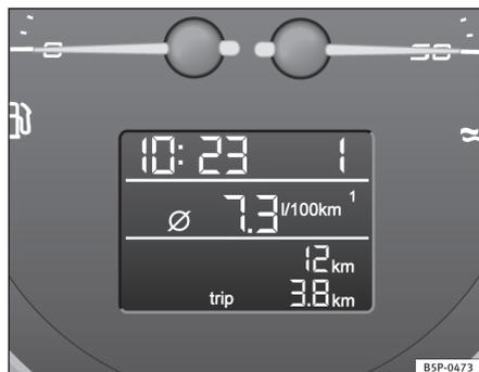
Fig. 40 Pantalla digital del cuadro de instrumentos
