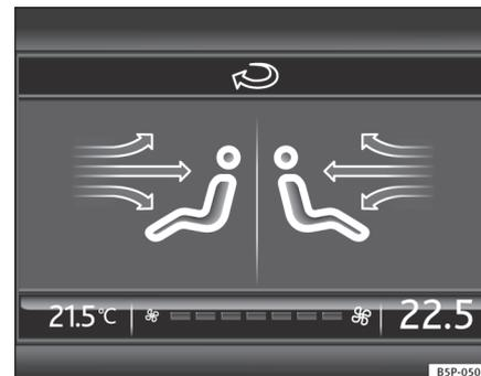
Fig. 130 Pantalla del navegador con información del Climatronic
