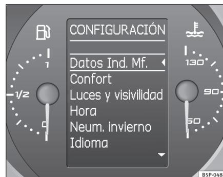
Fig. 47 Pantalla del cuadro de instrumentos indicador multifunción (MFA).
