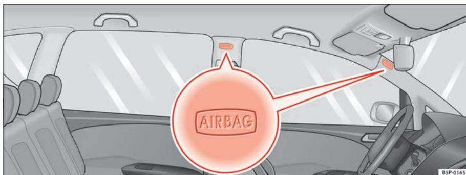
**Fig. 24** Ubicación de los airbags para la cabeza en el lado izquierdo del vehículo
