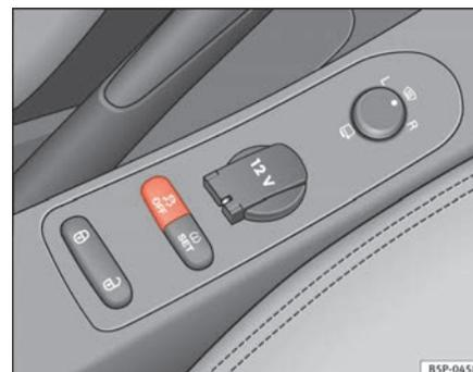
**Fig. 135** Detalle de la consola central: tecla ESP
