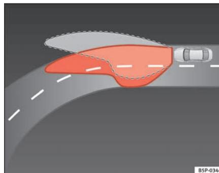
Fig. 75 Iluminación de la curva con faros autodireccionables
