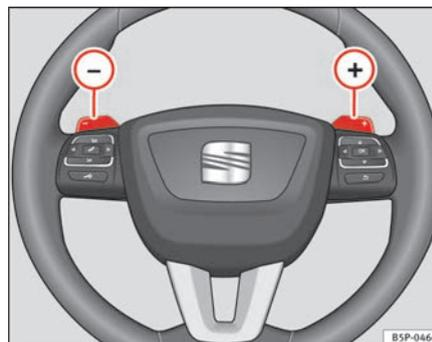
Fig. 144 Volante con palancas para cambio automático
