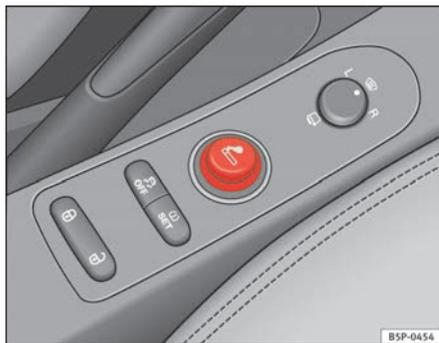
Fig. 116 Encendedor alojado en la toma de corriente de la consola central anterior
