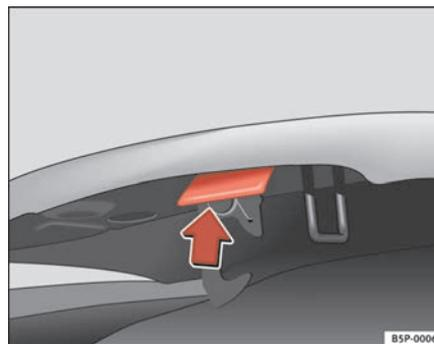
**Fig. 155** Gancho apertura capó motor. ▶
