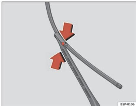
**Fig. 162** Cambio de las escobillas del limpiaparabrisas
