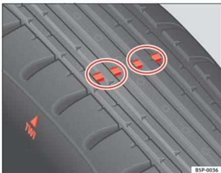
**Fig. 166** Indicadores de desgaste del perfil del neumático
