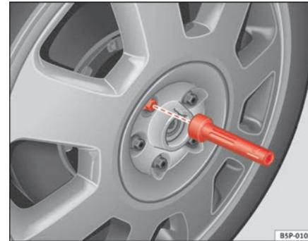
**Fig. 173** Cambio de rueda: Útil de hexágono interior para girar los tornillos
