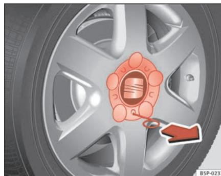
**Fig. 169** Cambio de rueda: Retirar el embellecedor de la rueda
