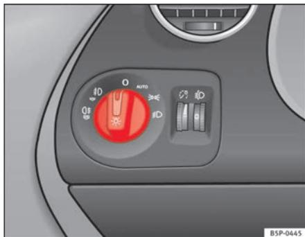
Fig. 73 Encendido automático de luces
