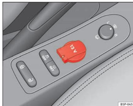
Fig. 117 Toma de corriente en la consola delantera
