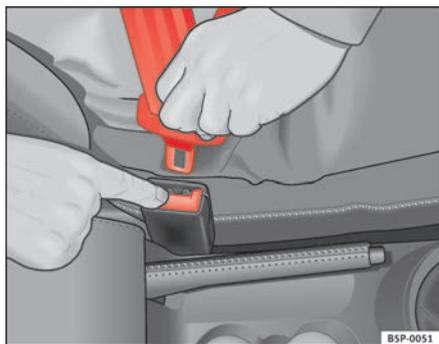
Fig. 16 Retirar la lengüeta del cierre del cinturón
