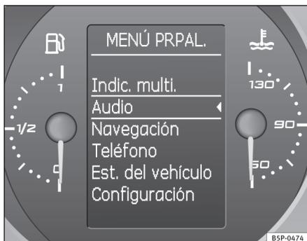
Fig. 46 Pantalla digital del cuadro de instrumentos: Menú principal
