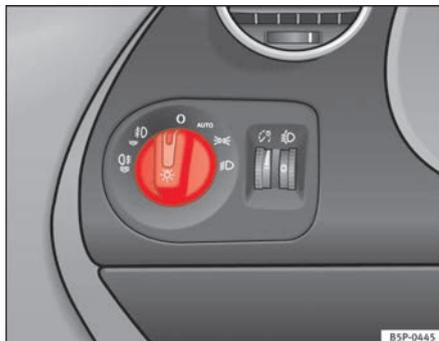
Fig. 72 Detalle del tablero de instrumentos: mando de las luces, faros antiniebla y luz trasera antiniebla
