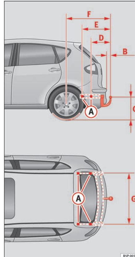
Fig. 152 Puntos de fijación del dispositivo de remolque
