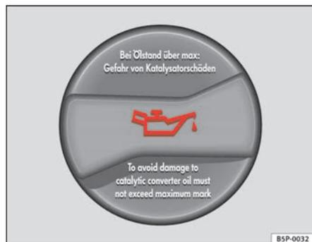
Fig. 158 Tapón de la boca de llenado de aceite del motor en el vano motor
