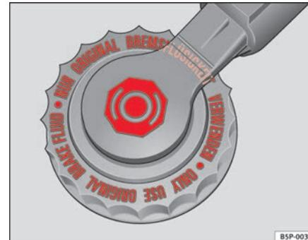
**Fig. 165** Tapón del depósito del líquido de frenos en el vano motor
