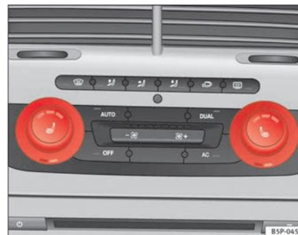
**Fig. 95** Calefacción asientos delanteros con Climatronic
