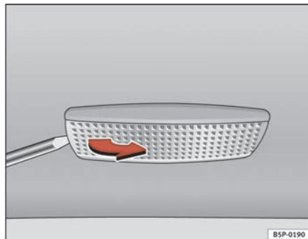
Fig. 195 Desmontaje luz del parasol
