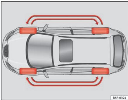
**Fig. 167** Esquema para el cambio de ruedas
