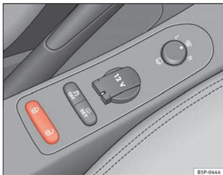
Fig. 58 Detalle de la consola central: pulsador del cierre centralizado
