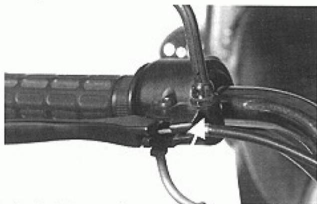
Eje del nivelador del freno
