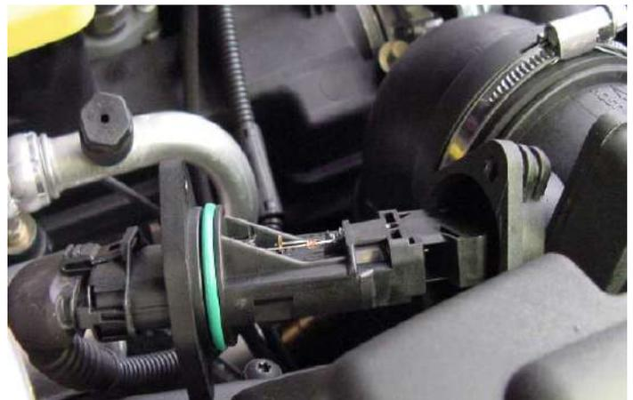
MEDIDOR MASA AIRE motor M57 BMW 3.1L.
