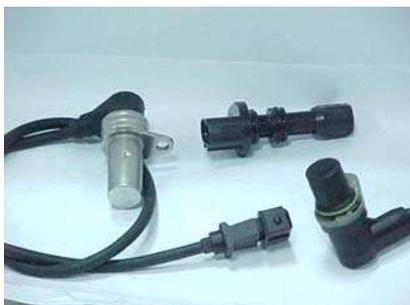
La señal que se genera es del tipo alterna senoidal, hay que medirla con OSCILOSCOPIO, o utilizando el polímetro en AC.
