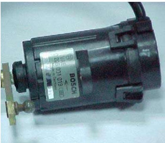
El sistema utiliza un sensor doble por seguridad, es decir doble potenciometro. Trabajan a mitad de voltaje.
