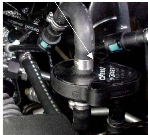
Esta válvula bimetalica desvia el combustible para que se enfríe en el radiador de combustible , situado en los bajos del vehículo (tambié lo montan PSA), similar al termostato de agua, el combustible del retorno se
