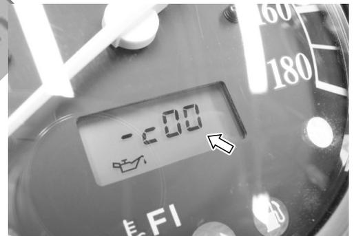
**No desconecte los conectores del cable de la centralita antes de comprobar el código de mal funcionamiento.**
