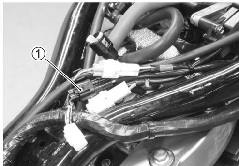
**El acoplador del cable del sensor TP y el acoplador del cable del sensor STP tienen una apariencia externa similar.**
