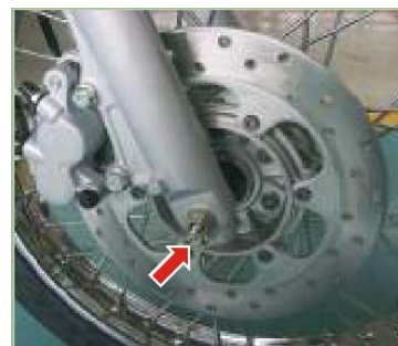
Tuerca eje delantero 4-5 Kg.-m
