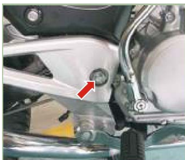
Tuerca eje basculante 8.0-10.0 Kg.-m
