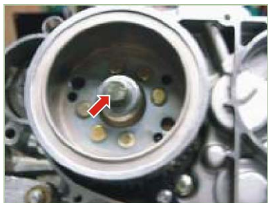
Tornillo rotor 4.5 Kg.-m
