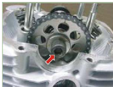
Tornillo arbol de levas 1.5 Kg.-m
