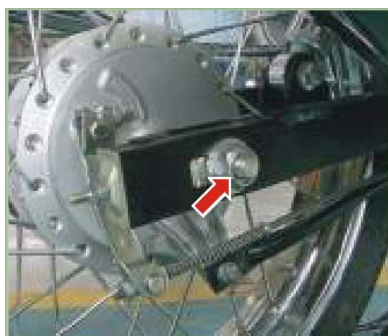
Tuerca eje trasero 8-10 Kg.-m
