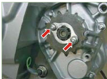
Tornillos seguro sprocket salida 1.1 Kg.-m
