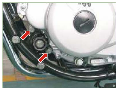
Soportes de motor M8 2.2 Kg.-m M10 2.4 kg.-m
