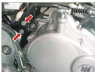
Soportes de motor M8 2.2 Kg.-m M10 2.4 kg.-m
