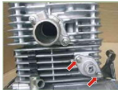
Tornillo tensor cadena 1.1 Kg.-m
