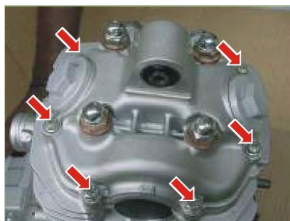
Tornillo tapa cabeza 1.1 Kg.-m
