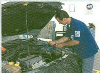
Preparando para o teste do sensor MAF
