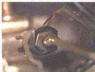
Sensor de velocidade instalado
