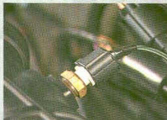
Detalhe do sensor de temperatura do ar
