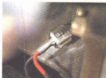
Conectando nos terminais do sensor para teste
