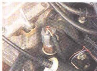
Detalhe do sensor de temperatura do motor
