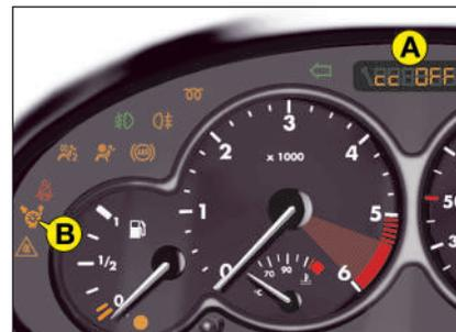
El modo regulador o limitador de velocidad aparece en la pantalla **A** del combinado cuando está seleccionado; un testigo **B** se enciende en el combinado cuando está activado.
