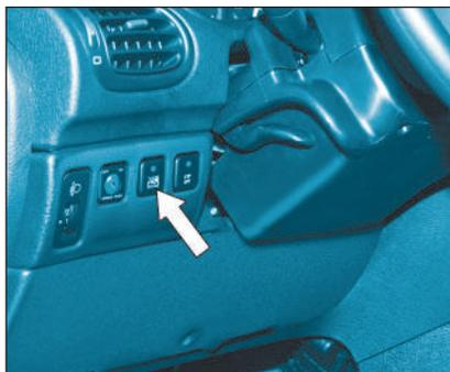
Este mando permite neutralizar el funcionamiento de las lunas traseras sea cual fuere su posición.
