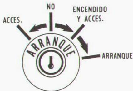
**Llave en posición vertical:** sistema eléctrico desconectado.
