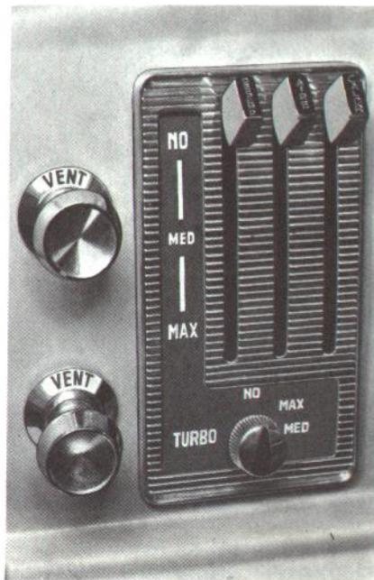
Llevando la palanca (Desempeñador) hacia abajo, una corriente de aire caliente sale por las rejillas en la parte superior del panel de instrumentos, para desempañar el cristal del parabrisas. La corriente de aire en ciertas ocasiones, incluso fría es eficaz para el desempañado.
