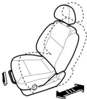
Para mover el asiento hacia adelante o atrás, jale la palanca y deslice el asiento a la posición deseada.
