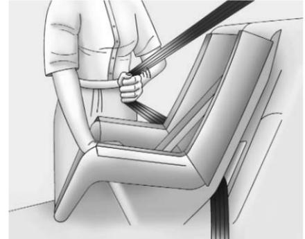
5. Jale el cinturón de hombro completamente fuera del retractor para ajustar el seguro. Cuando el seguro del retractor esté ajustado, el cinturón se puede apretar pero no se puede jalar fuera del retractor.
