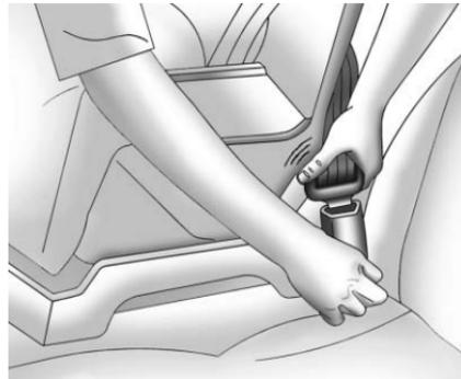
4. Empuje la placa de cerrojo dentro del broche hasta que escuche un sonido de clic. Coloque el botón de liberación sobre el broche de tal forma que el cinturón de seguridad se desabroche rápidamente si es necesario.
