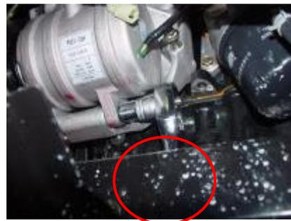
3. Baje el vehículo y luego use una manga de 13 # para aflojar el perno de fijación del compresor desde arriba. Use una manga 13 # para aflojar el perno de fijación en el medio del compresor y luego desmonte el conjunto del compresor. Esfuerzo de torsión: 20 + 5Nm.
