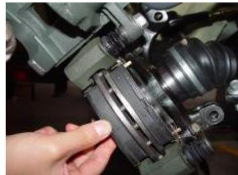
4.6 Mida el grosor del revestimiento de fricción. Si el grosor es inferior a 3 mm, reemplácelo a tiempo y el revestimiento se reemplazará en pares.
