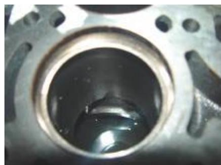
2.3.2 empujar la cabeza del pistón verticalmente contra el anillo del pistón en el cilindro y deje que el anillo del pistón esté en un avión.
