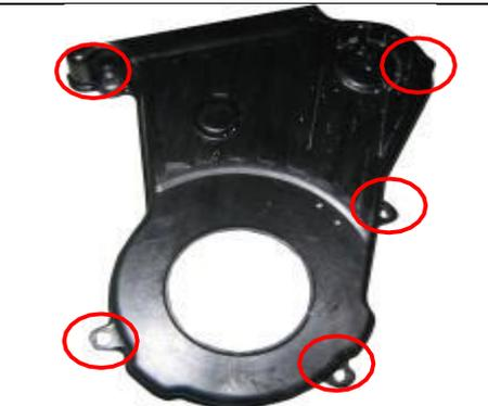
1.9 Debe explicarse especialmente que, la posición del perno de fijación al revés izquierdo en la cubierta inferior es muy oculta, para lo cual se requiere el uso de una biela de unión universal. Alternativamente, use una manga de 13 mm para quitar los tres pernos del soporte de suspensión para quitar el soporte de suspensión.
