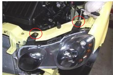
4.3. Retire los pernos de fijación debajo del faro con un destornillador cruzado.
