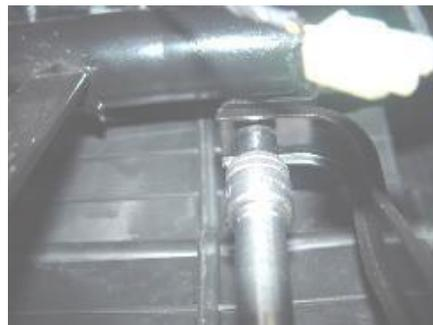
1.1.13. Coloque oblicuamente el panel de instrumentos y la viga transversal del panel de instrumentos, retire los pernos de fijación de los lados izquierdo, medio y derecho del panel de instrumentos con una manga de 10 #, y retire la correa de unión.
