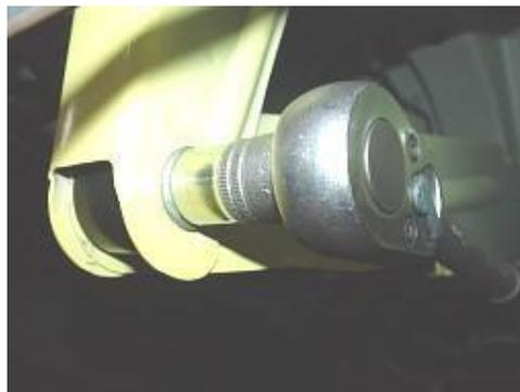
4.2.2 Retire los pernos de conexión del lado derecho del cuerpo y la barra de soporte lateral con una manga de 15 #, y luego retire el conjunto de la barra de soporte lateral. Par:  $100 \pm 10\text{N.m}$
