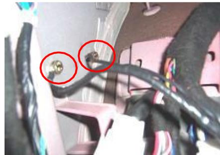
1.1.5. Halar fuera del conector al arnés del instrumento conector A.
