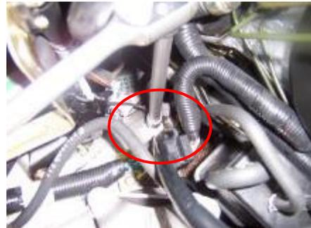
10.5 Use una llave de 17 # para aflojar el perno sangrante de la caja de la transmisión para descargar el aceite del engranaje.
