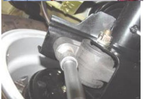
4.4.3 Retire el cable de control del freno de mano con un alicate.
