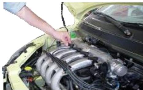
1.2 Use una funda de bujía para aflojar la bujía cuyo cilindro se medirá. Explicación: no retire la bujía cuyo cilindro no se medirá.
