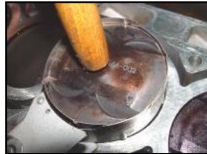
12. Apretar El perno de fijación de la tapa del cojinete de la biela.
