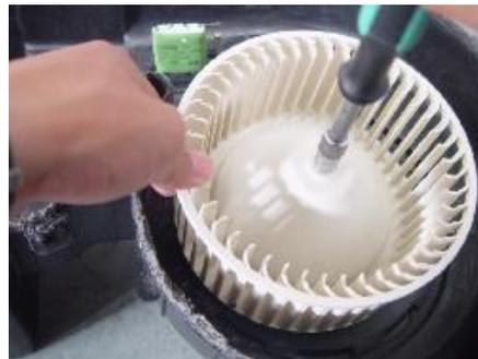
4.1.15. Retire los tornillos de fijación de dos motores de ventilador con un destornillador cruzado.
