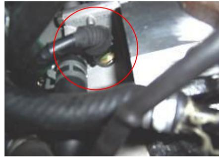
2.1.19. Retire el conector del sensor de velocidad del motor.
