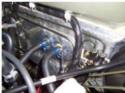
2.7. Afloje seis pernos de fijación del conjunto del evaporador fijados en la pintura desde el compartimiento del motor, y la posición fija es como se muestra en la figura correcta.
