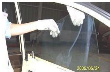
3.15. Retire los seis pernos de fijación del regulador de vidrio de la ventana con una manga de 10 #.
