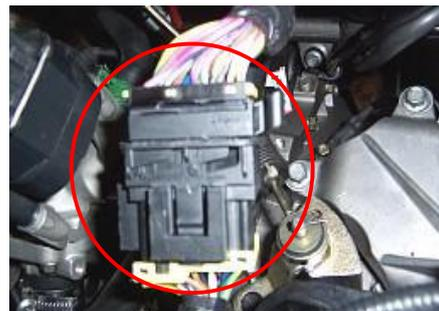
1.1.34. Retire los pernos utilizados para asegurar el lado izquierdo de la caja de fusibles con una llave de tubo.
