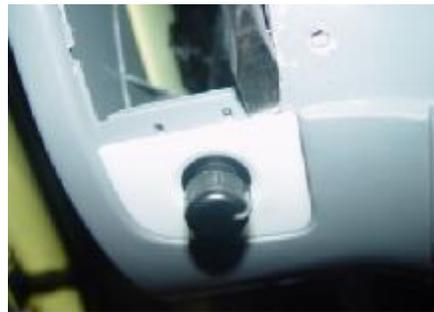
1.1.10. Quitarse la cubierta de adorno, y retire dos tornillos de fijación de las partes frontales derecha e izquierda del cuerpo superior del panel de instrumentos y siete tornillos de fijación del cuerpo inferior del panel de instrumentos con un destornillador cruzado, y luego retire el conjunto del panel de instrumentos superior junto con la derecha y salidas de aire a la izquierda. Par:  $3 \pm 0.5$  Nm
