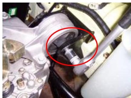
11.5 Use una manga de 13 # para aflojar los tres pernos de conexión para el soporte de montaje del motor derecho.
