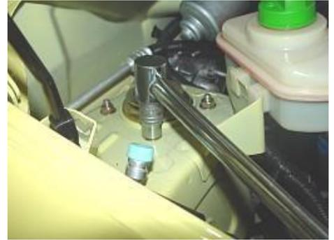
4.1.5 Retire el conjunto del amortiguador.
