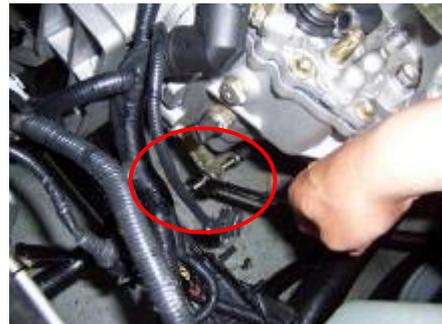
10.4 Use una manga de 13 # para aflojar el perno de fijación del cable de control del embrague en la caja de la transmisión.
