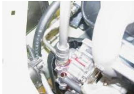
3. Use una manga 10 # para aflojar el perno de fijación (superior) del soporte de ajuste de la bomba de dirección.
