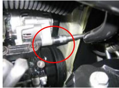
4. Use una manga 10 # para quitar el perno de fijación del arnés de ánodo del generador, extraiga el conector del arnés, retire la correa y luego saque el generador.
