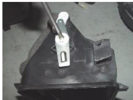
4.1.9. Retire los nueve tornillos de conexión de la carcasa del otro lado del evaporador con un destornillador cruzado (como se muestra en la figura). Par:  $1.5 \pm 0.5$  Nm
