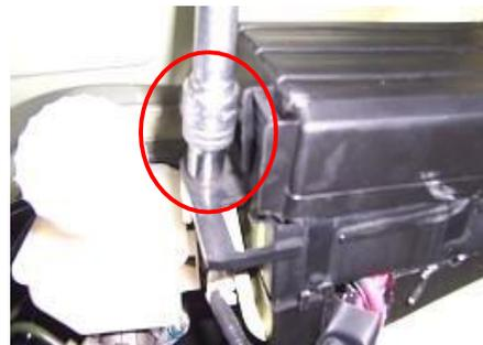
1.1.35. Retire los pernos utilizados para asegurar el lado derecho de la caja de fusibles con una llave de tubo.
