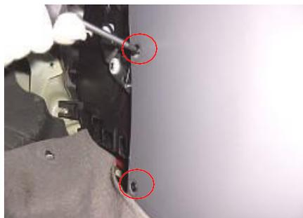
1.2. Retire los pernos utilizados para unir la consola y la placa de protección inferior del cuerpo con un destornillador cruzado.
