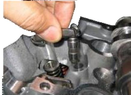
7. Instale el conjunto de la cubierta de la carcasa del árbol de levas y el cojinete del árbol de levas.
