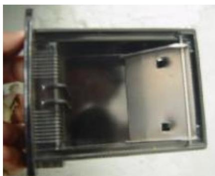
3.1.2. Retire un tornillo de fijación de la parte inferior de la guía delantera del cenicero con un destornillador cruzado.
