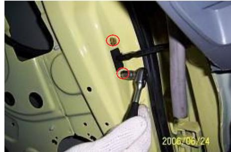
4.32 Retire los pernos de fijación del limitador de la puerta del cuerpo con una funda de 10 # y luego retire el limitador de la puerta. Par:  $10 \pm 1\text{ Nm}$
