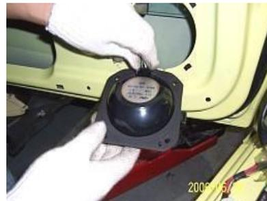
1.7. Halar fuera de la puerta arnés interior y interior piso arnés conector. (Ver *Desmontaje / Montaje del arnés interior*)
