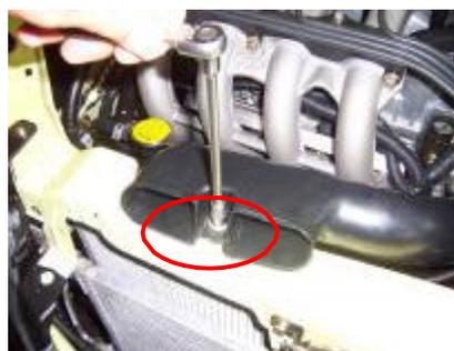
9.2 Use un destornillador de estrella para aflojar la abrazadera que conecta la manguera de admisión y el cuerpo del acelerador electrónico.
