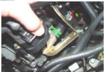
10. Halar saque el conector del tacogenerador del motor a mano.
