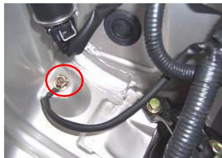
1.1.15. Retire los pernos de fijación superiores del guardabarros izquierdo con una llave de tubo de 10 #.
