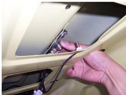
3.1.4. Retire los dos pernos de fijación del cuerpo del seguro del maletero (es decir, el maletero) con una llave de tubo.
