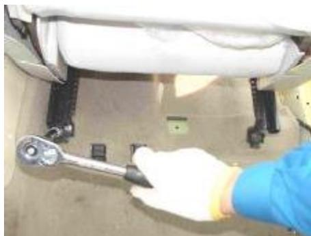
1.4 Desmontar dos pernos de fijación en la parte posterior del asiento con manguito.
