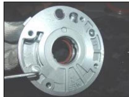
8. Use un destornillador para hacer palanca en el sello de aceite delantero del cigüeñal y luego retire el sello de aceite.
