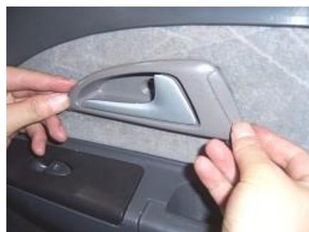
4.5. Separe la barra interna del mango interno con un destornillador en ángulo recto.
