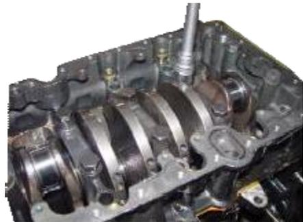
6. Quitarse conjunto del sello de aceite trasero del cigüeñal, retire la cubierta de la carcasa del cojinete y luego retire el conjunto del cigüeñal.
