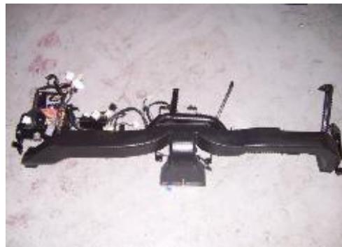
1.8. Retire el arnés con una llave de tubo de 10 and y un destornillador de cabeza plana.
