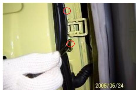
4.30 Afloje dos pernos de fijación inferiores de la bisagra de la puerta delantera de la puerta con una llave de 13 #. Par:  $36 \pm 4\text{N.m}$ .
