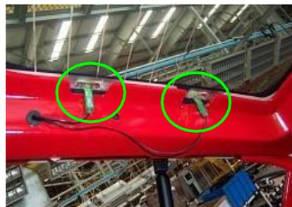
1.1.7. Halar retire el conector de la lámpara de parada de montaje alto y luego retire el arnés de la lámpara de parada de montaje alto.
