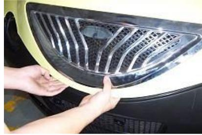
4.2 Afloje los pernos de fijación del parachoques delantero de los lados derecho e izquierdo de la viga transversal del radiador con un manguito 10 #. (El lado izquierdo se toma como ejemplo)
