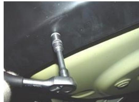
4.4. Afloje los tornillos de fijación en el lado derecho del guardabarros trasero y el parachoques trasero con una manga 7 #.
