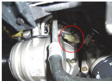
2.1.12. Retire el conector del interruptor de presión de aceite.
