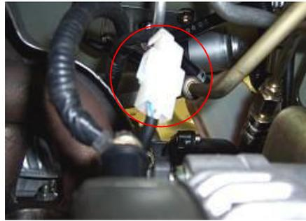
2.1.9. Retire el conector del generador.
