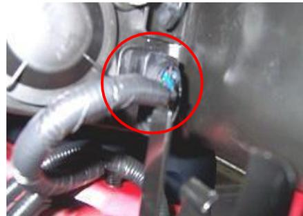
1.1.33. Halar por el arnés del compartimento del motor y los conectores del arnés del inyector electrónico del motor.
