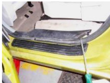
3.9. Afloje la moldura del pilar B con un destornillador en ángulo recto.
