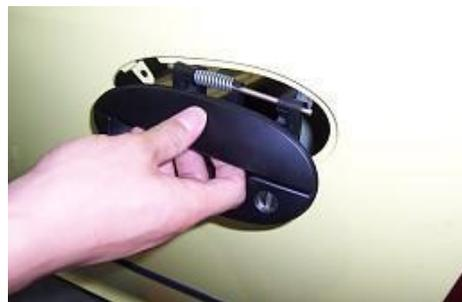
3.25. Retire los tres tornillos de fijación de la cerradura de la puerta delantera con un destornillador cruzado.
