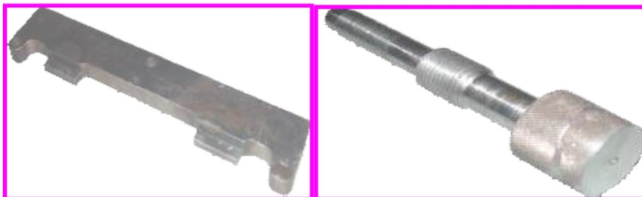
Herramienta especial para sincronización del árbol de levas herramienta especial para la verificación de la sincronización del cigüeñal (CH-20010) (CH-20003)
