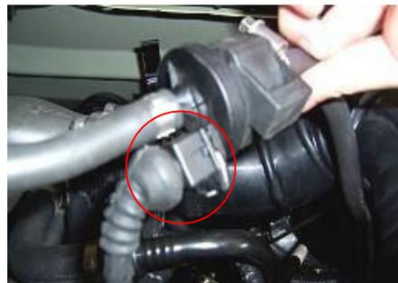
2.1.6. Retire el conector del sensor de presión de aire.
