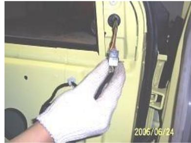
1.6. Halar a través del conector de la caja de sonido de la puerta delantera.
