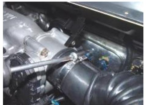
5. Retire los cuatro pernos de fijación del cuerpo del acelerador electrónico. Saque el conector y saque el cuerpo del acelerador electrónico.
