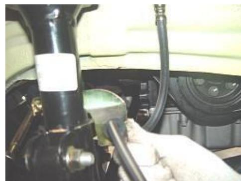
4.1.3 Retire los pernos de fijación del muñón de la dirección y el amortiguador con una manga de 18 #.
