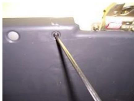
2.1.2. Retire los clips desechables de la placa de protección interna del maletero fijo con un destornillador plano y luego retire la placa de protección interna del maletero.
