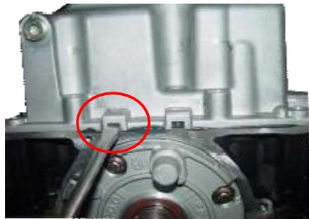
3. Use una manga 10 # para quitar el perno de fijación del filtro de aceite del motor.
