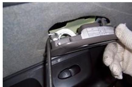
3.5. Afloje la cubierta protectora del interruptor de accionamiento de vidrio de la placa de protección interior de la puerta con un destornillador en ángulo recto.
