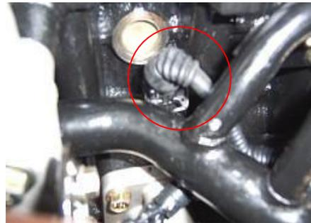
2.1.15. Retire el conector del interruptor de la lámpara de respaldo.
