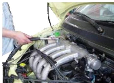
1.3 Atornille la junta del medidor de presión del cilindro lenta y verticalmente en el orificio de la bujía. No atornille demasiado fuerte por temor a que sea difícil desmontarlo.
