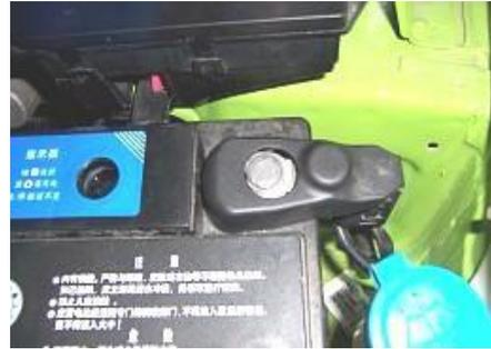
1.3. Retire el punto de conexión a tierra del arnés negativo de la batería en el cuerpo y quítese el arnés negativo de la batería.
