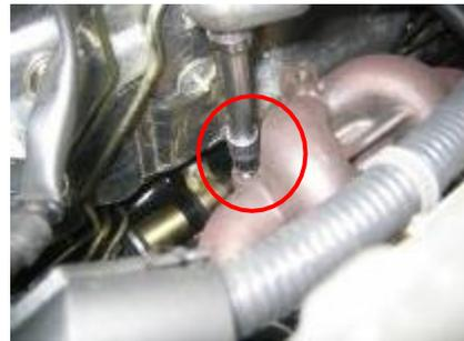
9.6 Use una manga de 13 # para quitar el perno de fijación del colector de escape.
