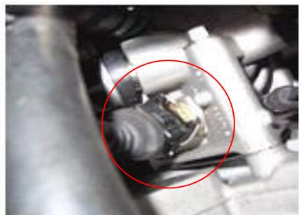
2.1.17. Retire el conector del sensor de oxígeno delantero y trasero.
