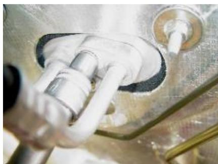
2.5. Afloje los tres pernos de fijación del evaporador y el lado frontal.
