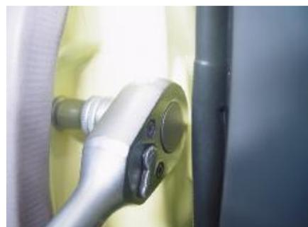
1.1.12. Retire dos vigas transversales del panel de instrumentos y los pernos de fijación de la suela con una manga 10 #.
