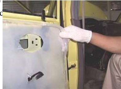
1.3. Halar fuera del conector del motor de elevación.
