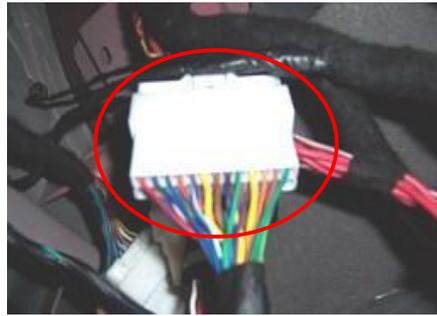
1.1.6. Halar fuera del conector al arnés de instrumentos conector B.
