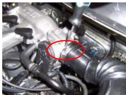
9.3 Use una manga de 13 # para quitar el perno de conexión del convertidor catalítico de tres vías y el tubo intermedio de escape.
