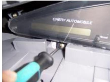
5.1.3. Desconecte el conector del arnés del instrumento combinado y luego retire el instrumento combinado.
