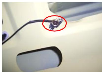
1.1.10. Retire los clips de fijación utilizados para sujetar el arnés de la puerta trasera.
