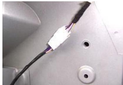
1.1.3. Retire los tornillos de fijación del interruptor de contacto de la puerta trasera con un destornillador cruzado.
