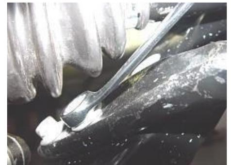
4.2.3 Retire los pernos de bola del brazo de control y el conjunto de junta universal de dirección con una manga de 18 #.
