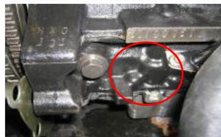
1.5 Inserte la herramienta especial CH-20003 en el orificio de sincronización y apriete, use una llave para girar la tuerca grande en la polea del cigüeñal para hacer que el cigüeñal gire, al mismo tiempo, atornille lentamente el CH-20003 hasta que el cigüeñal no pueda girar ida y vuelta por más tiempo.
