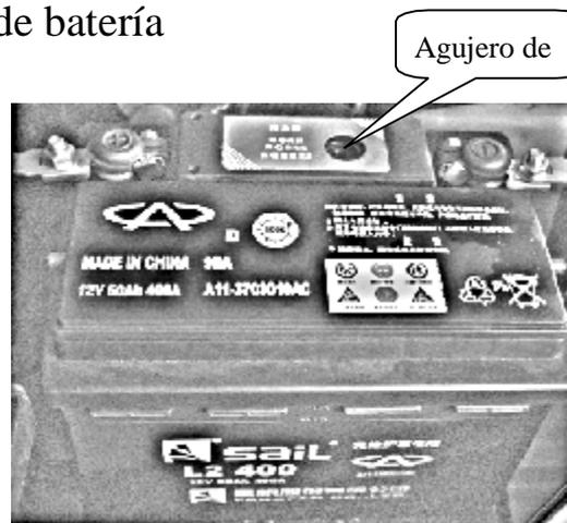
Compruebe si la conexión de la batería es segura y confiable; observe el aviso en el orificio de acceso al estado de la batería y cargue o reemplace la batería si es necesario.
