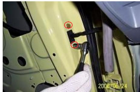
3.28. Retire el otro perno de fijación del limitador de la puerta con un manguito 10 # y luego retire el limitador de la puerta.
