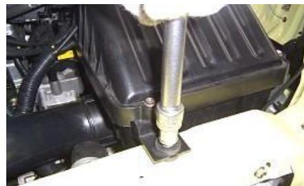
1.1.4. Afloje las tuercas de fijación de la entrada del filtro de aire con una manga.
