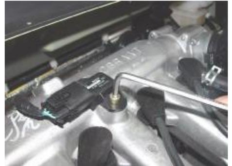
3. Posición y desmontaje del sensor de posición del árbol de levas.
