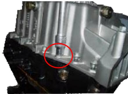
2. Use un destornillador para hacer palanca en el cárter de aceite en la posición dada para hacer palanca en el
