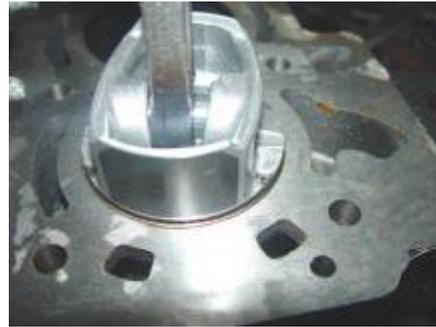
2.3.3 Use una galga de espesores para medir el espacio entre los extremos del anillo del pistón y el valor normal debe ser: 0.2 mm.
