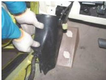
1.2. Retire la placa de desgaste, los bordes inferiores de los pilares B y C.
