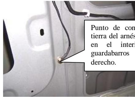
Punto de conexión a tierra del arnés interior en el interior del guardabarros trasero derecho.
