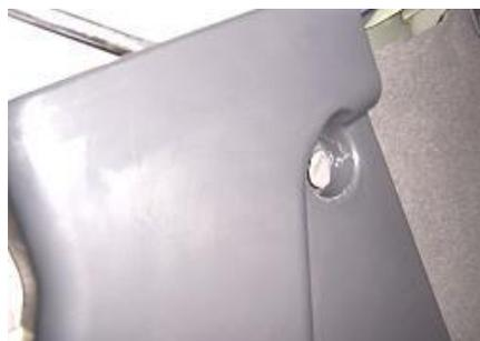
8.1.3. Retire el borde inferior del pilar C con un destornillador de cabeza plana.
