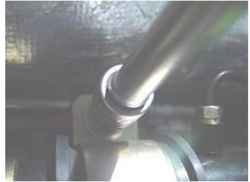
4.7 Retire los pernos de fijación y las tuercas de la parte inferior del soporte izquierdo del volante asistido con una funda de 15 #. Par:  $100 \pm 10$  Nm
