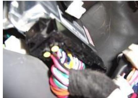
1.1.3. Retire la moldura inferior del pilar A con un destornillador cruzado.
