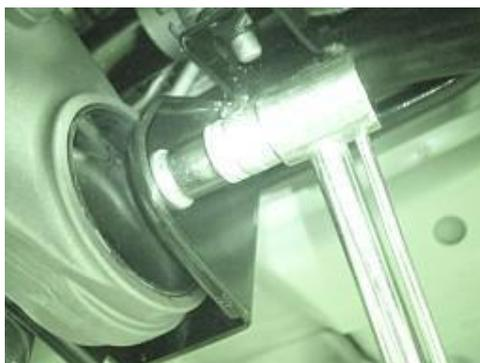
4.3.4 Retire dos pernos de conexión del colector de escape con una manga de 15 #.
