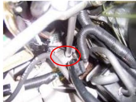
2. Use una manga 10 # para quitar el perno de fijación y el portador de la batería.
