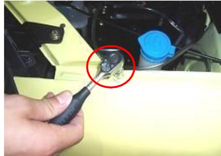
1.1.17. Retire los pernos de fijación del soporte del espejo retrovisor exterior en el guardabarros izquierdo con una llave de tubo de 10 #.
