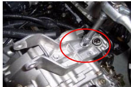
12.3 Use una manga de 13 # para quitar el perno de conexión de la caja de la transmisión y el motor, y luego separe el motor y la transmisión.
