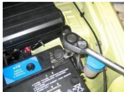
2. Use una manga 10 # para aflojar el perno de fijación del soporte de ajuste del generador, y luego retire el soporte de ajuste. Esfuerzo de torsión:  $30 + 5\text{Nm}$ .
