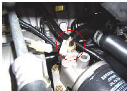
2.1.13. Retire el conector de la bomba de dirección asistida.
