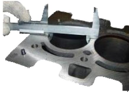
3.3 Ajustar desde el micrómetro exterior a los datos medidos por el calibrador a vernier, seleccione el polo de empalme adecuado para el rango del calibrador del cilindro y luego ajuste el micrómetro exterior a cero de acuerdo con estos datos.
