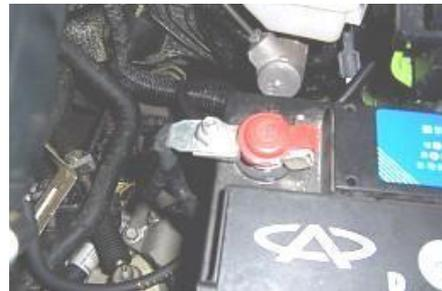
1.1.2. Retire el negativo de la batería y retire el conjunto de la batería.
