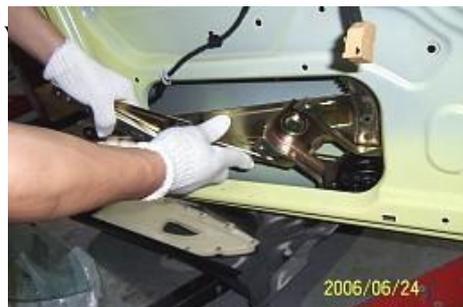
3.18. empujar aparte el montaje fijo de la barra del núcleo de la cerradura de la puerta con un destornillador en ángulo recto.
