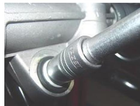
4.6 Retire los pernos de fijación y las tuercas de la parte superior del soporte izquierdo del volante asistido con una funda de 15 #. Par:  $100 \pm 10$  Nm
