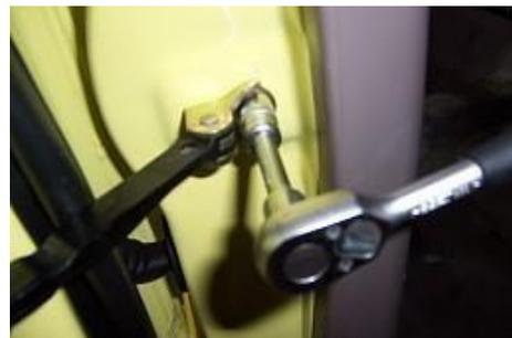
3.29. Afloje dos pernos de fijación superiores de la bisagra de la puerta delantera de la puerta con una llave de 13 #. Par:  $36 \pm 4$  N.m.
