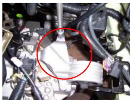
11.6 Use una manga de 13 # para aflojar los tres pernos de conexión del soporte izquierdo del soporte del motor.
