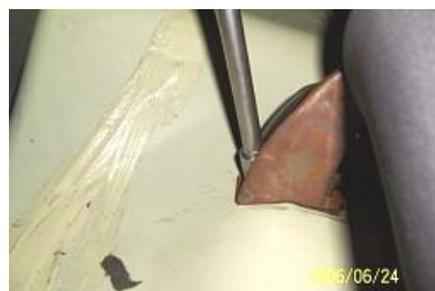
2.8. Afloje los tornillos de fijación delanteros del asiento trasero derecho con una llave de boca abierta.
