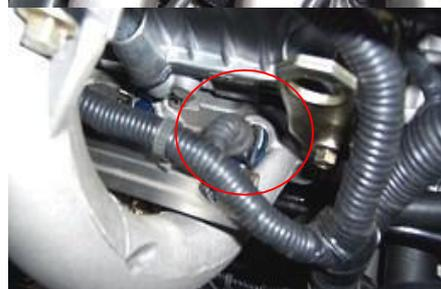
2.1.8. Retire el conector del indicador de carga.
