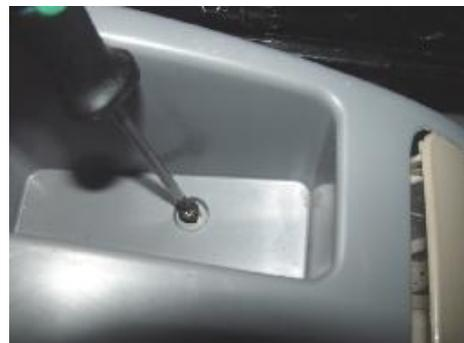
4.7 Retire los dos pernos de fijación del freno de mano como se muestra en la imagen con una llave de tubo de 10 #.
