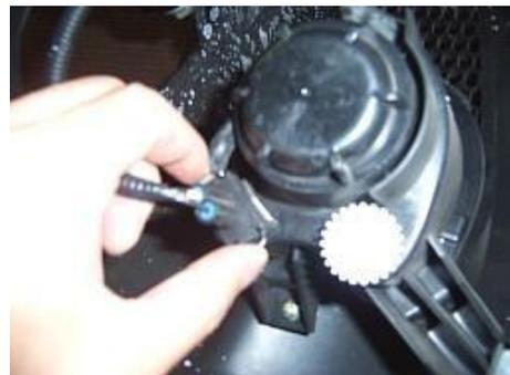
5.3. Desatornille tres tuercas de fijación de la luz antiniebla con un destornillador cruzado.
