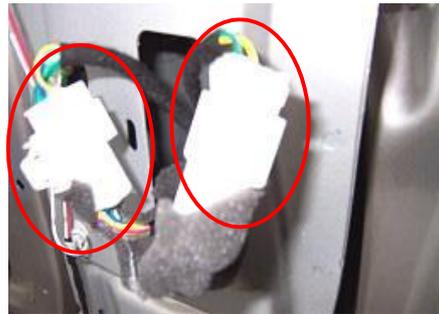
2.1.6. Halar a través del conector del interruptor del cinturón de seguridad auxiliar.
