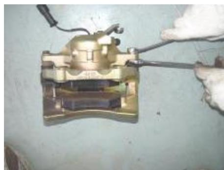
4.10 Retire el sello a prueba de polvo y verifique el daño del sello a prueba de polvo. Si es necesario, reemplácelo. Limpie la superficie de contacto del pistón del freno y aplique una capa delgada de pasta de silenciador. Atención que el sello a prueba de polvo NO es se puede poner en contacto la pasta del silenciador porque puede hacer que el sello se hinche.
