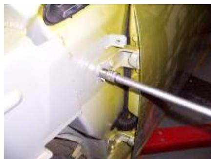
5.2.3. los La fuerza de cierre de la puerta se puede ajustar ligeramente regulando la posición de la columna de bloqueo de la puerta delantera.
