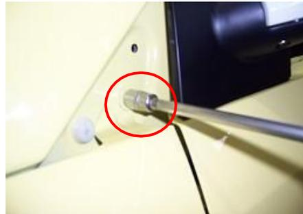
1.1.18. Retire el parachoques delantero con un destornillador cruzado.
