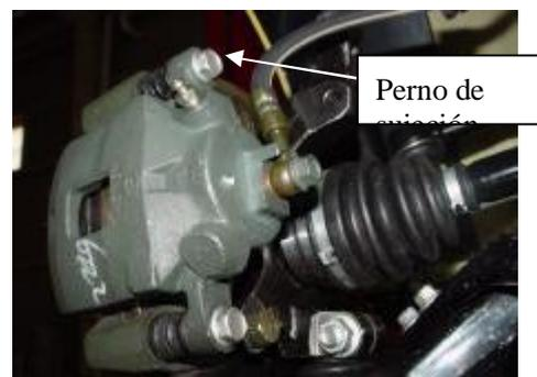
4.3 Desenrosque el perno de fijación como se muestra en la imagen con una llave dinamométrica de 14 # y un manguito.
