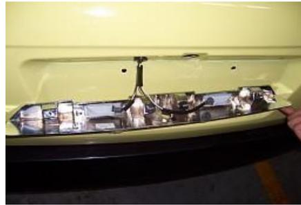
4.1.4. Retire dos tornillos de fijación de la lámpara de la matrícula con un destornillador cruzado.
