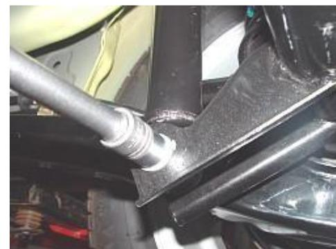
4.1.3 Retire los pernos de conexión del conjunto del amortiguador y el cuerpo con una llave no ajustable de 18 #, y luego retire el conjunto del amortiguador.
