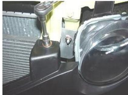
4.3 Afloje los pernos de fijación del parachoques delantero de la parte intermedia de la viga transversal del radiador con un manguito 10 #.
