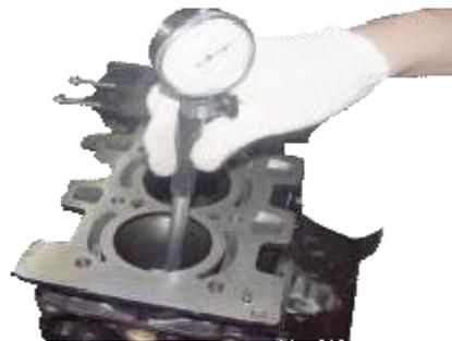
3.5 La posición de medición del medidor de cilindro en el cilindro es como se muestra en la figura.
