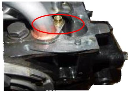
4. Use una manga de 8 # para quitar el perno de fijación del tablero de protección de aceite del motor.
