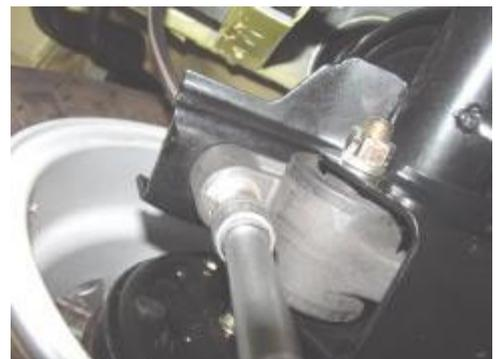
4.3.2 Retire los pernos de conexión del intermedio del eje trasero y el conjunto del brazo de arrastre con una manga de 13 #.
