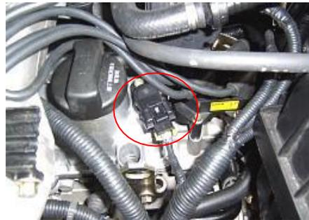
2.1.5. Retire el conector del conector de la válvula solenoide del envase.
