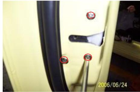
3.26. Halar retire el conector del sujetador y luego quítelo.
