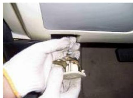
7.1.2. Retire el cable del capó delantero del capó.
