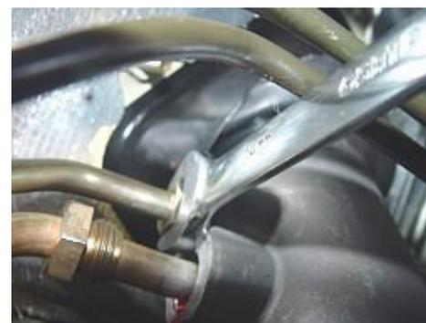
4.4 Retire los pernos y tuercas de fijación de la parte superior del soporte derecho del volante asistido con una funda de 15 #. Par:  $100 \pm 10$  Nm
