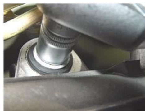
4.5 Retire los pernos y tuercas de fijación de la parte inferior del soporte derecho del volante asistido con una funda de 15 #. Par:  $100 \pm 10$  Nm
