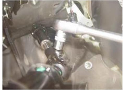
4.17 Quitarse Los tornillos de conexión de la junta universal de dirección y el volante. Saque el conjunto de dirección universal conjunta.
