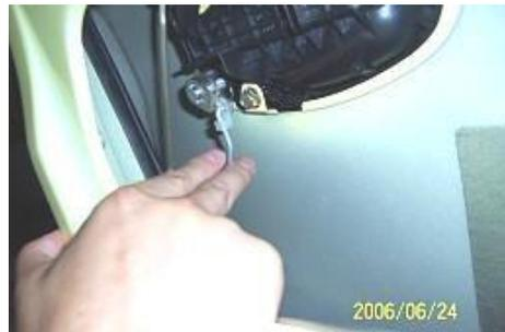
3.23. Afloje los tornillos de fijación de la manija exterior de la puerta delantera con un destornillador cruzado.
