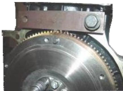
3. Use un manguito 13 # para aflojar el perno de fijación del rodamiento de la biela cilindro por cilindro y
