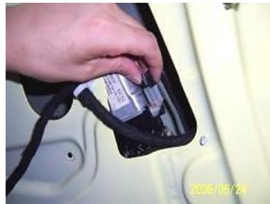
1.4. Halar fuera del conector de la cerradura de la puerta. (Ver *Desmontaje / Montaje de la cerradura de la puerta*)
