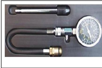
Manómetro para cilindro: se utiliza para medir la presión del cilindro. Al medir, retire primero la bujía, atornille el orificio de la tubería del instrumento en la posición de la bujía, use el motor de arranque para arrastrar el motor para girar y luego obtenga la lectura máxima del manómetro para cilindro como presión de cilindro de este cilindro.
