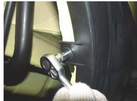
4.3. Afloje los tornillos de fijación en el lado izquierdo del guardabarros trasero y el parachoques trasero con una manga 7 #.
