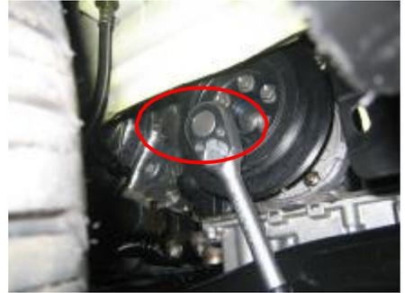
1.7 Use una manga 10 # para quitar los seis pernos de fijación en la cubierta inferior de sincronización.
