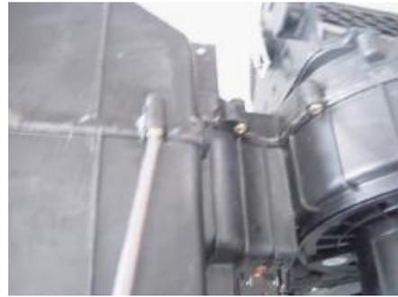
4.1.10. Retire cuatro tornillos de dos láminas de hierro fijadas al tubo del calentador de A / C con un destornillador cruzado.
