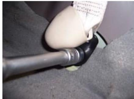
3.7. Afloje la cubierta de adorno en el regulador del cinturón de seguridad con un destornillador de cabeza plana.
