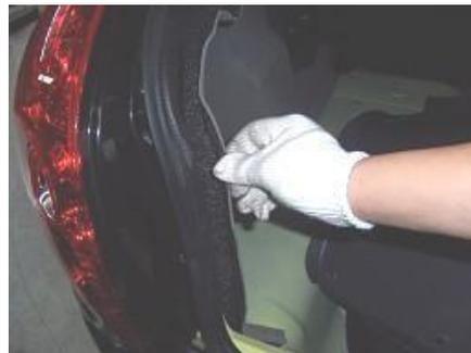
7.3. Retire las tuercas de fijación del asiento superior de la luz trasera con una llave fija.
