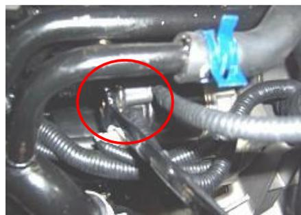
1.1.25. Halar hacia afuera dos conectores A y B del motor del ventilador.
