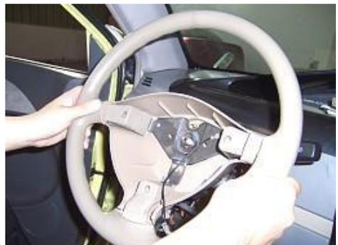
4.6 Retire los cinco pernos de fijación de la cubierta protectora del interruptor combinado con un destornillador cruzado.
