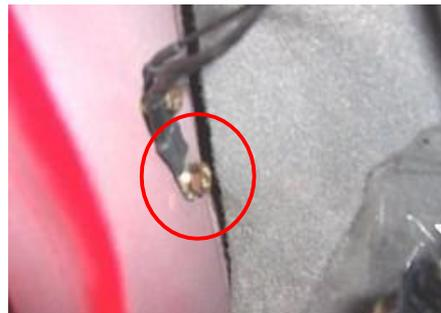
1.1.9. Retire la consola. (Ver *Desmontaje / montaje de la consola*)
