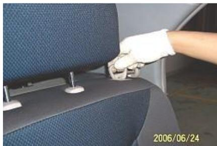
3.0. Afloje el perno de fijación trasero del asiento trasero izquierdo con un manguito y luego retire el asiento trasero izquierdo.
