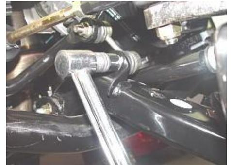
4.2.2 Retire los pernos de conexión de la barra de empuje frontal y el brazo de control con una llave de 15 #.
