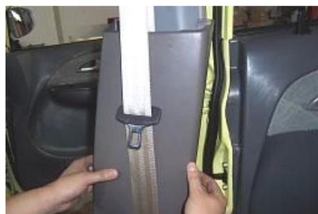
3.11. Retire los tornillos de fijación del cinturón de seguridad con un destornillador cruzado.
