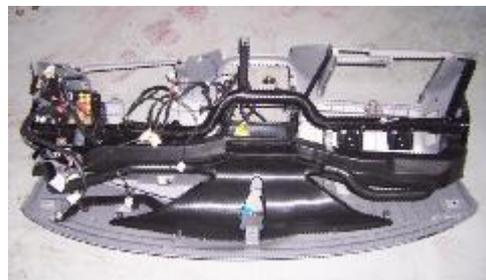
1.5. Afloje los tornillos fijos del conducto de aire frontal y retire el conducto de aire frontal.
