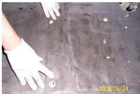
2.2. Coloque la parte trasera central izquierda de la alfombra de acuerdo con la forma de la parte inferior del vehículo, revele los orificios
