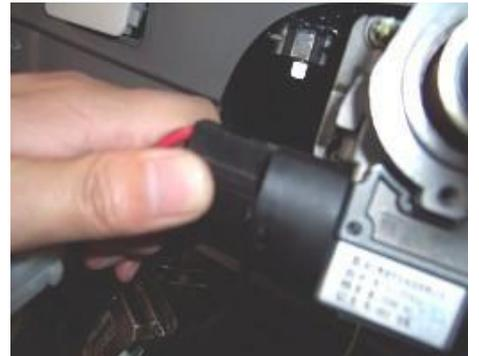
4.13 Retire el conjunto del cuerpo de la cerradura de encendido con una llave Allen. Par:  $25 \pm 3$  Nm
