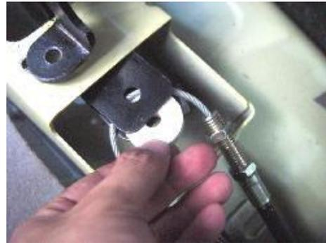
4.11 Extraiga el cable de control del freno de mano desde la parte inferior de la carrocería del vehículo.
