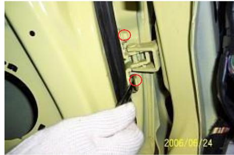
4.31 Retire los pernos de fijación del limitador de puerta de la puerta con un manguito 10 #. Par:  $10 \pm 1\text{ Nm}$
