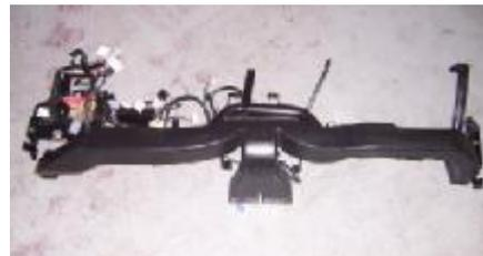
2.1.5. Retire los dos tornillos utilizados para sujetar el conducto de aire de la viga transversal con un destornillador cruzado.
