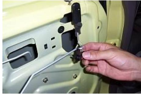
3.21. Separe los clips de fijación superiores de la barra central de la cerradura de la puerta delantera de la cerradura con la mano.
