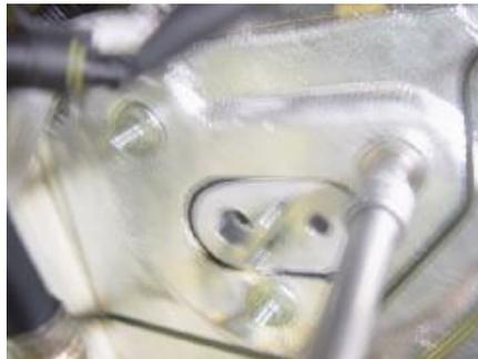
2.6. Retire los anillos de retención del tubo de entrada / salida del radiador del evaporador con un alicate y extraiga el tubo de agua.
