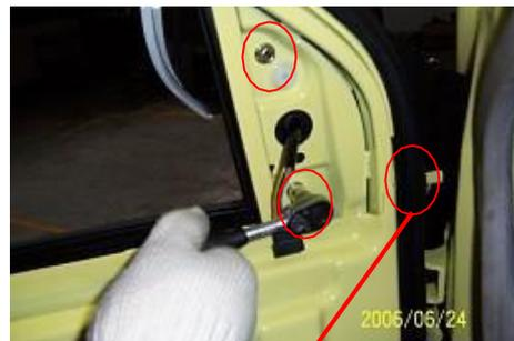
4.13 Retire los tres tornillos de fijación del espejo retrovisor exterior con una funda.
