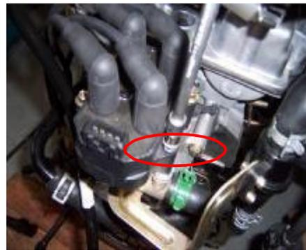
2 Use un manguito 10 # para quitar el perno del soporte de fijación del colector de admisión.
