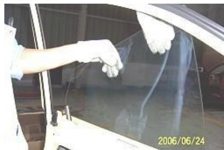
4.24 Separe los clips de fijación inferiores de la barra central de la cerradura de la puerta delantera de la cerradura con la mano.
