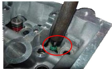
5. Use un martillo para golpear la herramienta de instalación del sello de aceite de la válvula, cuando escuche un ruido metálico, saque CH-20012.
