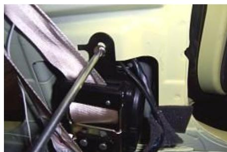
3.12. Afloje las tuercas de fijación con una manga de 17 # y luego quítese el cinturón de seguridad.
