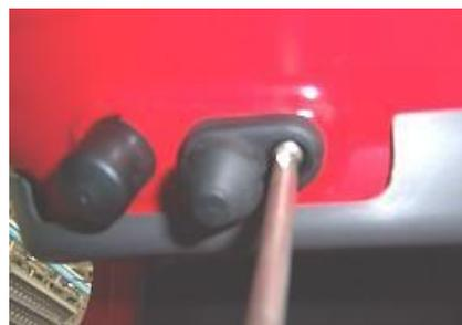
1.1.4. Halar fuera del conector del interruptor de contacto de la puerta trasera.
