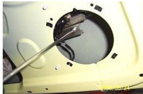
3.13 Afloje dos tornillos de fijación en el vidrio con un destornillador de cruz.
