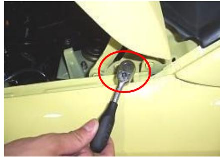
1.1.16. Retire los pernos de fijación inferiores del guardabarros izquierdo con una llave de tubo de 10 #.
