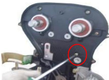
5. Use un manguito 10 # para quitar el perno de fijación del cojinete del árbol de levas, saque el conjunto del árbol de levas y luego el sistema de empuje hidráulico.
