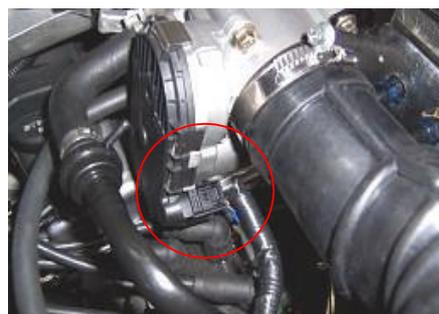
2.1.3. Retire los conectores de la bobina de encendido.
