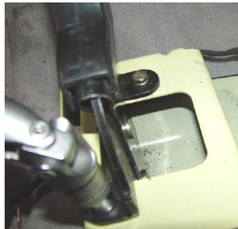
4.8 Afloje los dos tornillos de fijación del cable de control con una llave de caja de 14 # y luego retire la placa guía.
