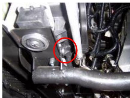
4.2 Use los alicates de anillo elástico para aflojar la abrazadera en la tubería de conexión del tanque de agua.
