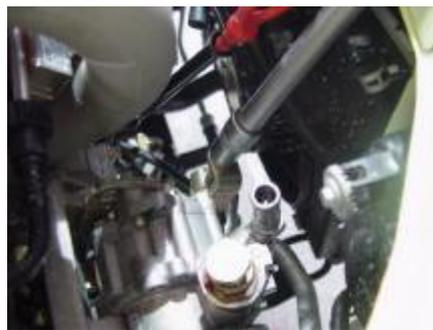
6. Use una manga 10 # para aflojar el perno de conexión de la bomba de dirección y el soporte del compresor, extraiga el conector del arnés y luego desmonte el conjunto de la bomba de dirección.
