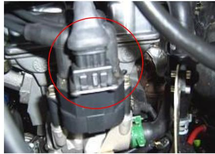
2.1.4. Retire el conector del sensor del árbol de levas.
