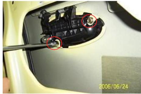
4.26. Saque el núcleo de la cerradura y maneje el conjunto.
