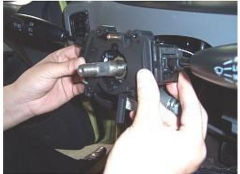
4.12 Halar fuera del conector del interruptor de encendido.
