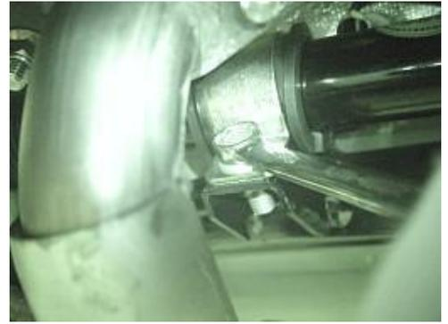
4.3.7 Retire los pernos de fijación del lado izquierdo del volante de asistencia eléctrica con una llave de 15 #.
