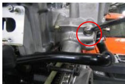
5.9 Use una llave de tubo de 10 mm para quitar el asiento del termostato. Tenga cuidado de no dañar la junta de lámina delgada.
