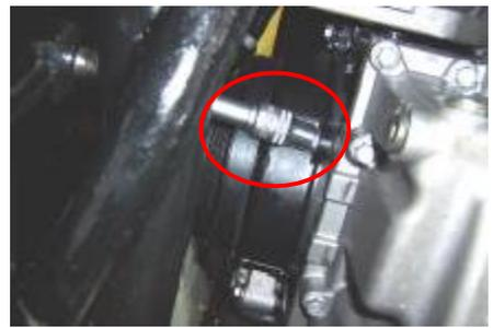
1.8 Las posiciones de los seis pernos de fijación en la cubierta inferior de sincronización se muestran mediante los círculos rojos en la figura.
