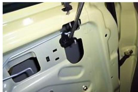
3.19. Separe los clips de fijación de la barra del núcleo de la cerradura con la mano.
