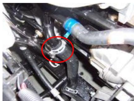
4.3 Use los alicates de anillo elástico para aflojar la tubería de conexión de agua del tanque de agua de calefacción A / C.
