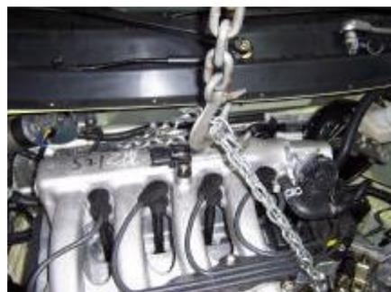
11.4 Use una manga de 15 # para aflojar el perno de fijación del soporte derecho del motor. (en la parte trasera de la transmisión)
