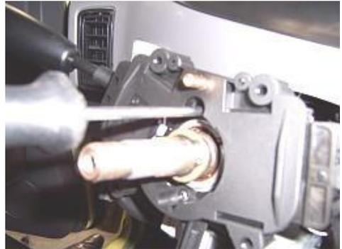
4.8 Halar fuera de los conectores del interruptor de encendido y el interruptor combinado.
