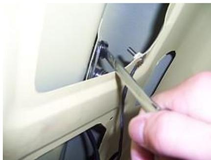
3.1.3. Retire el núcleo de bloqueo del maletero.
