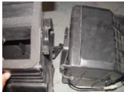
4.1.4. Retire el mecanismo de regulación de la dirección del aire del distribuidor con un destornillador cruzado (como se muestra en la figura).
