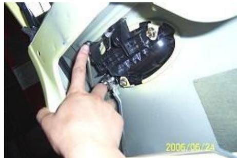
3.22. Separe los clips de fijación inferiores de la barra central de la cerradura de la puerta delantera de la cerradura con la mano.
