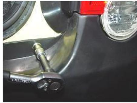
4.2. Afloje los tornillos de fijación y los clips del parachoques trasero y el guardabarros trasero con una manga 7 #. Par: 7N · m
