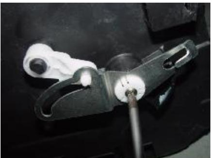
4.1.5. Retire los ocho tornillos de conexión de la carcasa del distribuidor con un destornillador cruzado (como se muestra en la figura).
