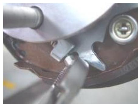
4.2 Retire el perno aquí del soporte fijo del cable de control del freno de mano con una llave de caja de 13 #.
