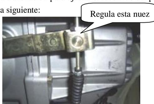
El método de regulación .: la tuerca de regulación del cable de control del embrague es una contratuerca. En caso de regulación, empuje hacia afuera el cable de control para que la tuerca de regulación tenga una separación adecuada del brazo de separación del embrague. En este caso, el recorrido del embrague solo se puede ajustar. Gire la tuerca en el sentido de las agujas del reloj para reducir el recorrido libre; y gire la tuerca en sentido antihorario para aumentar el recorrido libre.
