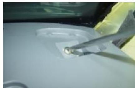
1.1.11. Retire las cuatro vigas transversales derecha e izquierda del panel de instrumentos y los pernos de fijación de ambos lados de la carrocería del vehículo con un manguito 10 #. Par:  $23 \pm 2$  Nm
