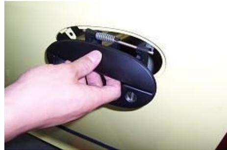
4.27 Retire los tres tornillos de fijación del núcleo de la cerradura de la puerta delantera con un destornillador cruzado. Par de instalación:  $9 \pm 1$  Nm
