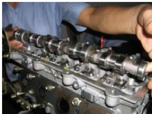
9. Recuerde aplicar sellador a la posición como se muestra en la figura al instalar la primera carcasa del rodamiento.
