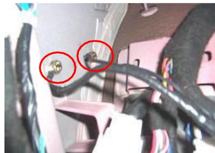
1.1.10. Halar fuera del conector del motor del limpiaparabrisas.
