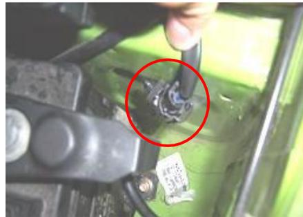
1.1.22. Halar fuera del conector del sensor de nivel de líquido de frenos.
