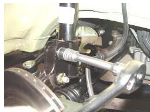
4.1.4 Retire los tres pernos de fijación al marco del conjunto del amortiguador con una manga de 15 #.
