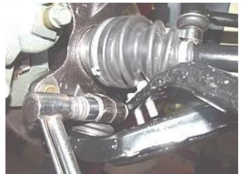
4.2.4 Retire los pernos de conexión del brazo de control y el eje delantero con una manga de 18 #, y luego retire el conjunto del brazo de control. Par:  $150 \pm 10\text{ Nm}$
