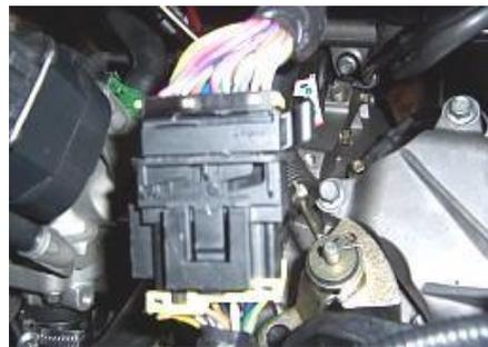
2.1.2. Retire el conector del acelerador electrónico.
