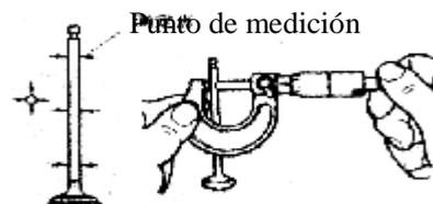
2.2.2 Medición del diámetro interno de la guía de la válvula Use un micrómetro interno para medir el diámetro interno de la guía.
