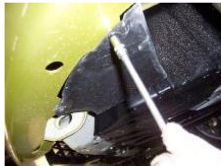
4.5. Desenrosque el perno de fijación del guardabarros al lado del parachoques con la manga No.7.
