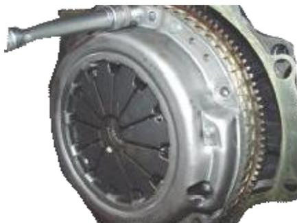
2. Usa la herramienta especial CH-20009 para bloquear el cigüeñal y luego usar un manguito 13 # para quitar el perno de conexión del volante y el cigüeñal.
