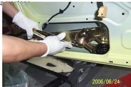
4.23 Separe los clips de fijación superiores de la barra central de la cerradura de la puerta delantera de la cerradura con la mano.
