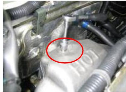
9.5 Use una manga 13 # para quitar el perno de conexión del colector de escape y el convertidor catalítico de tres vías. Par:  $60 \pm 5$  Nm.
