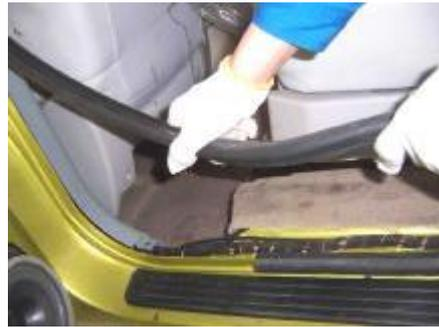
3.5. Retire la cubierta de adorno inferior del cinturón de seguridad.
