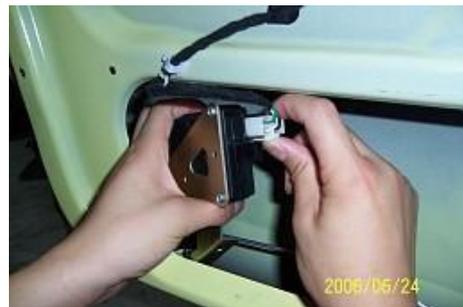
3.27. Retire el perno de fijación del limitador de la puerta con una manga 10 #.
