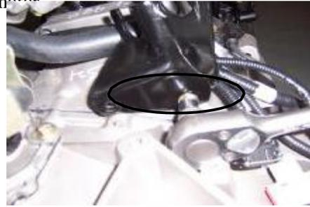
12.2 Use una manga de 13 # para aflojar los cuatro pernos de fijación del soporte de montaje delantero del motor.
