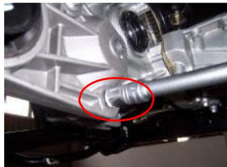
11.2 Use una manga de 18 # para aflojar el perno de fijación del soporte de montaje delantero del motor.
