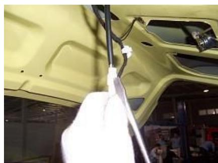
3.1.2. Separe los dos tornillos de fijación del seguro del maletero (el par de instalación es de  $9 \pm 1$  Nm)
