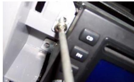
2.1.3. Retire los dos tornillos de fijación aplicados para unir el interruptor de emergencia y el cuerpo del panel de instrumentos con un destornillador cruzado.
