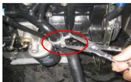
5.3 Use una manga de 10 mm para quitar el perno de fijación del tubo de descarga de la bomba de agua y luego extraiga el tubo de descarga.
