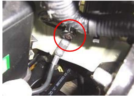
1.1.21. Halar fuera del conector del sensor de la rueda delantera izquierda.
