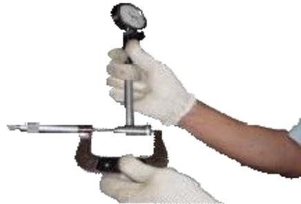
3.4 Coloque el medidor del cilindro en el cilindro para medir; Al medir, el ángulo de guiñada del calibrador del cilindro no debe exceder los 15°. Obtener el valor numérico máximo.
