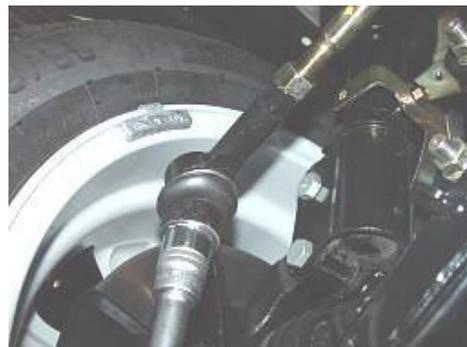
4.2 Afloje los pernos de fijación de la parte inferior del tubo de aceite de la dirección asistida con una llave no ajustable de 18 #. Par:  $25 \pm 5$  Nm
