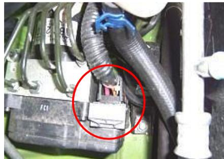
1.1.14. Retire el controlador del ABS, retire el punto de conexión a tierra del ABS.
