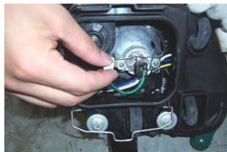
4.7. Retire los dos tornillos de fijación con un destornillador cruzado.
