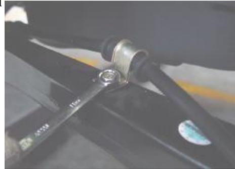
4.3 Retire los otros pernos del soporte fijo del cable de control del freno de mano con una llave de caja de 10 # o una llave de tubo de 10 #.
