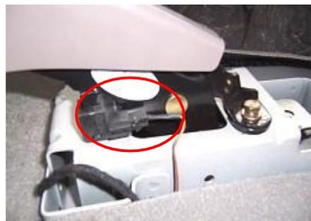
1.1.11. Retire el conector del interruptor principal del cinturón de seguridad.
