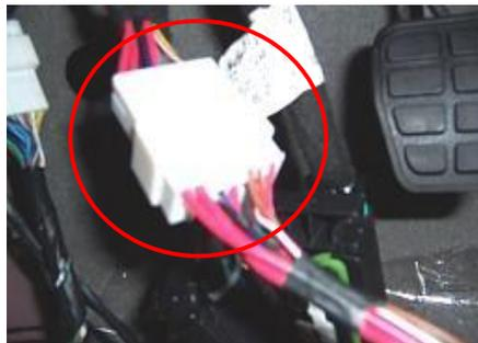
1.1.9. Halar fuera del conector del pedal del acelerador electrónico.
