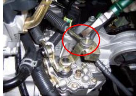
10.3 Use una manga de 13 # para aflojar el tornillo de ajuste del cable de control del embrague y luego retire el cable de control del embrague.
