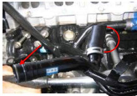
5.4 Use una manga de 10 mm para quitar el perno de fijación de la bomba de agua y luego saque el conjunto de la bomba de agua; Al retirarlo, tenga cuidado de no dañar el cojín de la bomba de agua; si está dañado, reemplácelo por uno nuevo. La bomba de agua no se puede descomponer para mantener.
