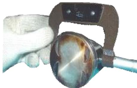
2.2 El pasador del pistón es de tipo semi-flotante, que no se puede desmontar durante el mantenimiento, ya que no se puede ensamblar utilizando una técnica de mecanizado común después del desmontaje. Si se produce un ruido anormal debido a una separación incorrecta del pasador del pistón, reemplace el conjunto del pistón.
