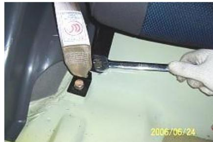
2.4. Afloje los pernos de fijación delanteros en el lado izquierdo del asiento trasero derecho con una llave de boca abierta.
