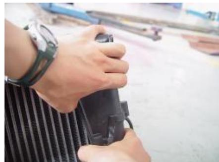
4.1.13. Quitarse El evaporador y la válvula de expansión de la carcasa inferior.
