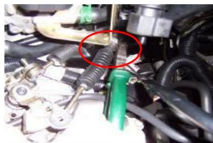
10.2 Use unos alicates para quitar el clip de fijación de la caja exterior del cable de control de la palanca de cambios y luego retire el cable de control de la palanca de cambios.
