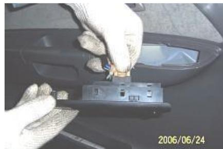
4.3. Desatornille los tornillos de fijación de la manija interior de la puerta delantera con un destornillador cruzado.
