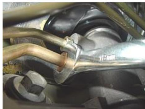
4.3 Afloje los pernos de fijación de la parte superior del tubo de aceite de la dirección asistida con una llave no ajustable de 13 #. Par:  $25 \pm 5$  Nm
