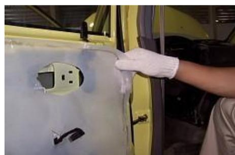
3.10. Desatornille los cuatro tornillos de fijación de la caja de sonido de la puerta delantera con un destornillador de cruz. Saque el conjunto de la caja de sonido.
