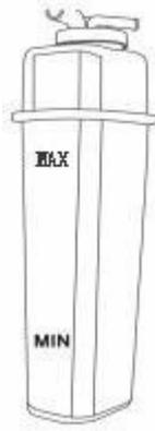
**PRECAUCIÓN: NO rellene el refrigerante cuando el motor esté en estado caliente. Vuelva a llenar el refrigerante después de que el motor se enfríe.**
