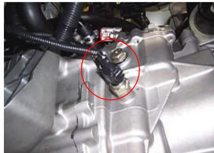
2.1.16. Retire el conector del sensor de temperatura del agua.
