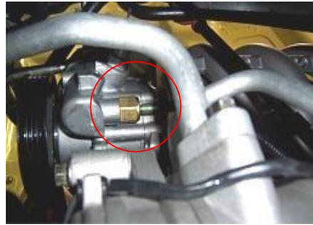
2.1.14. Retire el conector del sensor de detonación.
