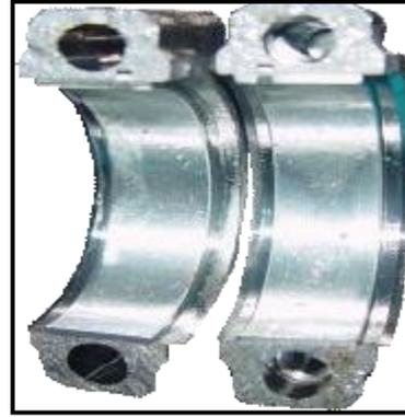
El par de apriete para instalar el perno de fijación del cojinete de la biela es de  $25 \pm 3$  Nm (luego gire  $90 \pm 5^\circ$  en sentido horario).
