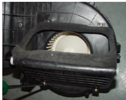
4.1.8 Retire los tornillos de fijación del mecanismo de control de aire de recirculación interior-exterior con un destornillador cruzado, y luego retire el mecanismo de control de aire de recirculación interior-exterior. Par:  $1.5 \pm 0.5$  Nm
