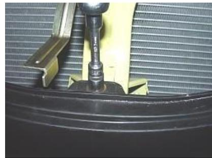
4.4 Afloje dos pernos de fijación debajo del parachoques del guardabarros con una manga 7 #. Par de instalación:  $2 \pm 0.5$  Nm
