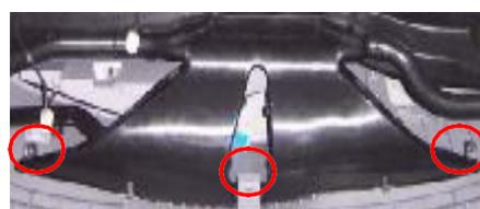
2.1.3. Retire los cuatro tornillos de fijación de ambos lados del panel de instrumentos y la viga transversal con un destornillador cruzado.
