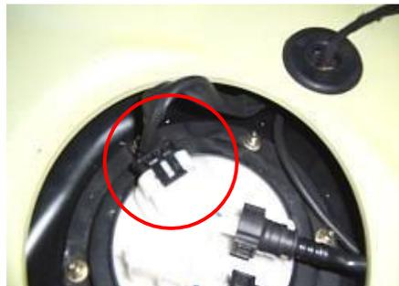
1.1.23. Halar a través del conector del sensor de velocidad de la rueda trasera izquierda.
