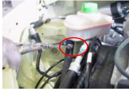
2. Use una manga de 21 # para quitar el perno de fijación del tubo de aceite de la bomba de dirección.
