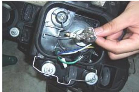
4.9. Desatornille la cubierta del asiento de la luz de ca
