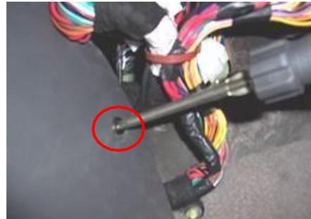
1.1.4. Retire los dos puntos de puesta a tierra de la ECU.
