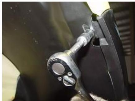
4.6 Retire los pernos de fijación del guardabarros del costado del parachoques con un destornillador cruzado.
