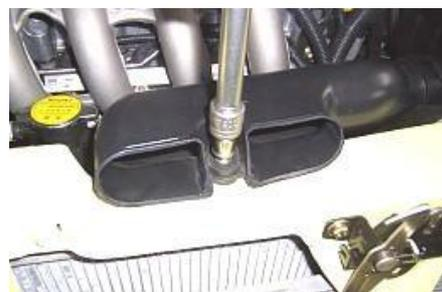
1.1.5. Halar Saque la manguera utilizada para conectar el filtro de aire con el colector de admisión del motor a mano.
