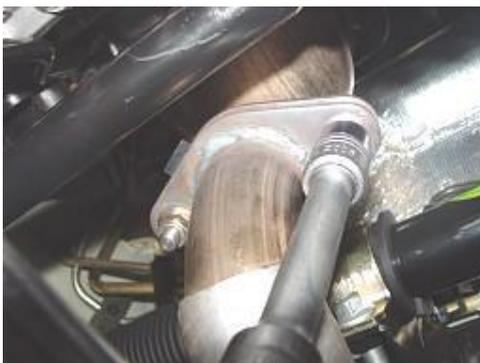
4.3.5 Retire los dos pernos de conexión utilizados para conectar el colector de escape y el silenciador trasero con una manga de 15 #.
