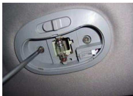
5.1.3. Halar retire el conector del arnés y luego retire el conjunto de la lámpara de techo frontal.
