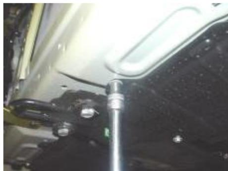
4.3.2 Retire los pernos del soporte frontal del bastidor auxiliar de la transmisión con una funda de 19 #.
