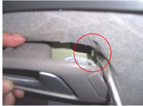
4.6. Retire los tornillos de fijación de la placa de protección interior de la puerta delantera con un destornillador cruzado.
