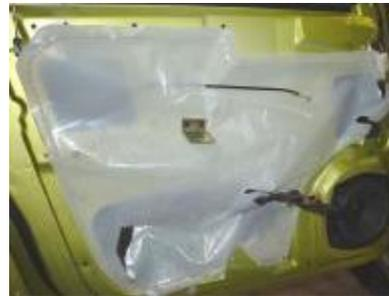
1.3. Halar fuera del conector del motor de elevación.
