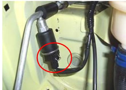
1.1.12. Halar fuera del conector del sensor de la rueda delantera derecha.
