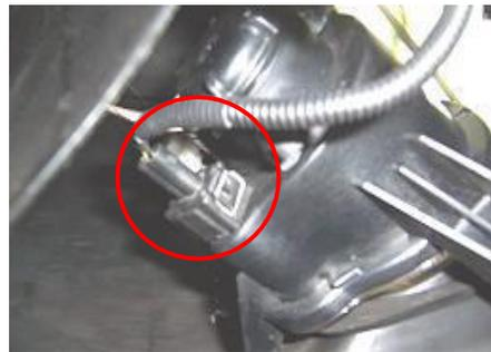
1.1.28. Retire el punto de tierra del motor del ventilador. (En la parte frontal del miembro lateral izquierdo, y cerca del faro)
