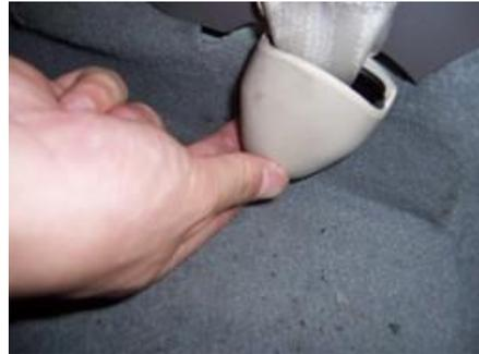
3.6. Desatornille las tuercas de fijación con una manga de 17 # y separe el borde inferior del pilar B.
