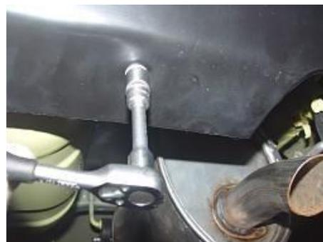
4.5. empujar Retire los clips de fijación del parachoques trasero del guardabarros trasero con la mano.
