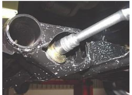
4.3.9 Retire el soporte fijo de la tubería de A / C en el bastidor auxiliar con una llave 10 #.
