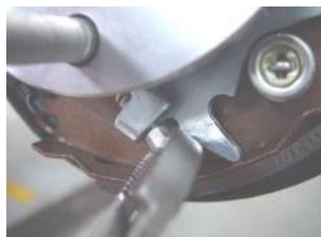
4.4 Retire el cable de control del freno de mano en el otro lado con el mismo método.
