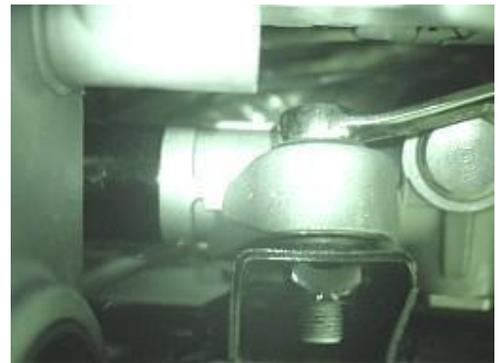
4.3.8 Retire los pernos de fijación utilizados para conectar la barra de empuje y el bastidor auxiliar con un 19 # manga.
