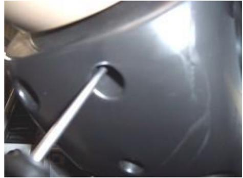
4.7 Retire los cuatro pernos de fijación del interruptor combinado con un destornillador cruzado.
