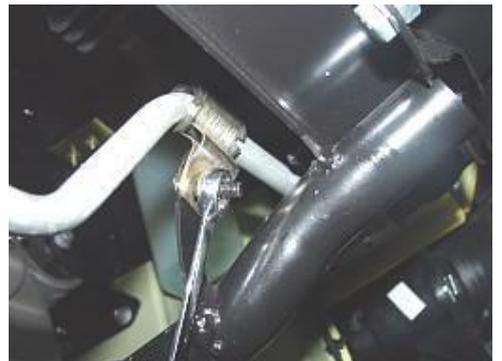
4.3.10 Retire el soporte fijo del condensador y el bastidor auxiliar con una llave de 13 #.
