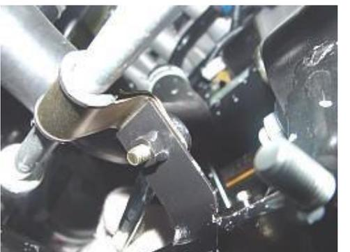
4.3.11 Retire las cuatro tuercas que se utilizan para conectar el bastidor auxiliar y el cuerpo con una funda de 18 #, y luego retire el conjunto del eje delantero.
