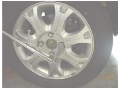
4.2 (**Verifique el grosor del revestimiento de fricción**) Desatornille el perno de fijación como se muestra en la imagen con una llave dinamométrica de 14 # y un manguito. Par: 22-23N.m.
