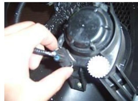
4.9 Retire los tres tornillos aplicados para unir la luz antiniebla y el parachoques con un destornillador cruzado.
