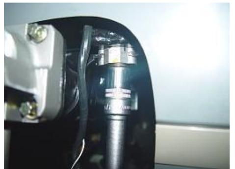
4.15 Retire las dos tuercas de fijación inferiores de la columna de dirección con una manga de 13 #.
