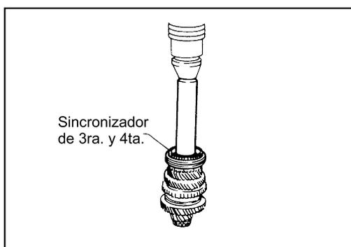
4. Instale la bola de acero, engranaje de 2a. de la flecha principal, buje de 2a. y 3a., engranaje de 3a. de la flecha principal y sincronizador de 3a. y 4a.
