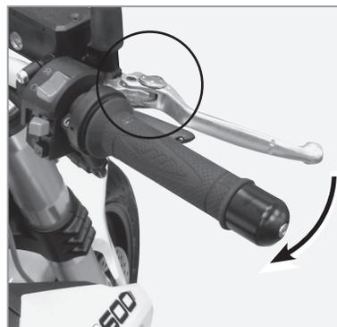
La maneta del freno está equipada con un pomo de regulación "1" de la posición. Para regular la distancia entre la maneta del freno y el mando del acelerador, gire el pomo en sentido horario o antihorario; si se gira en sentido antihorario la maneta se acerca, por el contrario si se gira en sentido horario la maneta se aleja. Asegúrese de que la regulación correcta configurada en el cuadrante de regulación esté alineada con la referencia "2"
