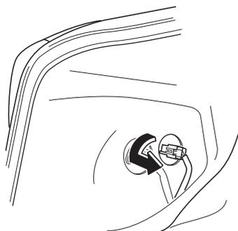
7. Desconecte el conector de la unidad presionando la lengüeta del conector con un dedo y tirando del conector.
