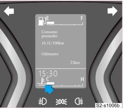
Cuando el interruptor de encendido está encendido, el medidor de temperatura muestra la temperatura del líquido refrigerante.
