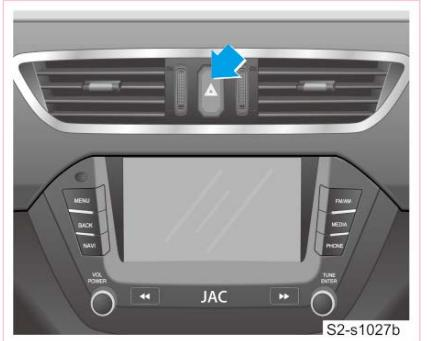
Hay una marca triangular en el interruptor de las luces de emergencia, como se muestra en la figura superior. Cuando el interruptor de encendido esté apagado, la luces de emergencia igual podrán funcionar. En los casos siguientes, debe encender las luces de emergencia:
