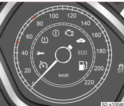
El velocímetro muestra la velocidad del vehículo en Km/h. Durante el periodo de experimentación ponga atención en los puntos importantes en la instrucción de manejo.
