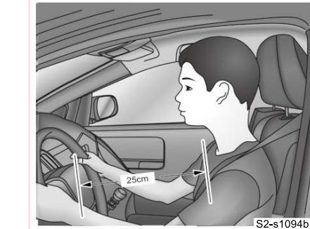
1. Ajustar el volante: El conductor debe mantenerse al menos a 25cm del volante.
