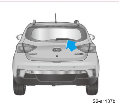
Para reemplazar la película del limpiaparabrisas trasero, levantar el brazo del limpiaparabrisas para separarlo del parabrisas trasero; de esta manera, la película del limpiaparabrisas podrá ser retirada y reemplazada.
