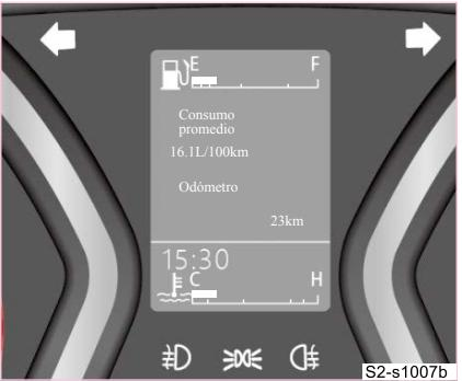
**a** Primera fila : Medidor de combustible Muestra la cantidad residual del combustible.
