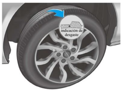
Se puede revisar los indicadores de desgaste para determinar cuándo se debe reemplazar los neumáticos. Cuando el espesor de la banda de rodaje sólo queda 1,6 mm o menos, los indicadores de desgaste de la banda de rodaje se aparecen visibles.
