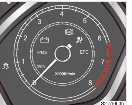
El tacómetro muestra las revoluciones (rpm) del motor. Para no dañar el motor no conduzca el vehículo cuando la aguja está en la parte roja.
