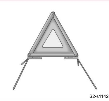
Al utilizar el triángulo de advertencia, puede colocarse a unos 150 metros de distancia de su vehículo al lado de la carretera.
