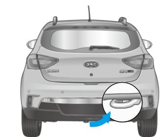
Cuando no funciona los otros vehículos o en caso de avería, se puede usar el gancho de remolque trasero como el punto de remolque para vehículos de otras personas.
