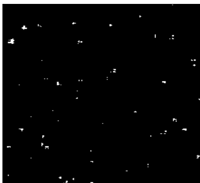
Figura IV.8. Microporos de una película de pintura de base acuosa sin agente desaireante
