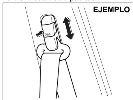
Ajuste la altura del ancla del hombro de manera que la correa del hombro se apoye sobre el centro del hombro exterior. Para subirlo, deslice el anclaje hacia arriba. Para bajarlo, deslice el anclaje hacia abajo mientras presiona el botón de bloqueo en los modelos de 3 puertas, o tira de la perilla de bloqueo hacia fuera en los modelos de 5 puertas. Después del ajuste, asegúrese de que el anclaje haya quedado firmemente enclavado.
