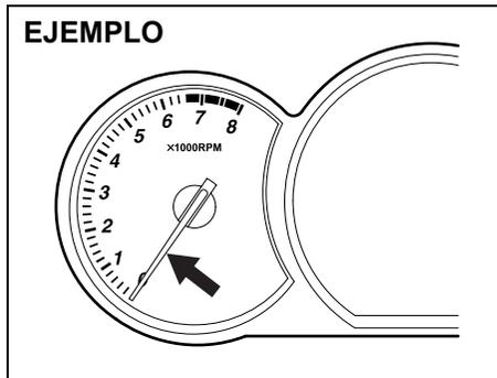
El tacómetro indica la velocidad del motor en revoluciones por minuto.
