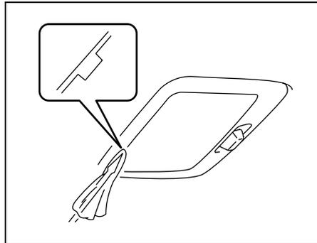
Con un destornillador de punta plana cubierto con un paño suave, saque el lente hacia abajo, tal como se observa en la ilustración. Para instalarlo, simplemente vuélvalo a colocar en su lugar.
