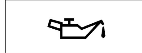
Esta luz se enciende al girar el interruptor de encendido a la posición "ON", y se apaga al arrancar el motor. Si esta luz se enciende y se mantiene encendida, significa que la presión de aceite es insuficiente. Si se enciende mientras conduce, salga de la carretera y apague el motor.
