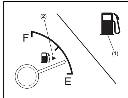
Este indicador le permite saber la cantidad aproximada de combustible en el tanque de combustible. “F” (FULL) significa lleno y “E” (EMPTY) vacío.
