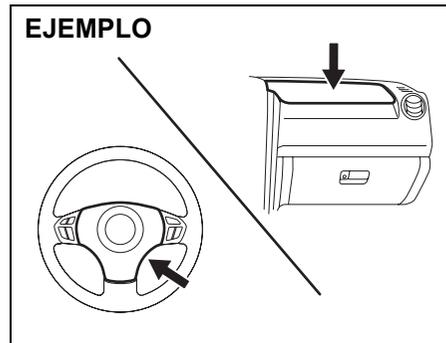
La bolsa de aire delantera del conductor se encuentra ubicada detrás de la almohadilla central del volante de dirección, y la bolsa de aire delantera del pasajero delan-
