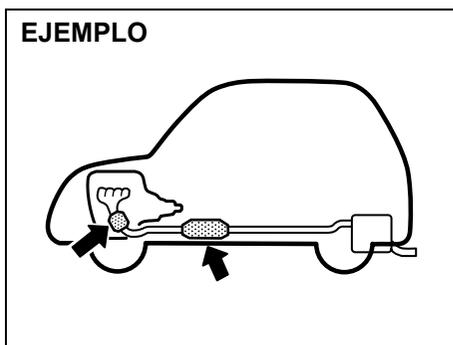
El convertidor catalítico tiene por objeto reducir al mínimo la cantidad de contaminantes nocivos del escape de su vehículo. El uso de combustibles con plomo en los vehículos con convertidor catalítico se encuentra prohibido por la ley Federal, debido a que el plomo desactiva los componentes reductores de contaminantes del sistema del catalizador.
