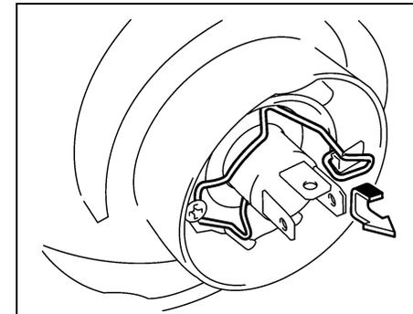
Abra el capó. Desconecte el acoplador. Retire la goma de sellado.
