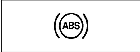
Cuando se gira el interruptor de encendido a la posición "ON", la luz se enciende brevemente para que pueda comprobar que la misma está funcionando.
