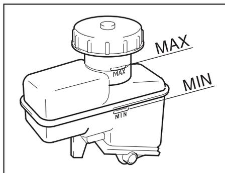
De vez en cuando, revise el nivel del fluido del embrague y verifique que el pedal del embrague opere suavemente. Si cuando se pisa el pedal a fondo, se nota que hay arrastre del embrague, solicite una inspección a su distribuidor SUZUKI. Si el nivel del fluido del embrague está cerca de la línea "MIN" llene hasta la línea "MAX" con fluido para embragues SAE J1703 o DOT-3.
