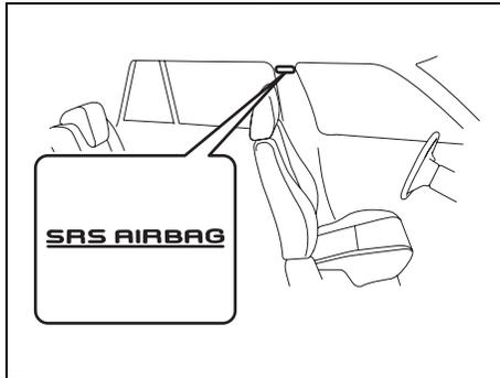
Las bolsas de aire tipo cortina laterales (de equiparse) se encuentran ubicadas en el revestimiento del techo. Las palabras "SRS AIRBAG" se encuentran moldeadas en el pilar para identificar la posición de las bolsas de aire tipo cortina laterales.
