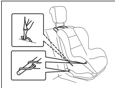
Su vehículo también se encuentra equipado con anclajes para la correa superior. (Para los detalles, refiérase a "Instalación del sistema de seguridad para niños con correa superior".) Asegúrese de usar la correa superior del sistema de seguridad para niños de acuerdo con las instrucciones del fabricante entregadas junto con el sistema de seguridad para niños.
