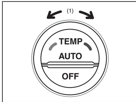
Gire el selector de temperatura (1) para ajustar la temperatura.
