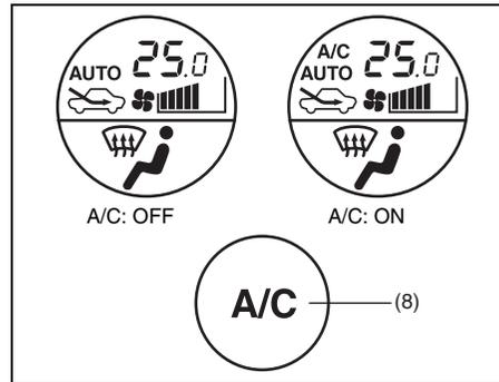
El interruptor de acondicionador de aire (8) se utiliza para encender o apagar el sistema de acondicionador de aire. Para activar el sistema de acondicionador de aire, presione el interruptor; entonces, la luz indicadora de "A/C" aparecerá en la pantalla LCD. Para desactivar el sistema de acondicionador de aire, presione de nuevo el interruptor y "A/C" se apagará.
