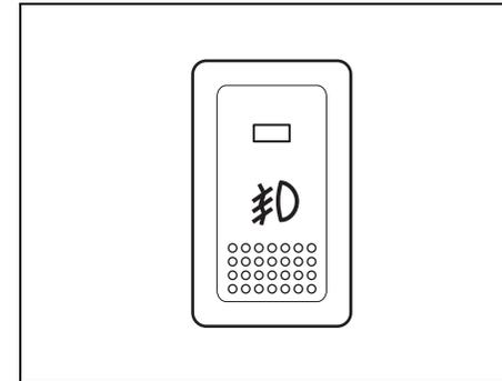
El faro antiniebla delantero se enciende al presionar el interruptor del faro antiniebla, con las luces de posición, luces traseras y/o faros delanteros encendidos. Cuando se enciende el foco antiniebla delantero, se enciende una luz indicadora encima del interruptor.
