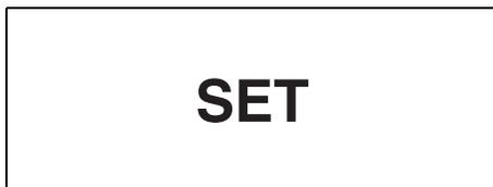
Cuando la velocidad del vehículo esté controlada mediante el sistema de control de crucero, la luz indicadora "SET" se enciende en el tablero de instrumentos.
