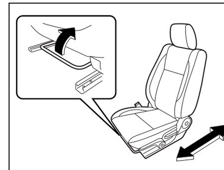
La palanca de ajuste de cada asiento delantero está ubicada debajo de la parte delantera del asiento. Para regular la posición del asiento, levante la palanca y deslice el asiento hacia adelante o atrás. Después del ajuste, trate de mover el asiento en sentido longitudinal para cerciorarse que ha quedado debidamente enclavado.
