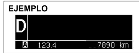
La pantalla (A) muestra la posición del selector de transmisión automática.
