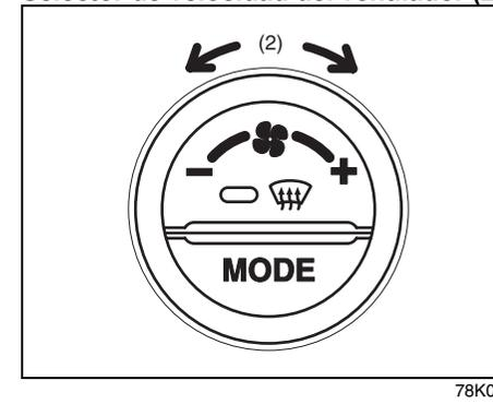
El selector (2) de velocidad del ventilador se utiliza para activar el ventilador y seleccionar la velocidad del ventilador.
