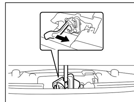
2) Con el dedo, empuje lateralmente la palanca de liberación provista debajo del capó como se observa en la ilustración. Mientras empuja la palanca, levante el capó.
