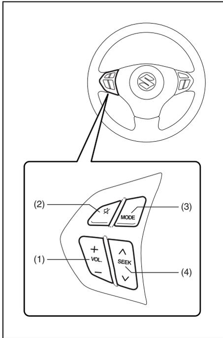
Las funciones básicas del sistema de audio pueden controlarse con los interruptores del volante de dirección.
