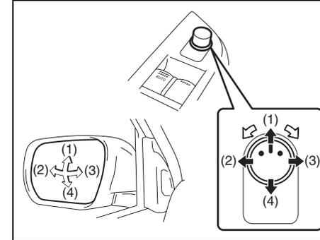
El interruptor para controlar los espejos eléctricos se encuentra ubicado en el panel de la puerta del conductor. Podrá controlar los espejos con la llave de encendido en la posición "ACC" u "ON". Para ajustar los espejos:
