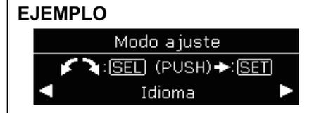
Con el interruptor de encendido en la posición "ON" y el vehículo detenido, presione y mantenga presionada la perilla MODE/ILL (2) durante más de 3 segundos para ingresar en el modo de ajuste de la pantalla de información
