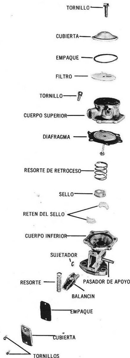
Vista esquemática de los componentes de la bomba de combustible. (Típicos de todos los modelos.)
