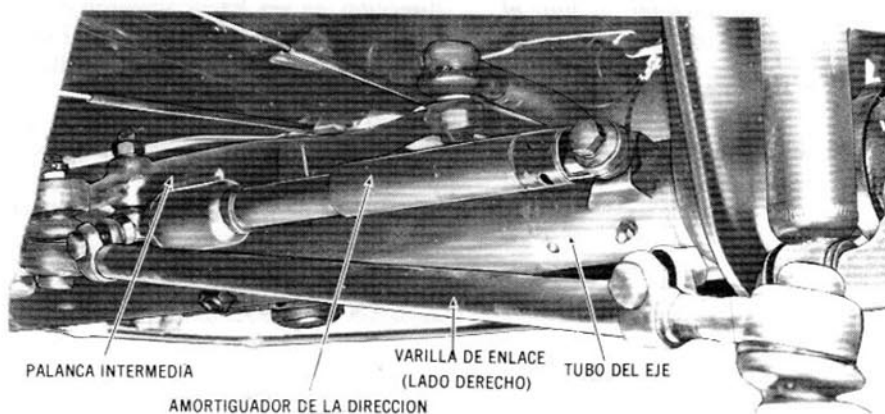
Conjunto de varillaje de la dirección, amortiguador y palanca intermedia
