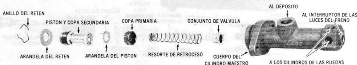
Componentes del cilindro maestro de tipo de circuito sencillo
