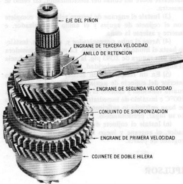
El juego axial del engrane de tercera velocidad se ajusta seleccionando anillos de retención y deberá estar entre .004 plg y .010 plg
