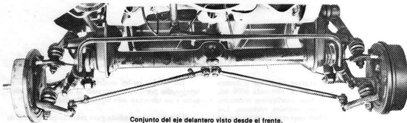
Conjunto del eje delantero visto desde el frente. (Mostrando rótula tipo giratorio.)
