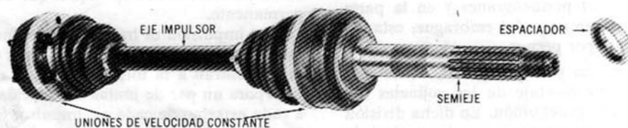
Conjunto del eje impulsor y semieje
