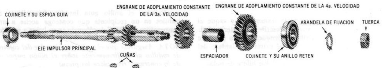
Vista esquemática de los componentes del eje impulsor principal (entrada)
