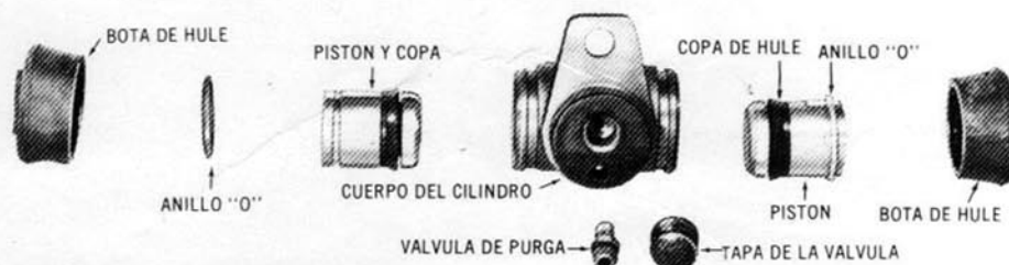
Vista de los componentes del cilindro de la rueda trasera
