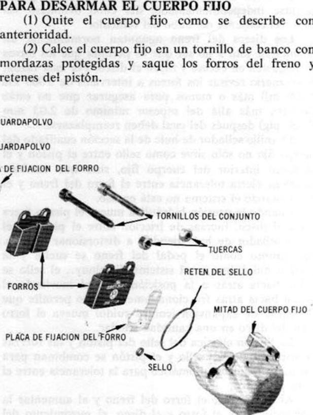
Vista de los componentes del cuerpo fijo del freno de disco
