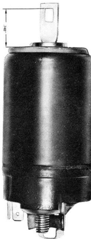
Tamaño del ajuste del balancín del solenoide con el émbolo acoplado
