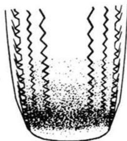
Desgaste en el centro del dibujo debido a inflado excesivo
