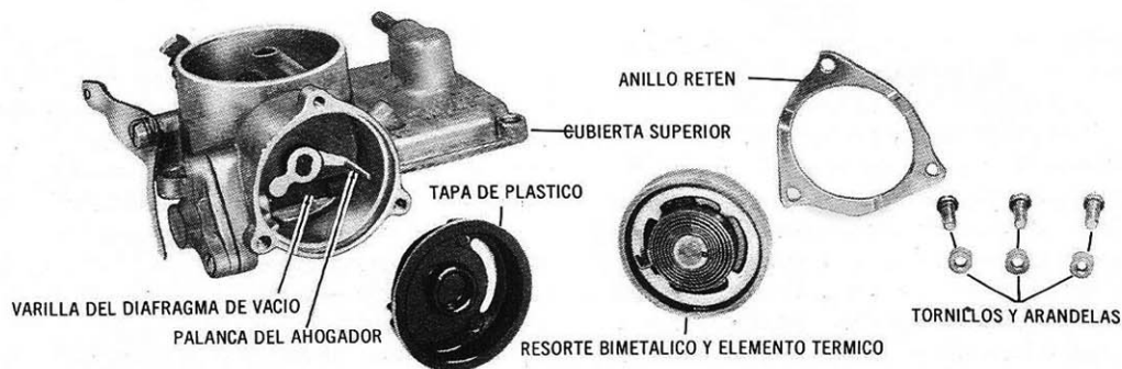
Componentes del ahogador automático del carburador 30 PICT-2
