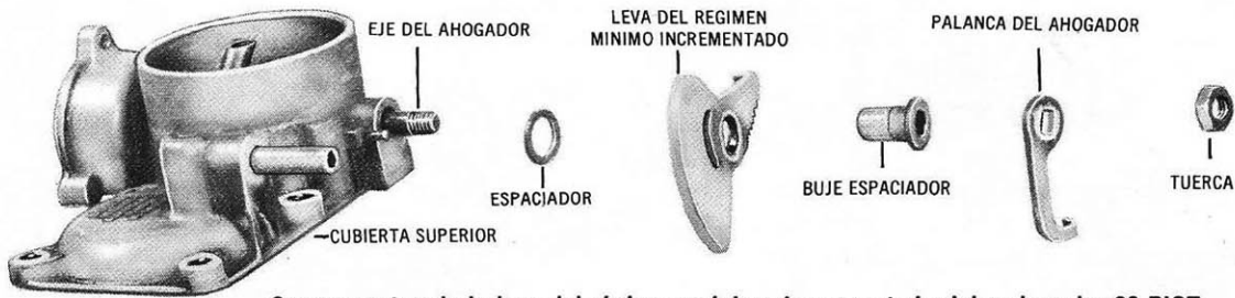
Componentes de la leva del régimen mínimo incrementado del carburador 28 PICT
