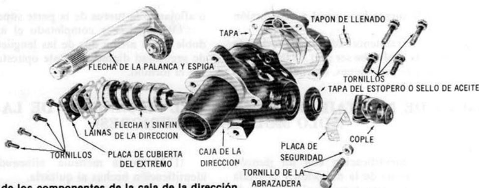
Vista de los componentes de la caja de la dirección
