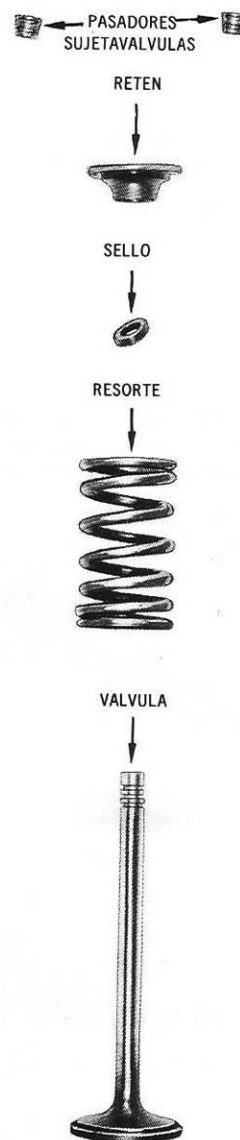
Componentes de la válvula y el resorte
