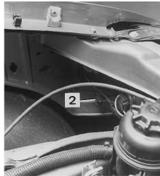
ILUMINACION. Vista de los puntos de reglaje de los faros (foto ETA). 1: Reglaje horizontal - 2: Reglaje vertical.
