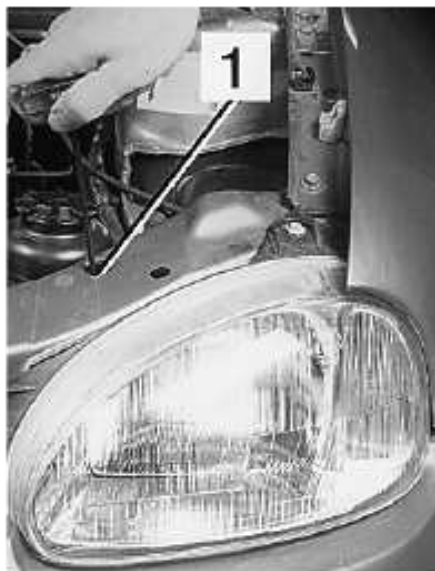
ILUMINACION. Vista de los puntos de reglaje de los faros (foto ETA). 1: Reglaje horizontal - 2: Reglaje vertical.
