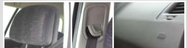
Apoyacabezas delanteros regulables en profundidad y cinturón regulable en altura. Airbags delanteros adaptativos.
