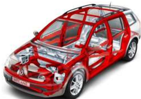
La primera zona de deformación delantera está compuesta por un paragolpes plástico del tipo envolvente con un absorbedor del mismo material en su parte interna y de un alma de aluminio sujeta a dos crash box atornillados a ambos largueros. Para completar este tren amortiguador de impactos, posee un frente del tipo híbrido y los dos guardabarros de material plástico.
