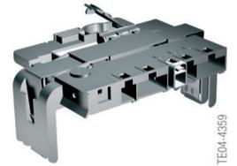
El distribuidor de corriente del maletero consta de un paquete de fusibles y solo puede sustituirse como pieza completa.
