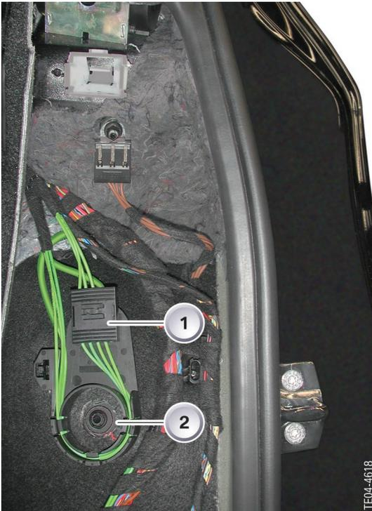
2 - Lugar de montaje del conector de fibra óptica
