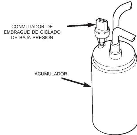
Fig. 7 Conmutador de embrague de ciclado de baja presión - Característico
