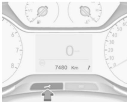
Un próximo servicio necesario se muestra en el Centro de información del conductor durante siete segundos después de conectar el encendido.
