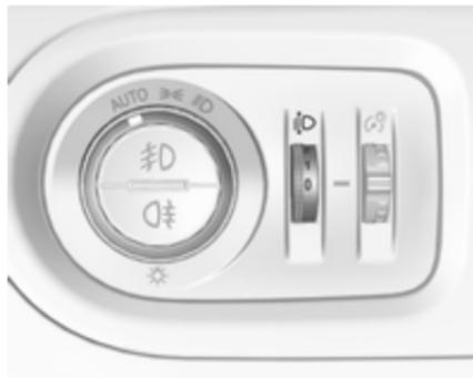
Para adaptar el alcance de los faros a la carga del vehículo y evitar el deslumbramiento: gire la rueda de ajuste
