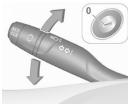
Cuando el vehículo está aparcado, se pueden activar las luces de estacionamiento de un lado:
