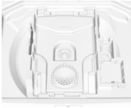
La argolla de remolcado y los calzos se encuentran en una caja debajo de la cubierta del piso en el compartimento de carga.
