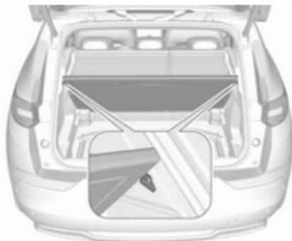
Para sujetar la cubierta del compartimento de carga en posición vertical, levántela por encima de los topes retráctiles.
