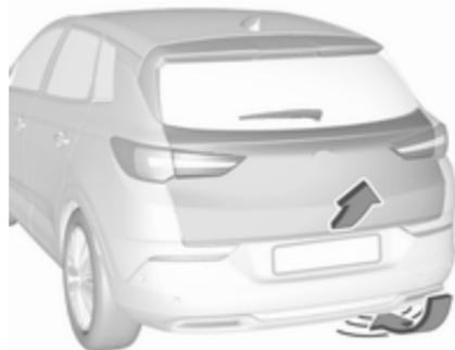
Para abrir o cerrar el portón trasero, mueva hacia delante y hacia atrás el pie debajo del parachoques trasero en la zona debajo de la matrícula (véase la ilustración). La llave debe encontrarse dentro de un alcance de un metro. Si está equipado con asistente de aparcamiento, se puede reconocer la zona debajo del sensor que se muestra. No mantenga el pie mucho tiempo debajo del parachoques ni tampoco lo mueva lentamente. La llave electrónica debe
