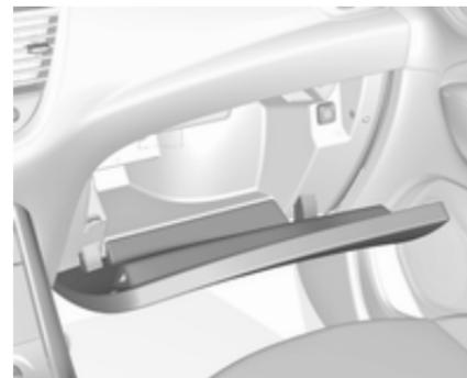
En algunas versiones, la guantera está ventilada. La ventilación de aire y la temperatura dependen de la configuración del sistema de climatización. La salida de aire de la guantera se puede cerrar ⇨ 142.
