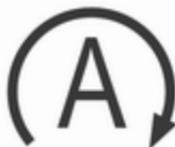
Una parada automática se indica mediante el testigo de control (A).
