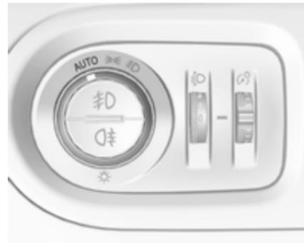
Cuando está conectada la función de control automático de las luces y el motor está en marcha, el sistema cambia entre luces de circulación diurna y conexión automática de los
