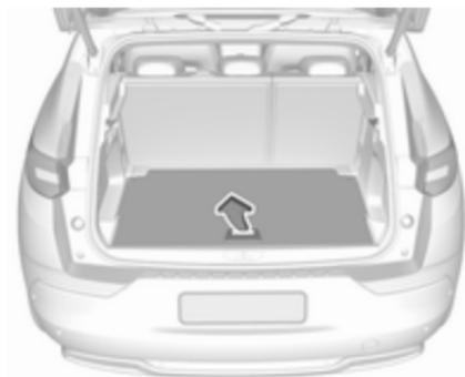
Para desmontar, pulse la manilla para desbloquear el piso de carga y levántelo con ayuda de la manilla.
