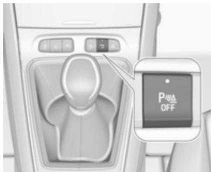
El sistema está preparado para funcionar cuando el LED del botón del asistente de aparcamiento
