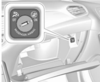
El sistema de airbags del acompañante se puede desactivar mediante un interruptor accionado con la llave en el interior de la guantera.
