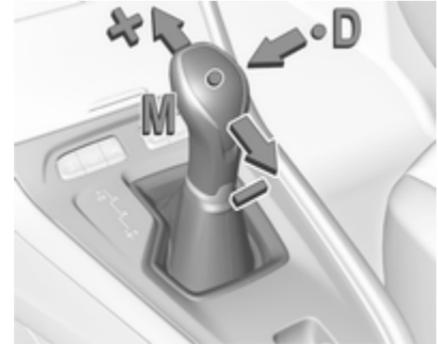
Saque la palanca selectora de la posición **D** hacia la izquierda en posición **M**.
