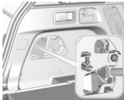
2. Afloje la tuerca de fijación de la lámpara con una llave fija o de vaso.
