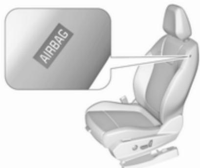
El sistema de airbag lateral consta de un airbag en cada uno de los respaldos de los asientos delanteros y traseros exteriores. Se pueden identificar por el rótulo **AIRBAG**.
