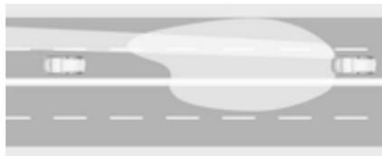
El asistente de luz de carretera incluye un modo especial de autovía. Al conducir a una velocidad superior a 115 km/h por autovías, la luz de carretera se hace más pequeña para evitar deslumbrar al tráfico que viene en dirección contraria. Al adelantar o seguir a vehículos que se encuentran delante, se reduce el deslumbramiento en el espejo de estos vehículos.
