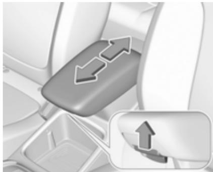
El reposabrazos se puede deslizar hacia delante 10 cm. Tire del asidero para deslizar el reposabrazos. Debajo del reposabrazos hay un compartimento portaobjetos.
