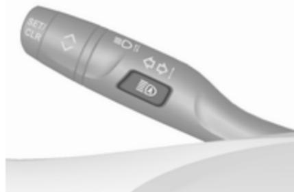
Active el asistente de luz de carretera pulsando
