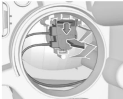
2. Presione la pinza de retención hacia abajo y tire del portalámparas hacia atrás.
