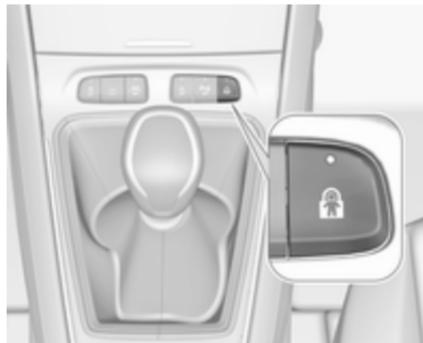
Sistema de accionamiento remoto para impedir la apertura de las puertas traseras con sus mandos interiores y el uso de los elevavidrios eléctricos traseros. El mando está situado en la consola central, delante de la palanca selectora.
