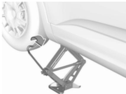
Acople la llave para ruedas y, con el gato correctamente alineado, gire la llave para ruedas hasta que la rueda se desprege del suelo.
