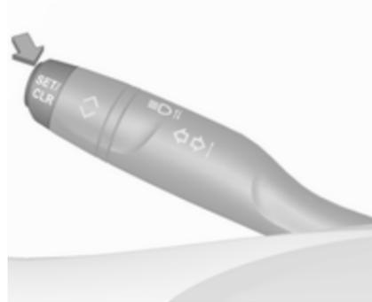
Pulse **SET/CLR** en la palanca de intermitentes para confirmar un mensaje.
