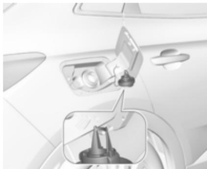
El tapón del depósito de combustible se puede fijar al gancho de la tapa del depósito.
