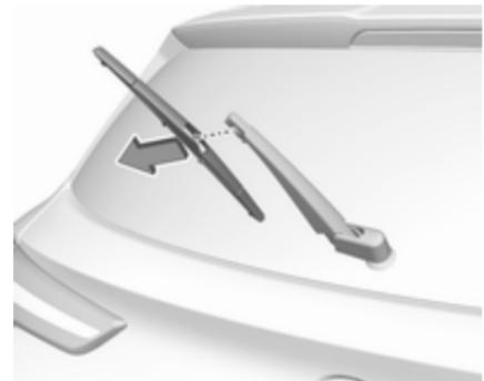
Levante el brazo del limpiaparabrisas. Desacople la escobilla del limpiaparabrisas tal y como se indica en la ilustración y desmóntela.
