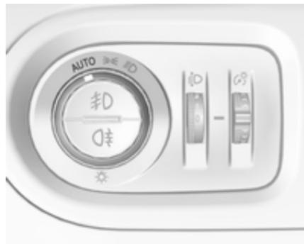
El asistente de luz de carretera solo se puede activar con el conmutador de las luces en posición **AUTO**.
