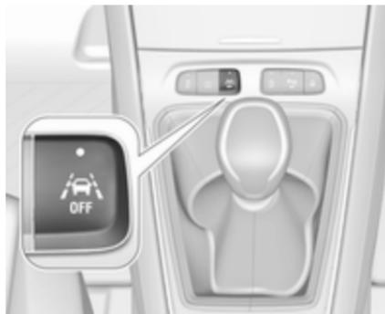
Después de activar el encendido, se activa el asistente de mantenimiento de carril. Si el sistema está activado, el LED del botón
