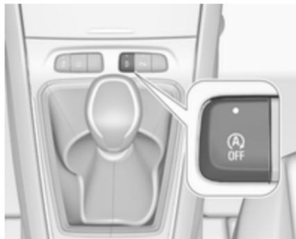
Desactive manualmente el sistema stop-start pulsando . Para indicar la desactivación, se ilumina el LED del botón.
