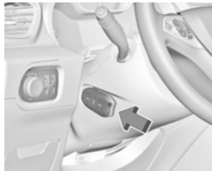
Mantenga la llave electrónica con botones fuera en las marcas de la cubierta de la columna de dirección como se muestra en la ilustración.
