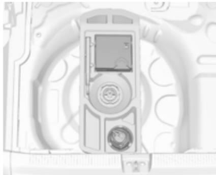
El juego de reparación de neumáticos se encuentra en el compartimento de carga, debajo de la cubierta del piso.
