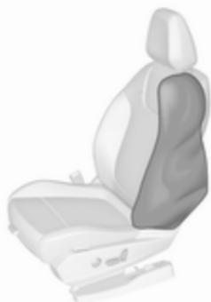
Los airbags inflados atenúan el impacto y reducen, por tanto, el riesgo de lesiones en la parte superior del cuerpo y la pelvis en el caso de que haya una colisión lateral fuerte.
