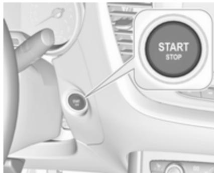
**Cambio manual:** accione el pedal del embrague y el freno.
