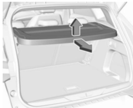
Levante la cubierta por la parte trasera y empujela hacia arriba por la parte delantera.
