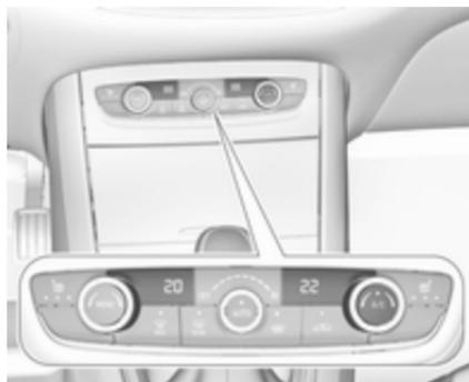
Pulse **A/C** para activar la refrigeración. El LED del botón se ilumina para indicar su activación. La refrigeración sólo funciona con el motor en marcha y el ventilador de climatización conectado.
