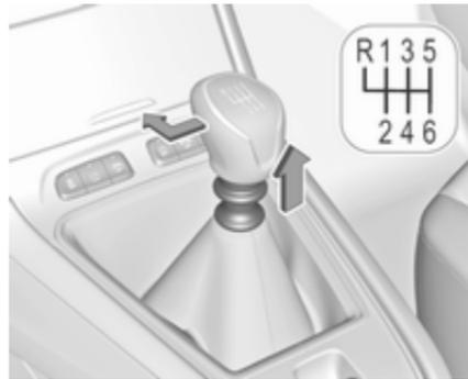
Para acoplar la marcha atrás en la transmisión de 6 velocidades, pise el pedal del embrague, tire de la anilla situada bajo la palanca selectora y mueva la palanca selectora bastante a la izquierda y hacia delante.
