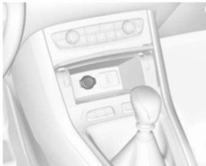
Hay una toma de corriente de 12 V situada detrás de la cubierta del portaobjetos, debajo de los mandos de climatización. Pulse la tapa para abrirla.
