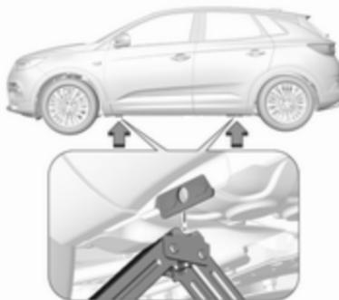
3. Asegúrese de que el gato está bien colocado en el punto de elevación correspondiente del vehículo.
