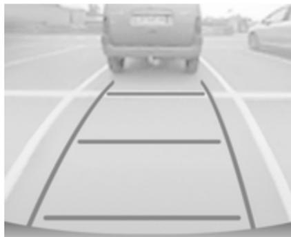
El área detrás del vehículo se muestra en la pantalla. Las líneas verticales representan el ancho del vehículo con los espejos retrovisores desplegados. La dirección de las líneas cambia con la posición del volante.
