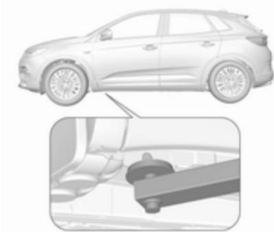
Posición del brazo delantero de la plataforma de elevación centrada debajo del punto de elevación con gato del vehículo correspondiente.
