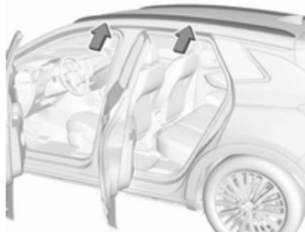
Fije el portaequipajes de techo en el raíl del techo encima de los puntos de montaje situados en cada marco de la puerta de la carrocería del vehículo.
