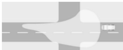
Se activa automáticamente a una velocidad de hasta aproximadamente 55 km/h y en situaciones con luz ambiente exterior. La luz es amplia y simétrica. Si la velocidad es inferior a 30 mph, los faros se giran ligeramente hacia el exterior para poder reconocer antes a los peatones y objetos en cada lado de la carretera. Se ha diseñado un patrón de haz especial para evitar el reflejo a otros usuarios de la carretera.
