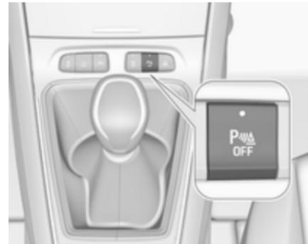
El sistema se desactiva al desengranar la marcha atrás. Pulse
