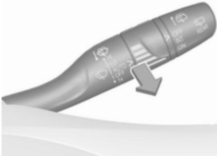
Tire de la palanca. Se pulveriza líquido de lavado sobre el parabrisas y el limpiaventana se realiza el barrido varias veces.
