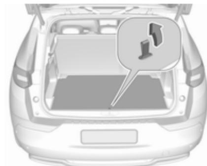
La cubierta del suelo trasero se puede levantar y retirar. Eleve la tapa con el lazo y retire.
