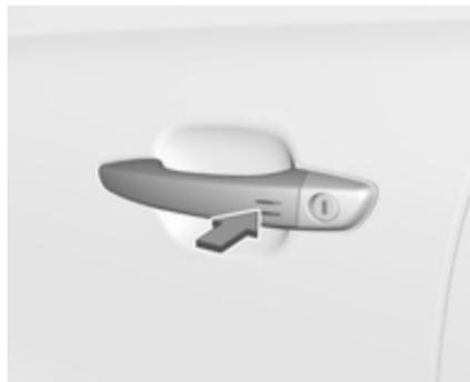
Sistema de llave electrónica: Si se desbloquea el vehículo pulsando una de las manillas de la puerta delantera en las marcas se desactiva el sistema de alarma antirrobo.
