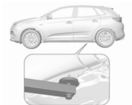
Posición del brazo trasero de la plataforma de elevación centrada debajo del punto de elevación con gato del vehículo correspondiente.
