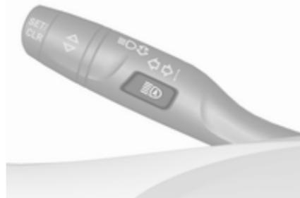
Active el asistente de luz de carretera pulsando
