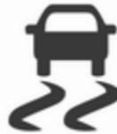
El control electrónico de estabilidad y el control de tracción están operativos cada vez que arranca el motor en cuanto se apaga el testigo de control
