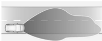
Se activa automáticamente a una velocidad superior a 115 km/h. La iluminación se adapta a la velocidad superior de conducción por autopistas. Si no hay tráfico de frente, se incrementa la visibilidad en el lateral del
