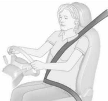
Al acelerar o frenar bruscamente el vehículo, los cinturones de seguridad se bloquean para sujetar a los ocupantes en la posición del asiento. Por lo tanto, se reduce considerablemente el riesgo de lesiones.
