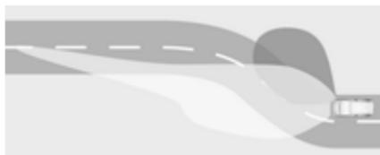
Adicionalmente se activan LED determinados, según el ángulo de dirección y la velocidad, para mejorar la iluminación en curvas. Esta función se activa a velocidades de 40 km/h a 70 km/h y reacciona al ángulo de dirección.
