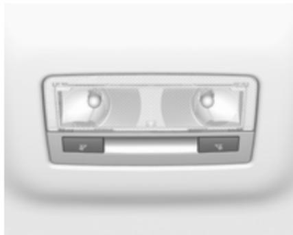
La ilustración muestra las luces de cortesía traseras.
