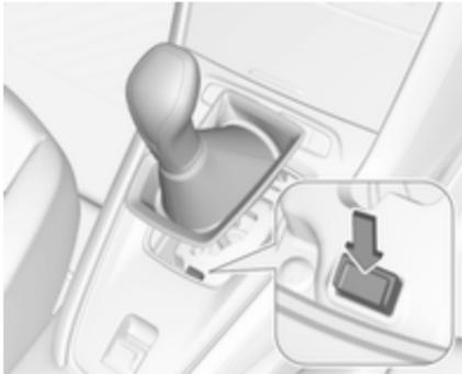
3. Presione el botón y saque la palanca selectora de **P**. Haga subsanar la causa de la interrupción de corriente en un taller.
