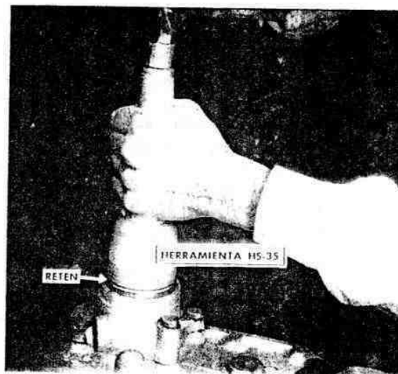
Fig. 178. — Instalando el retén de aceite en la extensión trasera, con la herramienta HS-35.
