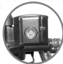
Imagen 12. Nivel del líquido de freno delantero.
