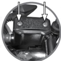
Imagen 13. Completar el nivel del líquido de freno.
