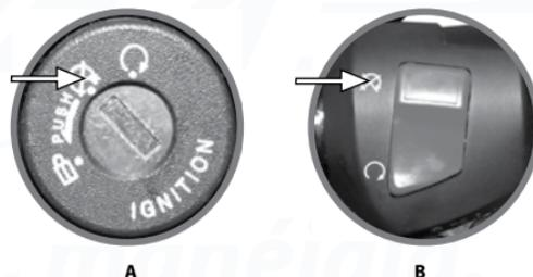
Imagen 34. Apagado de motor.
