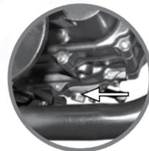
Imagen 3. Ubicación del tornillo de drenado.
