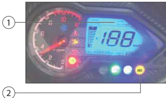
1. **Indicador de batería baja** : Indica que la batería necesita recargarse.
