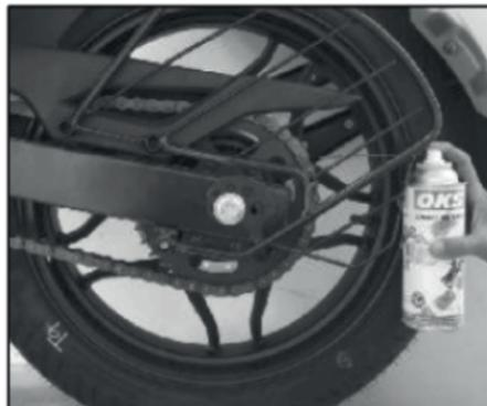
Método para lubricar cadena con O´ring
