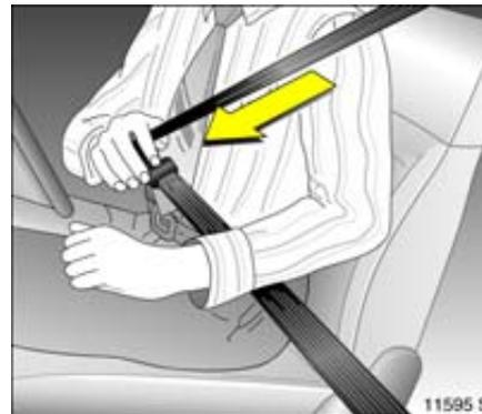
3. Tire suavemente de la hebilla deslizante hacia afuera del dispositivo de retroceso y ajuste el cinturón de seguridad sobre el cuerpo sin torcerlo.
