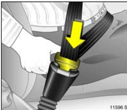
4. Encaje la hebilla del cinturón de seguridad en el pestillo, hasta que se oiga un estallido característico de trabamiento.
