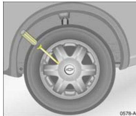
6. (Rueda de aluminio) Quite el tapacubos central con el auxilio de un destornillador.
