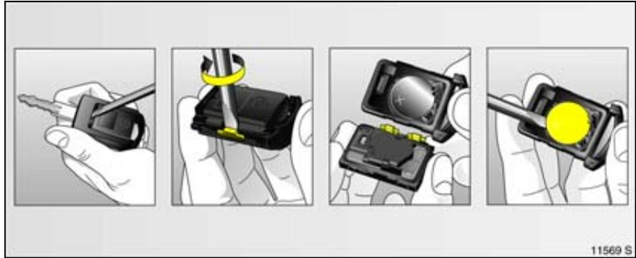
**Reemplazo de la pila de la unidad del mando a distancia**
