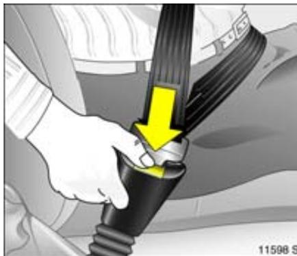
6. Para liberar el cinturón de seguridad, oprima el botón en el pestillo. El cinturón se recogerá automáticamente.
