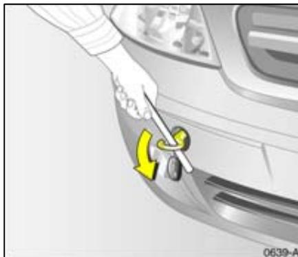
Atornille el gancho de remolque, girándolo en el sentido antihorario con la ayuda de un destornillador. Apriételo firmemente hasta la posición horizontal.
