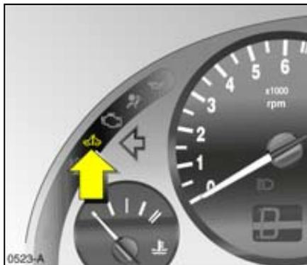
Cuando se conecte el encendido, el indicador de control del sistema inmovilizador A se enciende brevemente. En caso de que quede destellando con el encendido desconectado, habrá algún defecto en el sistema. No será posible hacer partir el motor.
