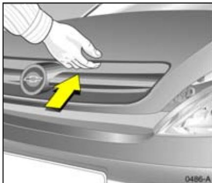
Para abrir completamente, levante el pestillo de seguridad, ubicado a la derecha, visto por la parte delantera del vehículo.
