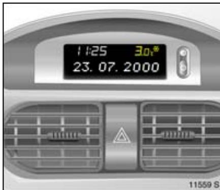
En caso de que solamente se vaya a ajustar la hora, pase al modo de ajuste y presione  $\odot$  hasta que las horas y minutos empiecen a destellar.
