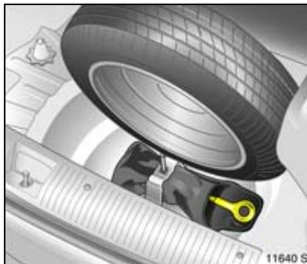
El gancho de remolque está ubicado en un bolso junto con las herramientas del vehículo en el compartimiento de equipajes, debajo de la rueda de repuesto.
