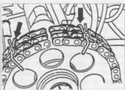
Enganchar la cadena con el alambre antes de amolar los ejes de un eslabón.
