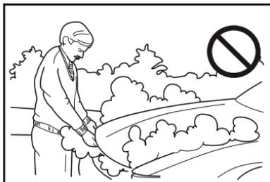
Si usted ve o escucha vapor procedente del motor, detenga y apague el motor. No abra el capó hasta que el motor se haya enfriado.
