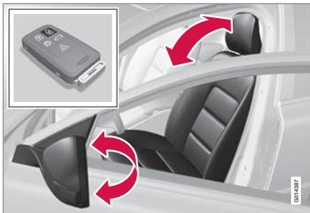
Cuando se abre el vehículo con la misma llave a distancia y se abre la puerta del conductor, el asiento del conductor y los retrovisores exteriores adoptan automáticamente los ajustes almacenados en la memoria de la llave.
