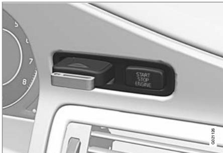
Cerradura de contacto con mando a distancia introducido y botón **START/STOP ENGINE**.
