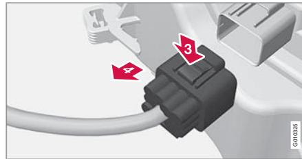
Todas las bombillas delanteras (a excepción de las de las luces antiniebla) se cambian desconectando y sacando el portalámparas desde el compartimento del motor.
