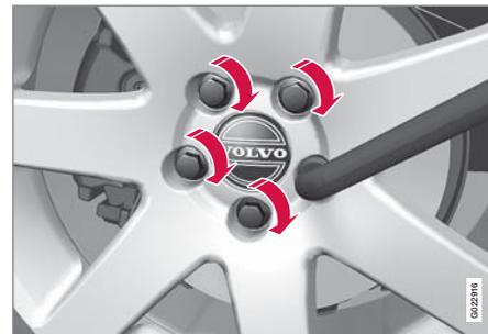
4. Apriete los tornillos de rueda por pares cruzados. Es importante que los tornillos de rueda queden debidamente apretados. Apriete a 140 Nm. Compruebe el par de apriete con una llave dinamométrica.
