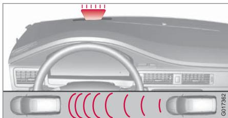
Una pequeña parte de la lámpara de advertencia roja del parabrisas se enciende con luz continua si la distancia de seguridad es inferior al intervalo de tiempo programado.
