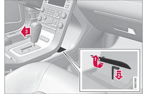
Si el automóvil no está en condiciones para conducirse, por ejemplo, si la batería de arranque está descargada, la palanca de cambios debe sacarse de la posición **P**, para poder mover el automóvil.
