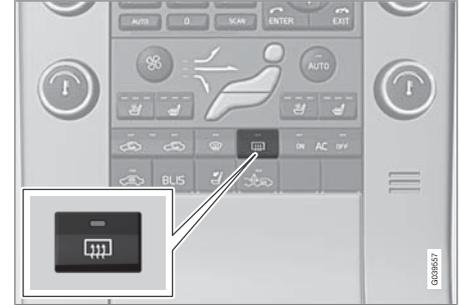
Utilice la calefacción eléctrica para eliminar la escarcha y la humedad de la luneta trasera y los retrovisores exteriores.
