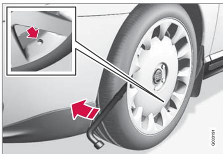
4. (Automóviles con llantas de acero). Suelte el tapacubos con la llave para tornillos de rueda o despréndalo con la mano.
