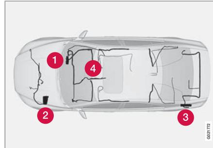
Si el automóvil tiene el volante a la derecha, las cajas situadas debajo de la guantera y en la consola central cambian de lado.
