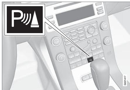
El sistema se conecta automáticamente al arrancar el automóvil y se enciende la luz de Conexión/Desconexión del interruptor. Si se desconecta el control de distancia de aparcamiento con el botón, la luz se apaga.
