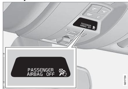
*Indicación en la consola del techo que muestra que el airbag del acompañante está desconectado.*
