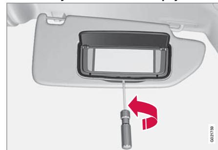
1. Introduzca un destornillador por debajo del borde inferior en la parte central y abra con cuidado el enganche haciendo palanca.
