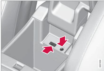
Para conectar un iPod® o un reproductor de mp3 al sistema de información y entretenimiento del automóvil, utilice la conexión USB\* o la entrada AUX de la consola central.
