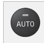
La función regula automáticamente la temperatura, el aire acondicionado, la velocidad del ventilador, la recirculación y la distribución del aire.
