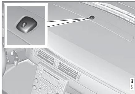
El tablero de instrumentos tiene un diodo luminoso rojo que indica el estatus del sistema de alarma:
