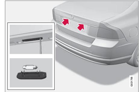
1. Suelte los tornillos con un destornillador.
