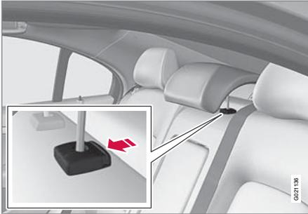
El reposacabezas se regula en altura según la altura del pasajero. El borde superior se adapta a la mitad de la nuca. Suba el reposacabezas según sea necesario.
