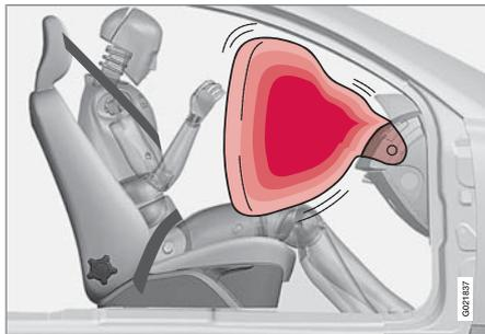
Como complemento del cinturón de seguridad, el automóvil está equipado con un airbag que está plegado en un compartimento encima
