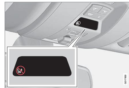
*Indicación en la consola del techo que muestra que el airbag del acompañante está conectado.*
