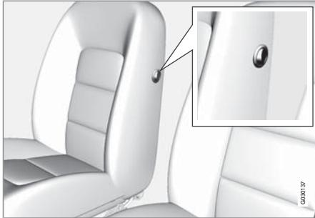
El asiento del acompañante puede ajustarse en profundidad. El asiento se desplaza hacia adelante o hacia atrás al pulsar la sección delantera o la sección trasera del botón. No se modifica la inclinación del respaldo.
