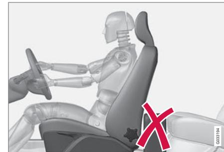
No coloque objetos en el piso detrás del asiento del conductor o del acompañante.
