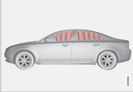
El airbag de techo lateral IC (Inflatable Curtain) es un complemento de los demás sistemas SIPS y SRS. El sistema IC está instalado a lo largo de ambos lados del techo interior y protege a los ocupantes de las plazas laterales. En caso de una colisión de suficiente intensidad, los sensores reaccionan y el airbag de techo lateral se infla. La cortina inflable contribuye a impedir que conductor y los acompañantes golpeen la cabeza contra el interior del automóvil al producirse una colisión.
