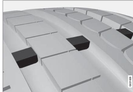
El indicador de desgaste es un realce estrecho que atraviesa la banda de rodadura. En el lateral del neumático pueden verse las letras **TWI** (Tread Wear Indicator). Cuando el desgaste del neumático llega a 1,6 mm, la profundidad del dibujo está al mismo nivel que los indicadores de desgaste. Cambie en tal caso los neumáticos en cuanto sea posible. Tenga en cuenta que los neumáticos con dibujos de escasa profundidad presentan una adherencia muy deficiente en condiciones de lluvia o nieve.
