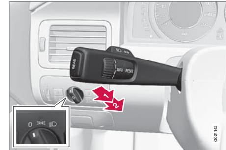
Mando de las luces y palanca del volante.
