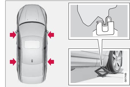
Coloque el triángulo de peligro en la calzada ver la página 223 si cambia una rueda en un lugar transitado. El automóvil y el gato\* deben estar sobre una superficie firme y horizontal.
