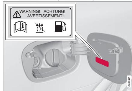
Cuando la temperatura exterior es elevada, puede producirse una ligera sobrepresión en el depósito. En este caso, abra la tapa lentamente.
