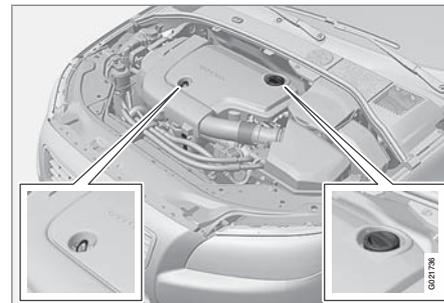
Varilla de nivel, motores diesel. (El D5 Euro5 tiene una varilla de nivel electrónica.)
