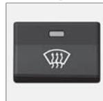
Se utiliza para eliminar rápidamente el vaho y el hielo del parabrisas y las ventanillas laterales. El aire se envía hacia las ventanillas. Cuando la función está conectada, se enciende la luz del botón del
