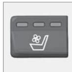
La opción de asientos ventilados solo es posible cuando el automóvil está equipado con ECC. El sistema de ventilación está compuesto de ventiladores en los asientos y los respaldos que aspiran aire por el tapizado del asiento. El efecto de refrigeración aumenta cuanto más frío esté el aire del habitáculo.
