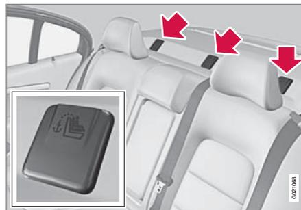
El automóvil está equipado con puntos de fijación superiores para asientos infantiles. Estos puntos de fijación están situados en la bandeja trasera y se ocultan con tapas de plástico.
