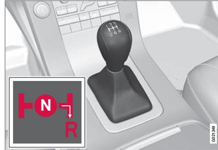
El inhibidor de marcha atrás dificulta la posibilidad de introducir por error la marcha atrás al circular de manera normal hacia adelante.
