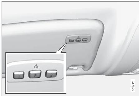
HomeLink® es un mando a distancia programable que puede controlar hasta tres dispositivos diferentes (por ejemplo, la puerta del garaje, el sistema de alarma, la iluminación exterior e interior, etc.) y utilizarse por tanto en lugar de los mandos a distancia correspondientes. El HomeLink se suministra integrado en la visera izquierda.
