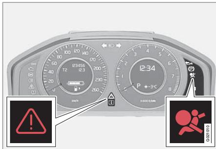
El sistema airbag es objeto de una supervisión constante por parte de la unidad de mando del sistema. El símbolo de advertencia en el instrumento combinado se enciende con la llave en la posición **II** o **III**. El símbolo se apaga después de 6 segundos si el sistema de airbags no tiene averías.
