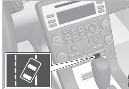
La función se conecta y desconecta con un interruptor situado en la consola central. La luz del botón se enciende cuando la función está conectada.
