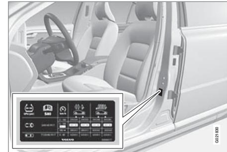
La placa de presiones de neumáticos situada en el montante del lado del conductor (entre las puertas delantera y trasera) especifica la presión que deben tener los neumáticos en diferentes condiciones de carga y velocidad. Esos datos también están indicados en la tabla de presiones de neumáticos, véase a continuación.
