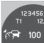
Cuando el sensor del radar detecta otro vehículo, se enciende en el lado izquierdo de la pantalla el símbolo de un automóvil. La distancia de seguridad solo se regula cuando está encendido el
