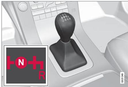
El inhibidor de marcha atrás dificulta la posibilidad de introducir por error la marcha atrás al circular de manera normal hacia adelante.
