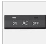
Cuando se enciende la luz **ON**, el sistema regula automáticamente el aire acondicionado. De esta manera, el aire entrante se enfría y deshumedece lo suficiente.
