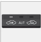
El sistema de calidad de aire separa gases y partículas para reducir la concentración de olores y contaminaciones. Si el aire exterior está contaminado, se cierra la toma de aire y el aire recircula. Cuando está pulsado el botón **AUTO**, el sensor de calidad de aire está siempre conectado.
