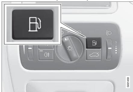
Abra la tapa del depósito con el botón del panel de las luces. La tapa del depósito está colocada en la aleta trasera derecha, de lo cual le avisa la flecha del símbolo
