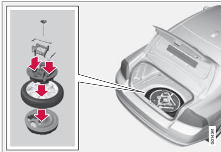
Las herramientas están en un taco de espuma. Las herramientas están compuestas por la anilla de remolque, el gato\* y la llave para tornillos de rueda\*. El taco de espuma está atornillado
