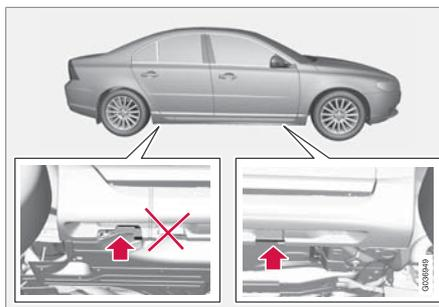
Si el automóvil se eleva con un gato de taller, éste debe apoyar la parte delantera del bastidor portante del motor.
