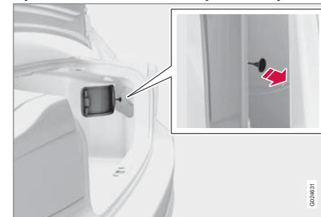
La tapa del depósito puede abrirse manualmente cuando no sea posible abrirlo por vía eléctrica en el habitáculo.
