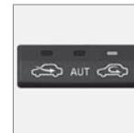
Cuando está conectada la recirculación, se enciende la luz de color naranja del botón. La función se selecciona para impedir la entrada de aire contaminado, gases de escape etc. en el habitáculo.
