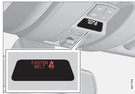
El sistema avisa de los que no se han abrochado cinturón de seguridad con señales acústicas y luminosas. El aviso acústico depende de la velocidad y, en algunos casos, del tiempo. La señal luminosa puede verse en la consola del techo y en el instrumento combinado.
