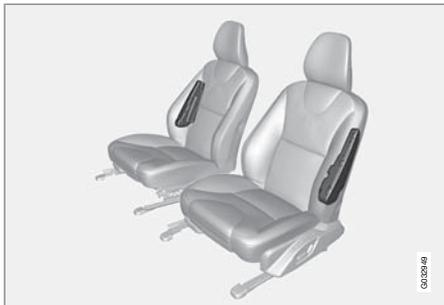
En una colisión lateral, el sistema SIPS (Side Impact Protection System) distribuye una gran parte de la fuerza de colisión a los largueros, los montantes, el piso, el techo y otros componentes de la carrocería. Los airbags laterales, situados junto a las plazas del conductor y la del acompañante, protegen el pecho y las caderas y son una parte importante del sistema SIPS.
