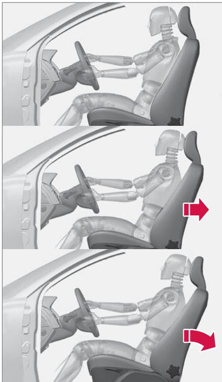
El sistema WHIPS (Whiplash Protection System) consta de respaldos que absorben la energía de un impacto y reposacabezas adaptados al sistema en los asientos delanteros. El sistema se activa durante una colisión por alcance en función del ángulo de incidencia, la velocidad y las características del vehículo con el que se choca.
