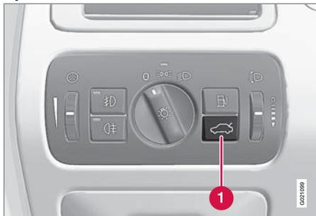
Pulse el botón del panel de las luces **1** para desbloquear el maletero.
