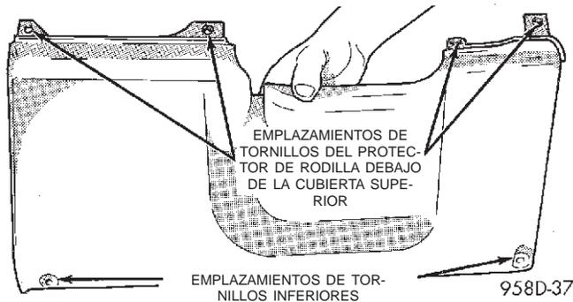
**Fig. 54** Puntos de fijación del protector de rodilla
