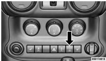
Interruptor STOP/START Off (Arranque/parada desconectado)
