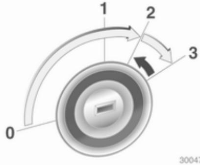
Accione el embrague y el freno, cambio automático en **P** o **N**
