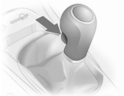
Marcha atrás: con el vehículo parado, espere 3 segundos después de pisar el pedal de embrague, apriete el botón de la palanca y engrane la marcha.
