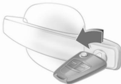
Gire hasta el tope la llave en la cerradura de la puerta del conductor. Al abrir la puerta del conductor, se desbloquea todo el vehículo. Para abrir las otras puertas, conecte el encendido y pulse el botón del cierre centralizado.
