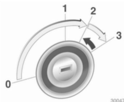
Gire la llave a la posición 1. Mueva ligeramente el volante para desactivar el bloqueo. Accione el embrague y el freno, cambio automático en **P** o **N**, no acelere; con motor diésel, gire la llave a la posición 2 para el precalentamiento y espere hasta que se apague el testigo de control ; gire la llave a la posición 3 y suelte la llave. Arranque del motor ⇨ 117.
