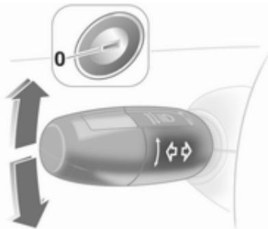
Cuando el vehículo está aparcado, se pueden activar las luces de estacionamiento de un lado:
