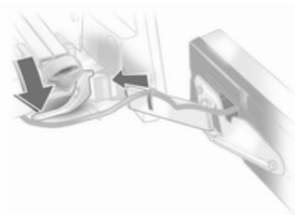
Baje la palanca de retención e inserte el soporte hasta el tope en el alojamiento.
