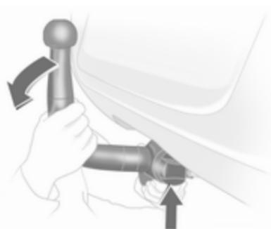
Inserte la barra de rótula tensada en la abertura y presione con fuerza hacia arriba, hasta que enclave de forma audible.
