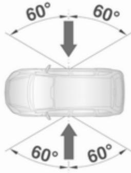
El sistema de airbags laterales se activa en caso de choque de una determinada gravedad en el sector indicado. El encendido debe estar conectado.
