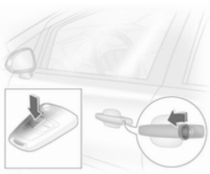
Para desbloquear las puertas y el compartimento de carga, gire hacia delante la llave en la cerradura de la puerta del conductor o pulse el botón
