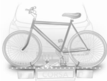
Ajuste los alojamientos para las ruedas de modo que la bicicleta quede en posición horizontal. La separación entre los pedales y el portón trasero debe ser de 5 cm como mínimo.
