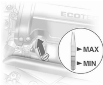
Se utilizan distintos tipos de varilla de medición del aceite, según el tipo de motor.
