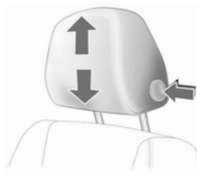
Pulse el botón de desbloqueo, ajuste la altura, enclave.
