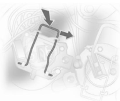
3. Desenclave el clip elástico de la sujeción moviéndolo y girándolo a un lado.
