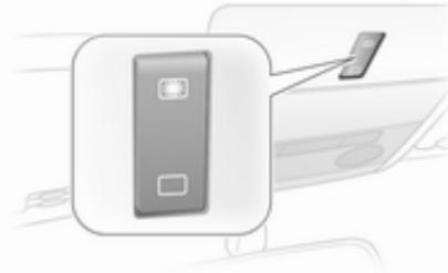
Se acciona mediante un interruptor basculante en la consola del techo.
