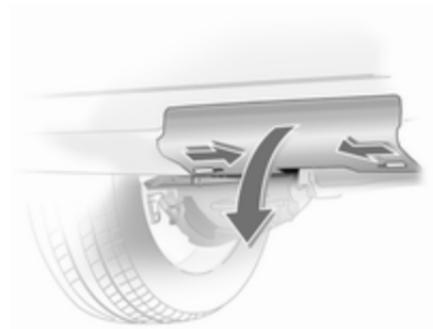
Comprima los dos pestillos hacia dentro y desmonte la tapa del compartimento de carga.
