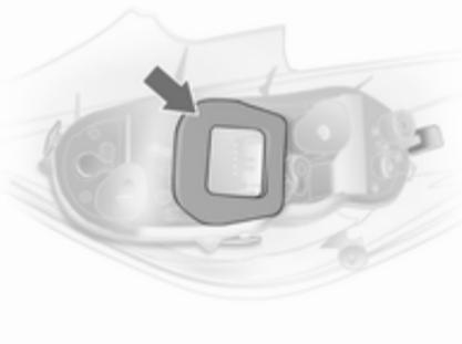
8. Asegúrese de que la junta del portalámparas esté colocada como en la ilustración. Coloque la junta redonda sobre el tornillo de fijación.
