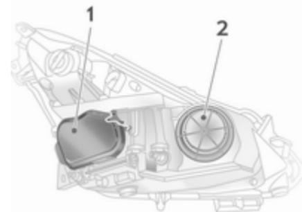
Los faros tienen sistemas independientes para la luz de carretera **1** (bombillas exteriores) y la luz de cruce **2** (bombillas interiores).
