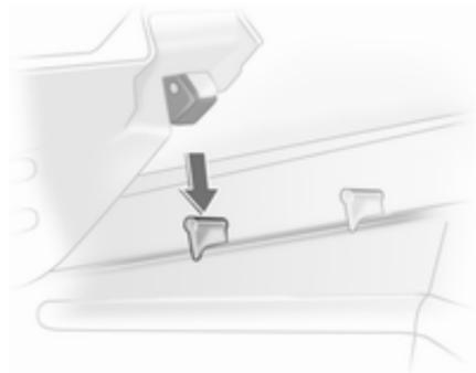
Para el desmontaje de los otros tres segmentos (orden del 2 al 4), se debe levantar el segmento por detrás, desenclavarlo, girarlo y sacarlo.
