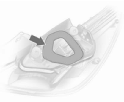
8. Asegúrese de que la junta del portalámparas esté colocada como en la ilustración.
