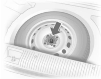
La rueda de repuesto está situada en el compartimento de carga, debajo de la cubierta del piso. Está fijada en el rebaje mediante una tuerca de mariposa.
