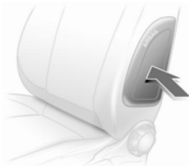
El sistema de airbags laterales se compone de un airbag en cada respaldo de los asientos delanteros
