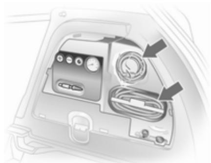
1. Saque el bote de sellador y el soporte con el tubo flexible de aire del suplemento.
