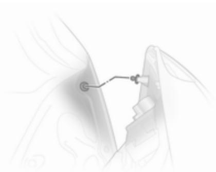
9. Inserte la caja en la carrocería del vehículo y apriete las tuercas de fijación a mano. Enchufe el conector. Cierre la tapa.
