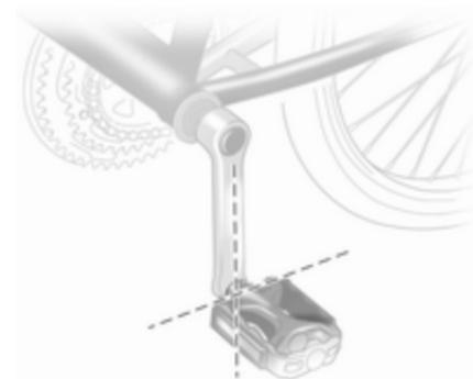
Coloque el pedal izquierdo (sin plato) en vertical hacia abajo. El pedal izquierdo debe quedar en posición horizontal.
