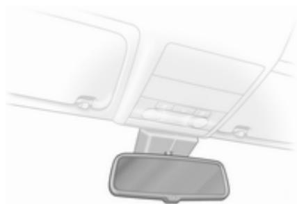
El deslumbramiento producido por los vehículos que nos siguen de noche se reduce automáticamente.
