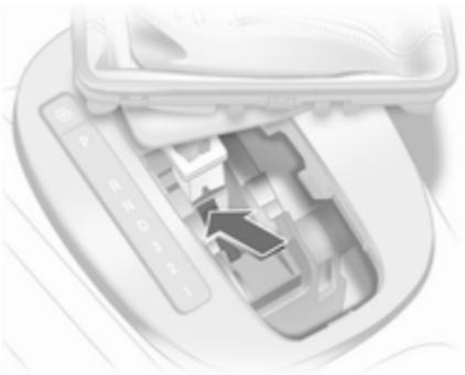
3. Con un destornillador, empuje el triquete amarillo hacia delante y saque la palanca selectora de **P**. Si se selecciona de nuevo **P**, la palanca selectora volverá a bloquearse. Haga subsanar la causa de la interrupción de corriente en un taller.
