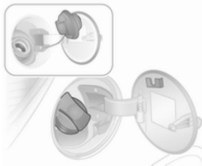
Desbloquee el tapón del depósito con la llave del encendido, desenrosque el tapón y desmóntelo. El tapón del depósito se puede enganchar en el soporte de la tapa del depósito de combustible.
