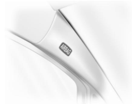
El sistema de airbags de cortina se compone de un airbag en el marco del techo a cada lado. Se pueden identificar por el rótulo **AIRBAG** en los pilares del techo.
