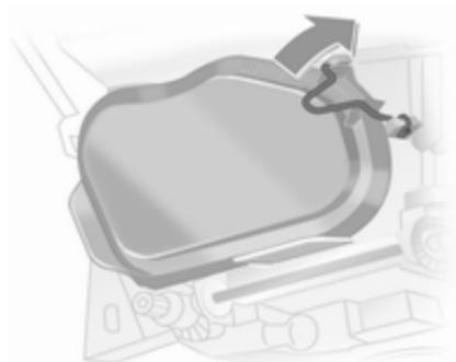
1. Desenclave el clip de alambre y desmonte la tapa protectora 1.
