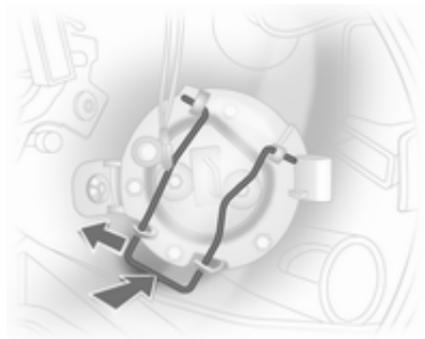
3. Desenclave el clip elástico de la sujeción moviéndolo y girándolo a un lado.
