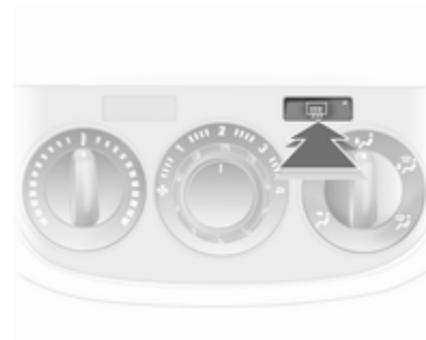
Se conecta pulsando el botón
