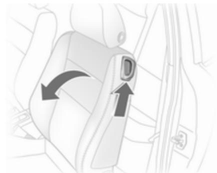
Levante la palanca de desbloqueo e incline el respaldo hacia delante. Baje la palanca de desbloqueo y el respaldo se enclava en posición abatida. Deslice el asiento hacia delante.
