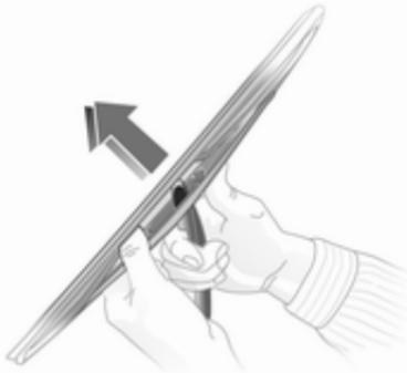
Levante el brazo del limpiavientos. Desacople la escobilla como se muestra en la ilustración y desmóntela.
