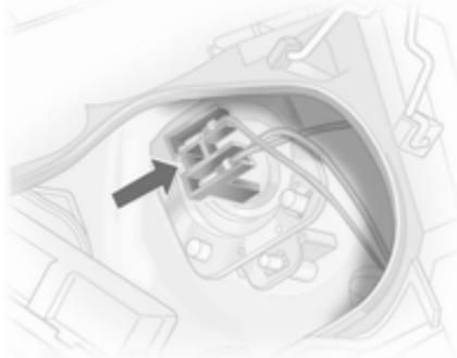
2. Presione la base hacia el lado y desmóntela del reflector.
