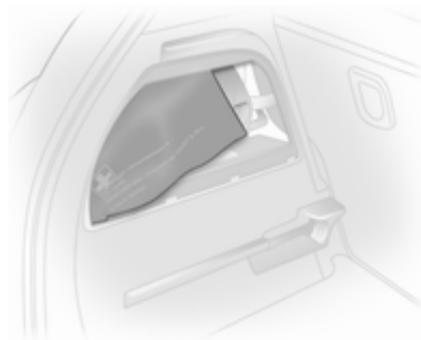
Guarde el botiquín (cojín) en el compartimento que hay en la pared izquierda del compartimento de carga. Para abrir el compartimento, desenchufe la tapa y ábrala.
