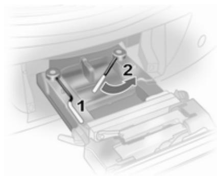
Bascule hacia atrás las palancas tensoras hasta el tope, primero la izquierda (1) y luego la derecha (2). Las dos palancas tensoras deben señalar hacia atrás; en caso contrario, no estará garantizado un funcionamiento seguro.
