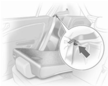
Enderece los respaldos del asiento trasero y deje que los mecanismos de bloqueo enclaven audiblemente en ambos lados. Una vez bloqueados los respaldos, ya no debe sobresalir la marca roja.
