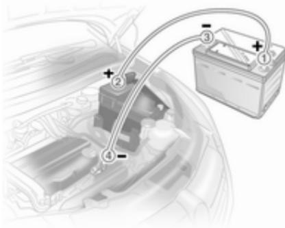
Sitúe los cables de forma que no puedan engancharse en piezas giratorias del compartimento del motor.
