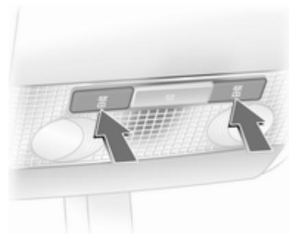
Se accionan mediante los botones
