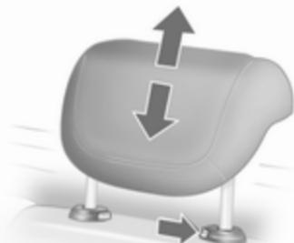
La altura de los reposacabezas puede ajustarse en dos posiciones. Para ajustarlo en la primera posición, tire del reposacabezas hacia arriba; para la segunda posición, pulse el resorte marcado en la ilustración y levante el reposacabezas a tope hasta
