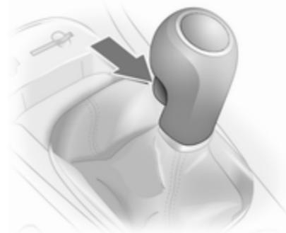
Para engranar la marcha atrás: con el vehículo parado, espere 3 segundos después de pisar el pedal de embrague, apriete el botón de la palanca y engrane la marcha.
