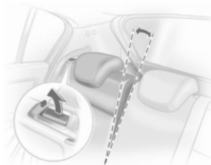
Tire de la manilla de desbloqueo, tire del respaldo hacia delante hasta la vertical y enclávelo.
