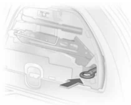
La argolla de remolque se guarda con las herramientas del vehículo ↻ 166. La argolla de remolque está situada en un rebaje.
