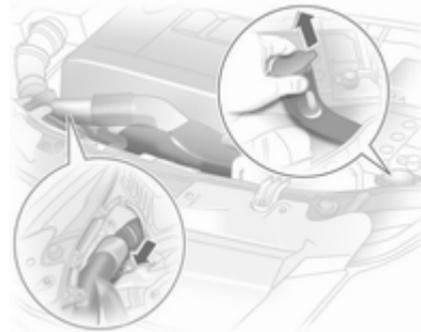
Para sustituir las bombillas en el lado derecho del compartimento del motor, desacople el tubo flexible del filtro de aire.
