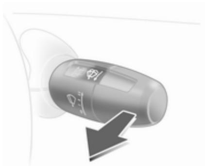
Tire de la palanca. Se pulveriza líquido de lavado sobre el parabrisas y los limpiaparabrisas se accionan varias veces.
