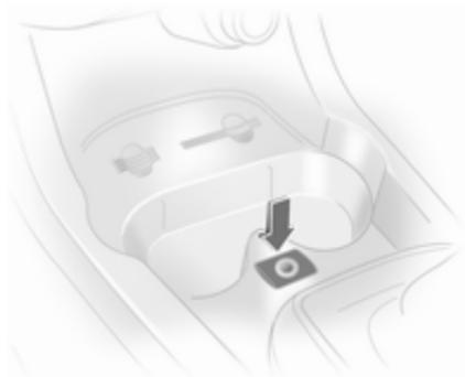
A través de la entrada AUX se puede conectar una fuente de audio externa, como un reproductor portátil de CD, con un conector tipo jack de 3,5 mm.
