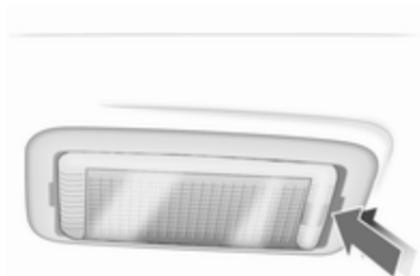
1. Extraiga la lámpara haciendo palanca con un destornillador.
