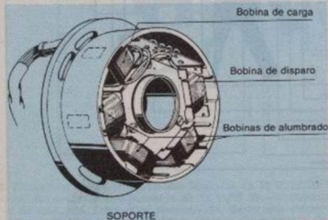
Fig. 16 E.—Estátor, solución FEMSA
