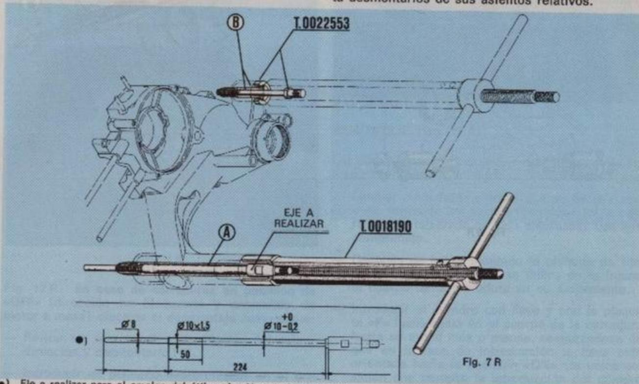
●) Eje a realizar para el empleo del útil en las Vespas PR (75 c.c.).
