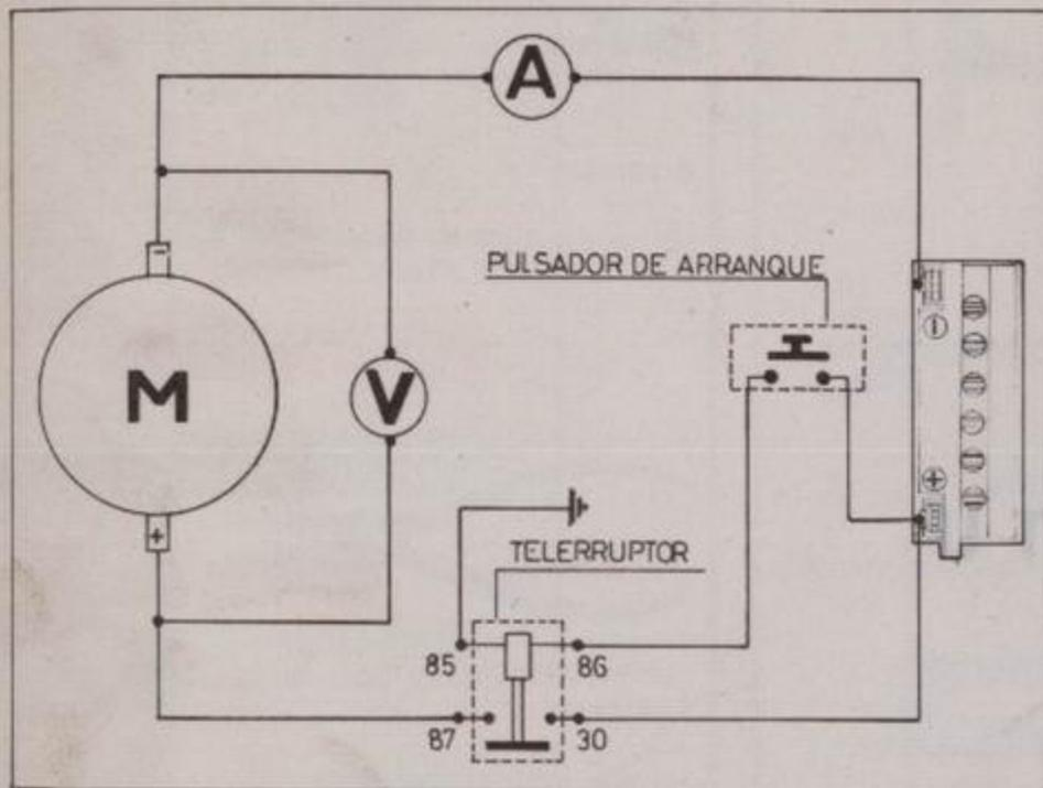
Fig. 33 E.—Pruebas del motor de arranque
