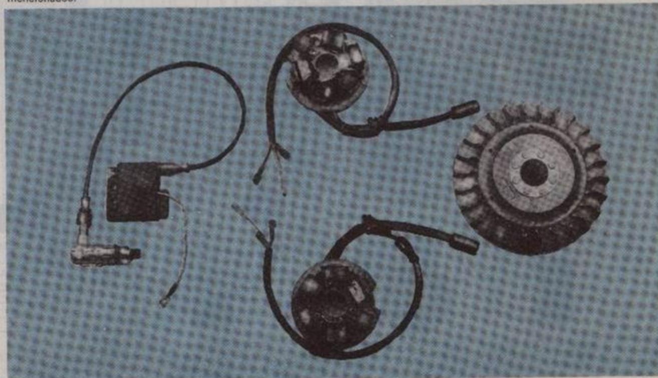
Fig. 18 E.—Componentes del equipo de encendido, solución DUCATI
