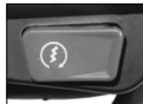
Imagen 3. Interruptor de arranque eléctrico.
