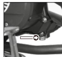
Imagen 16. Ubicación del tornillo de drenado.
