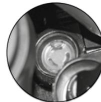
Imagen 22. Nivel del líquido de freno delantero.
