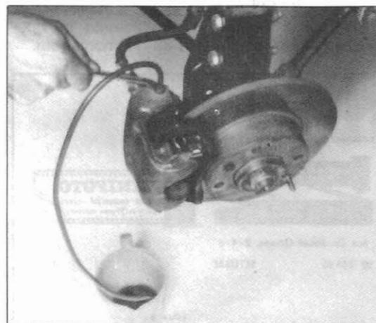
Fig.203 — Purga do circuito dos travões
