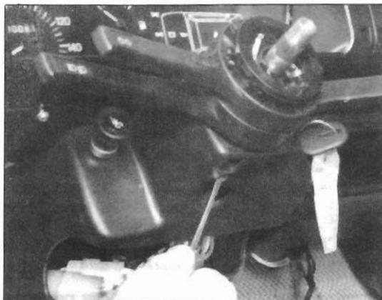
Fig.165 — Desmontagem da guarnição da coluna
