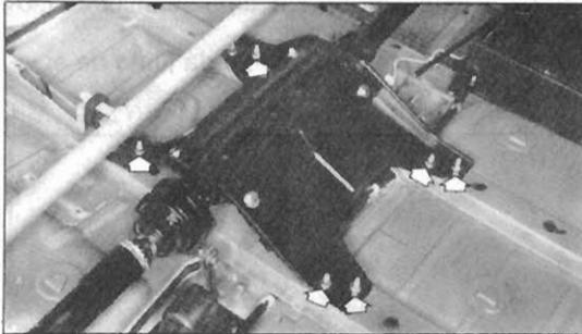
Fig.137 — Porcas de fixação do apoio central
