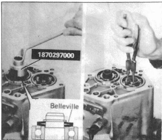
Fig.109 — Montagem da anilha do tipo "Belleville" e dos freios
