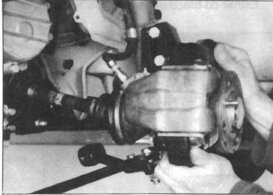
Fig.167 — Desmontagem do elemento da suspensão
