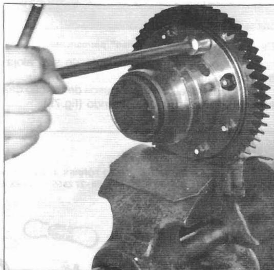
Fig.81 — Desapertar os parafusos da roda de cõrrea
