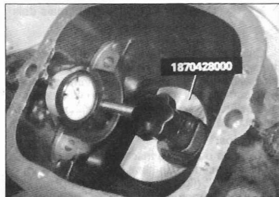
Fig.149 — Montagem do falso pinhão e do comparador
