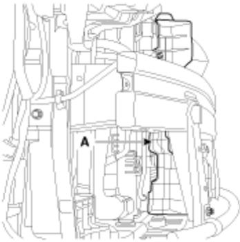
4. Desconecte la línea de descarga (A) y la línea de líquido (B) desde el condensador.
