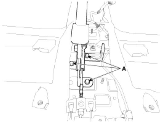
4. Aplicar un recubrimiento de la grasa especificada para cada uno partes deslizantes (A) de la placa de trinquete o el trinquete de trinquete.
