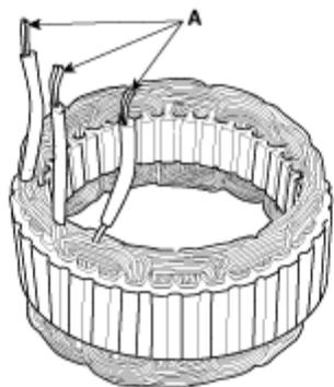
5. Compruebe que no hay continuidad entre cada hilo conductor y el núcleo de la bobina.
