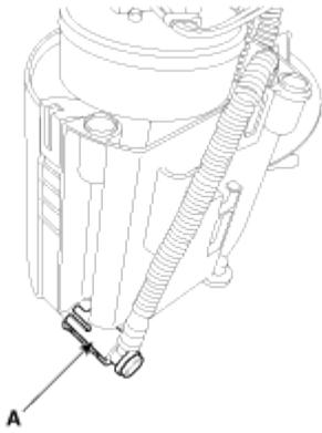
6. Retire la válvula de corte (A) después de la liberación de los ganchos (B).
