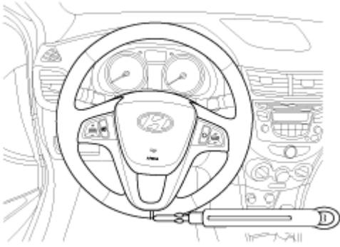
3. Si el valor medido excede el valor normal, inspeccionar la caja de cambios y el sistema de dirección asistida MDPS.
